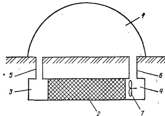
Рис. 49. Пленочная теплица с грунтовым аккумулятором теплоты:
