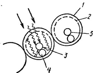
Рис. 38. Вакуумированный стеклянный трубчатый коллектор (в разрезе):
