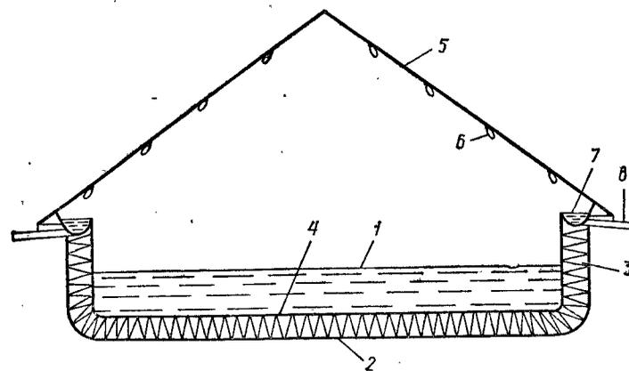
Рис. 63. Солнечный опреснитель (дистиллятор) бассейнового типа: 1 — минерализованная вода; 2 — бассейн; 3 — теплоизоляция; 4 — гидроизоляция; 5 — стеклянная крыша; 6 — конденсат; 7 — приемный желоб; 8 — трубка для дистиллята
