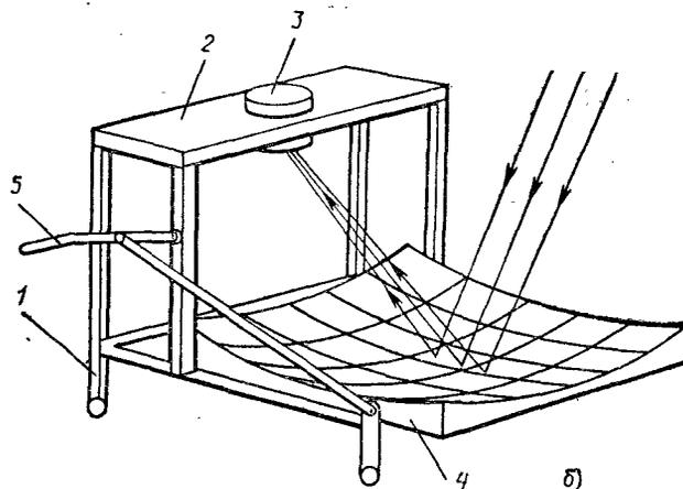
Рис. 62. Плита с параболическим концентратором:
