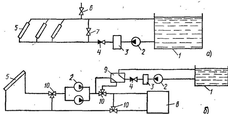
Рис. 47. Схемы солнечных установок для обогрева плавательных бассейнов:
