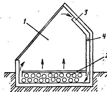
пользованием солнечной энергии показана на рис. 90. Она имеет развитую остекленную поверхность с южной стороны и засыпанную грунтом стенку с северной стороны. Земляная насыпь служит одновременно теплоизоляцией и аккумулятором теплоты. Для циркуляции воздуха в насыпи предусмотрены каналы. Днем происходит нагрев этого слоя земли, а ночью от него теплота отводится воздухом, поступающим в теплицу.
