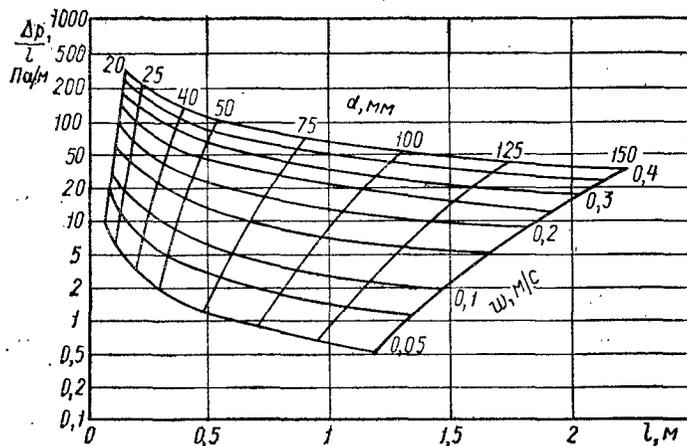
Рис. 71. Номограмма для расчета галечного аккумулятора теплоты
