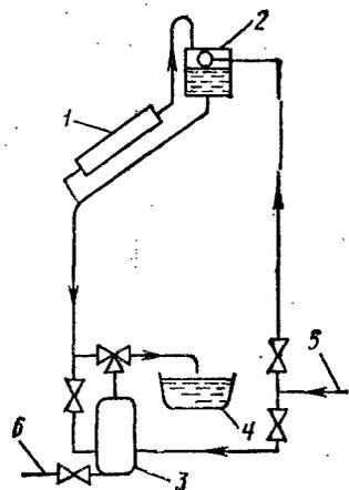
Рис. 89. Объединение гелиоустановки и топливного водонагревателя:
