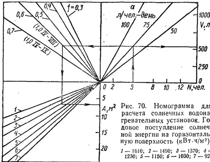
Рис. 70. Номограмма для расчета солнечных водонагревательных установок. Годовое поступление солнечной энергии на горизонтальную поверхность ( $\text{кВт}\cdot\text{ч}/\text{м}^2$ ): 1 — 1610; 2 — 1490; 3 — 1370; 4 — 1230; 5 — 1150; 6 — 1030; 7 — 920
