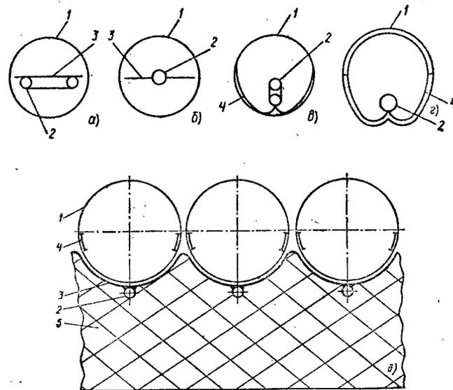
Рис. 17. Поперечное сечение вакуумированных стеклянных трубчатых коллекторов:
