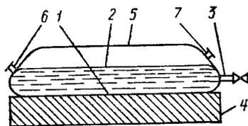
Рис. 88. Пленочный водонагреватель:
