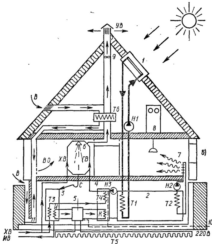
Рис. 37. Внешний вид (а) дома фирмы «Филипс» и его геотехническое и теплоутилизационное оборудование (б):
