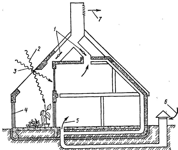
Рис. 42. Солнечный дом с пассивной системой теплохолодоснабжения (в режиме охлаждения):
