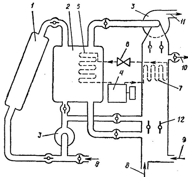
Рис. 44. Схема гелиотеплонасосной системы теплохолодоснабжения (в режиме отопления):
