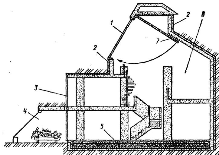
Рис. 34. Солнечный дом с гравийным аккумулятором теплоты:
