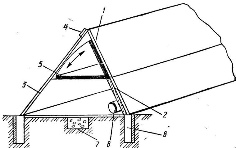
Рис. 92. Гелиотеплица с подвижной теплозащитой:
