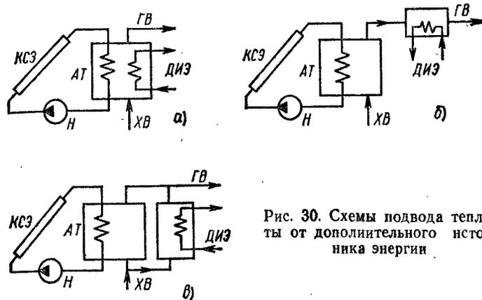
Рис. 30. Схемы подвода теплоты от дополнительного источника энергии
