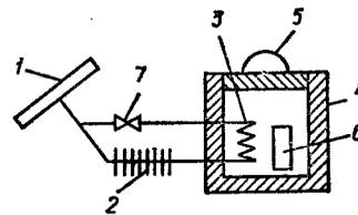
В солнечных водоподъемных установках для привода насоса используются солнечные батареи или тепловые двигатели, работающие по термодинамическому циклу с низкокипящей рабочей жидкостью. Мощность привода зависит от производительности и напора насоса, определяемого глубиной скважины, обычно достаточно 3—15 кВт.
