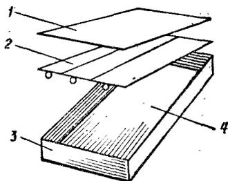
Рис. 8. Конструктивные элементы плоского коллектора солнечной энергии:
