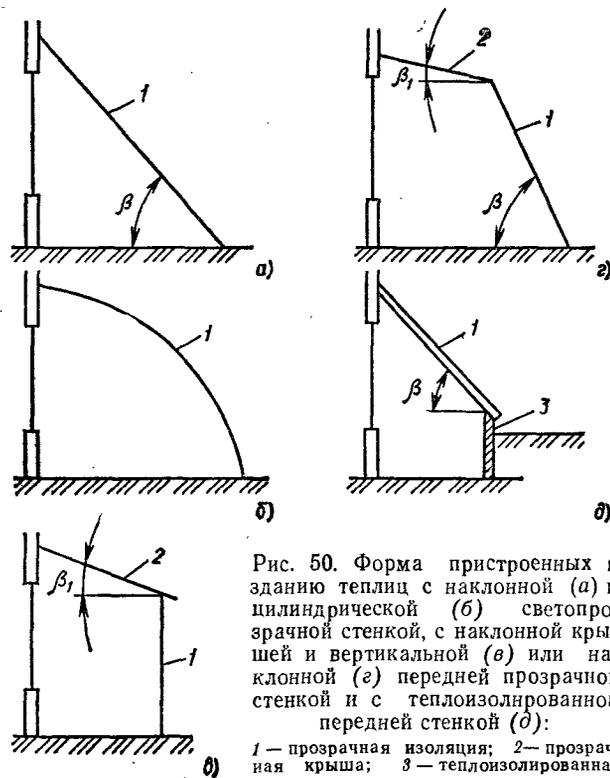
Рис. 50. Форма пристроенных к зданию теплиц с наклонной (а) и цилиндрической (б) светопрозрачной стенкой, с наклонной крышей и вертикальной (в) или наклонной (г) передней прозрачной стенкой и с теплоизолированной передней стенкой (д):
