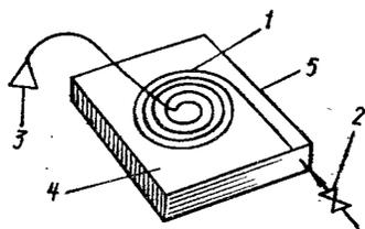
Рис. 87. Простой водонагреватель из черного полиэтиленового шланга:
