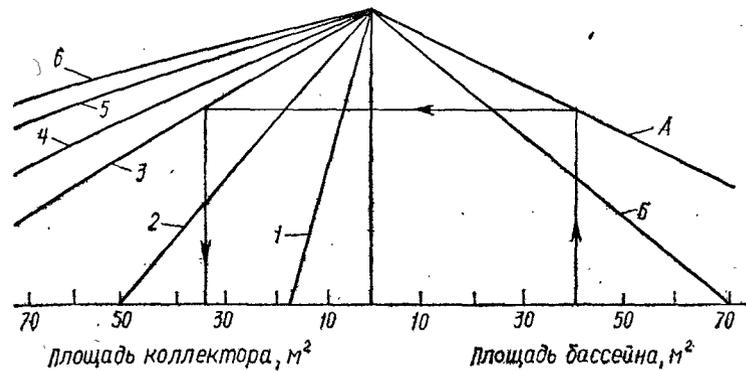
Рис. 72. Номограмма для расчета солнечной установки для плавательного бассейна с покрытием (А) и без покрытия (В); годовое поступление солнечной энергии ( $\text{кВт} \cdot \text{ч}/\text{м}^2$  в год):
