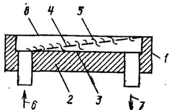
Рис. 85. Воздушный солнечный коллектор матричного типа:
