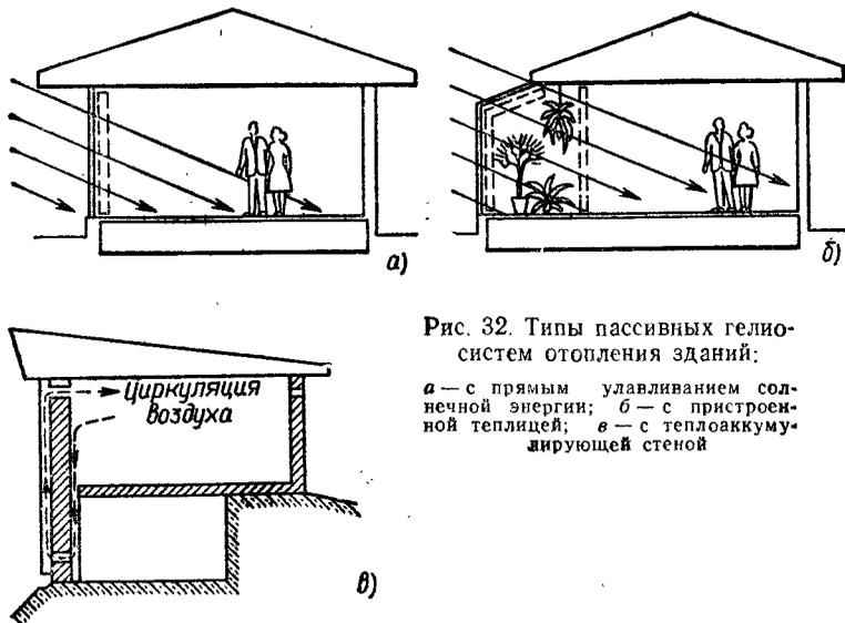
Рис. 32. Типы пассивных гелиосистем отопления зданий:
