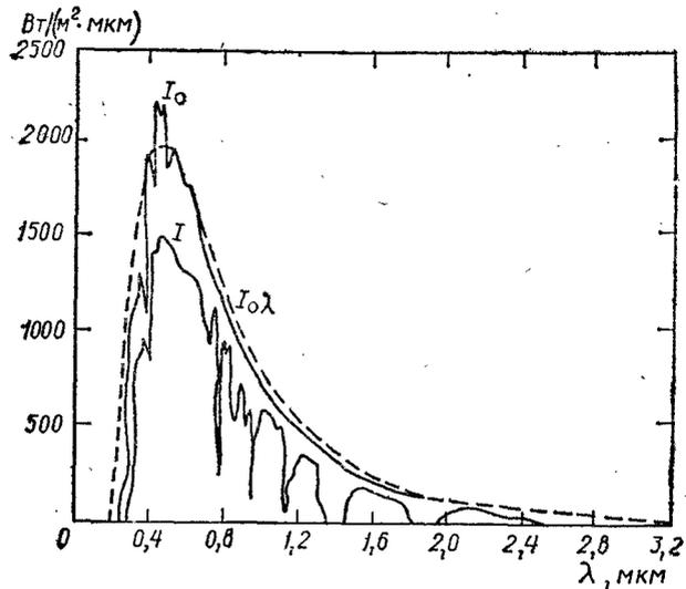
Рис. 2. Интенсивность прямого солнечного излучения выше атмосферы Земли ( $I_0$ ), на уровне моря ( $I$ ) и излучения абсолютно черного тела при температуре 5900 К ( $I_0\lambda$ ) в зависимости от длины волны  $\lambda$ .
