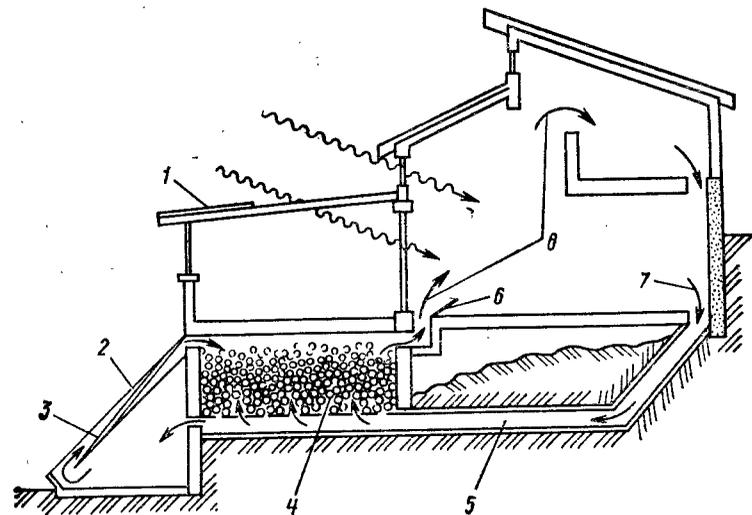
Рис. 33. Солнечный дом с прямым улавливанием солнечной энергии, конвективным контуром для нагрева воздуха и аккумулярованием теплоты в слое камней:
