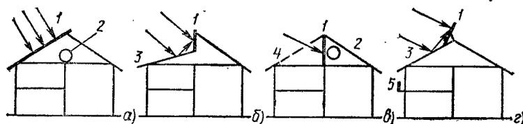
Рис. 80. Варианты размещения солнечного коллектора на крыше:
