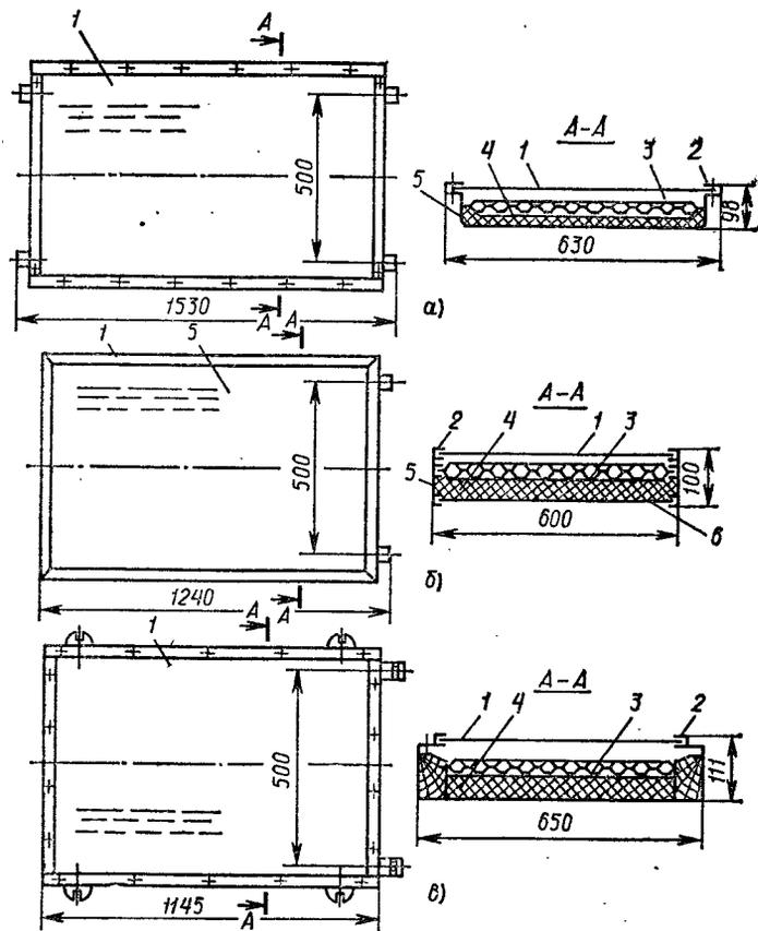
Рис. 14. Жидкостные солнечные коллекторы Братского завода отопительного оборудования (а), КиевЗНИИЭП, ПО «Спецгелиотепломонтаж» (б) и ФТИ АН УзССР (в):
