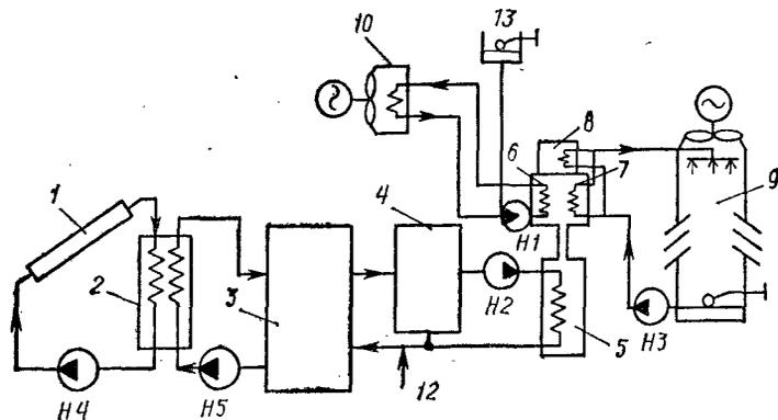
Рис. 46. Схема бромисто-литиевой гелиосистемы кондиционирования воздуха:
