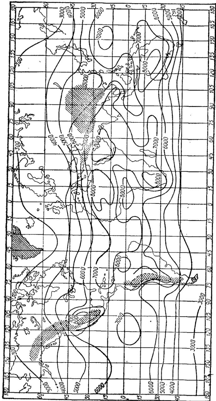
Рис. 1. Годовой приход солнечной радиации на горизонтальную поверхность в различных районах земного шара (МДж/м<sup>2</sup> в год)
