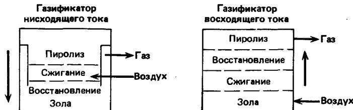
Рис. 12. Газификация способом нисходящего и восходящего токов.
