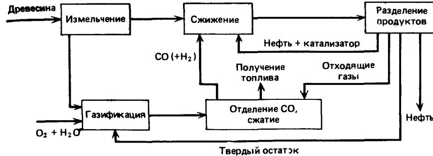
Рис. 13. Сжижение древесины.
