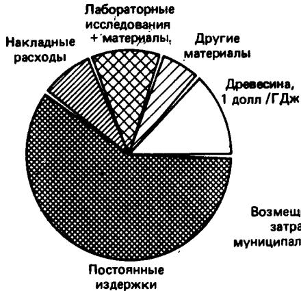
Рис. 21. Стоимость производства метанола из древесины.
