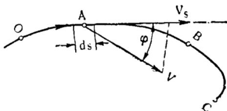
Рис. 7. Циркуляция скорости по контуру.
