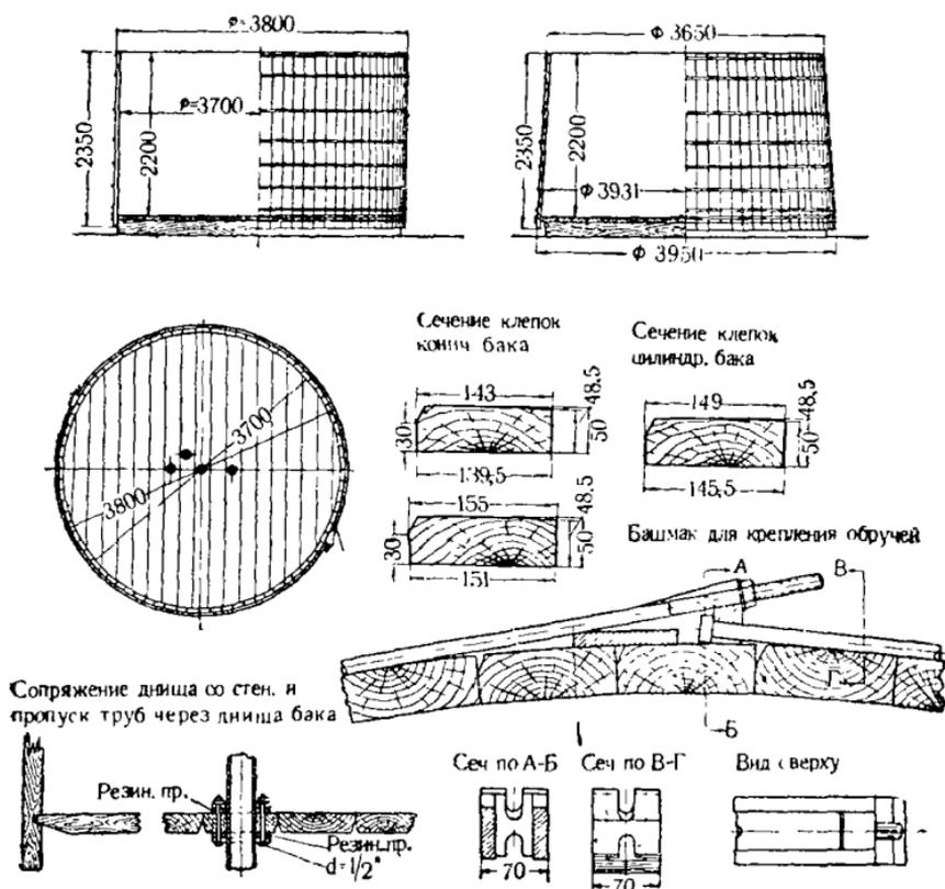
Рис. 262. Деревянные баки цилиндрический и конический.
