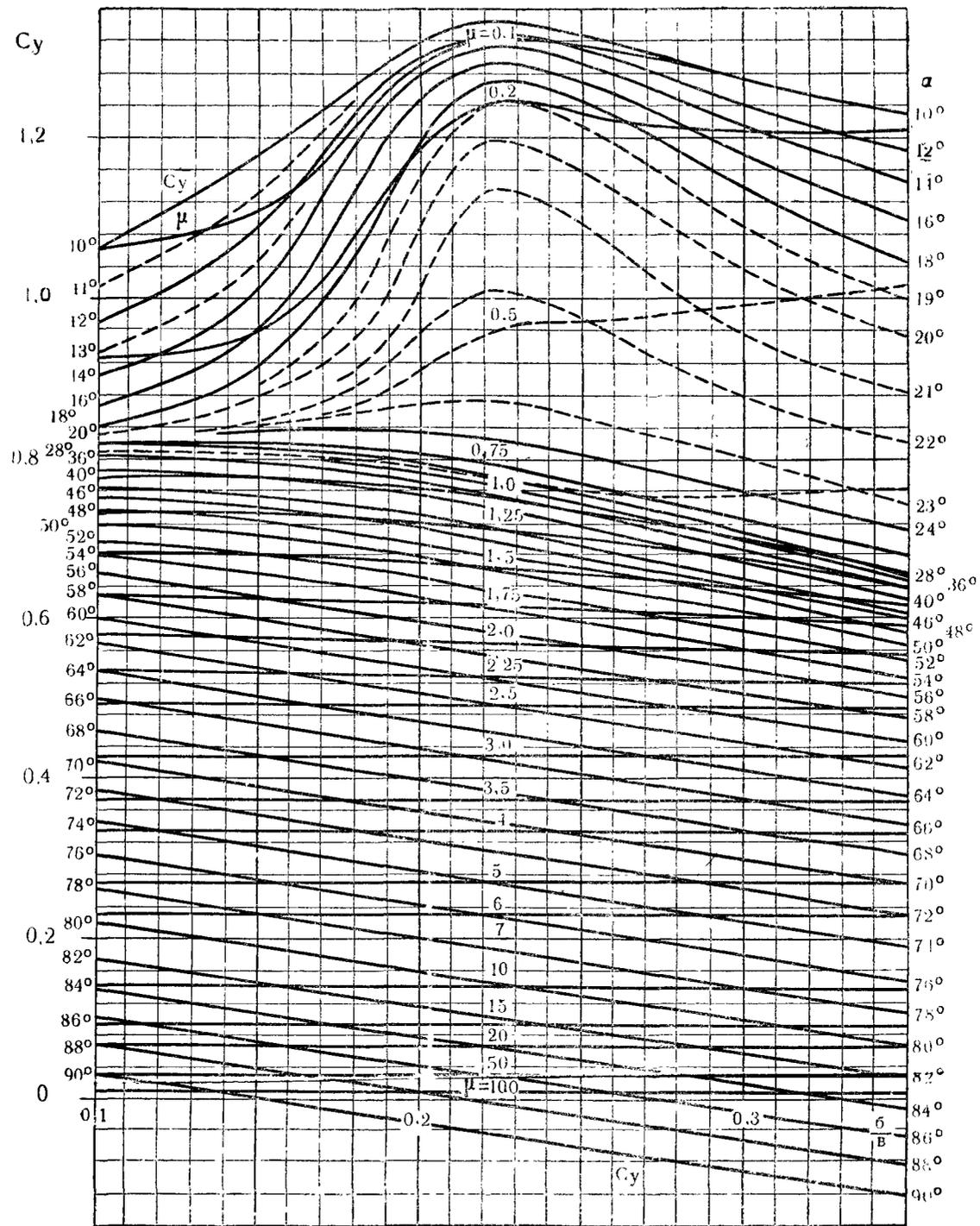
Рис. 64. График для определения  $C_y$  и  $\mu$  крыльев бесконечного размаха с профилем «Эсперри» в зависимости от  $\alpha$  — 10 до 90°.
