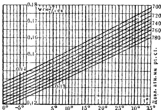
Рис. 17. График для определения коэффициента кинематической вязкости воздуха.
