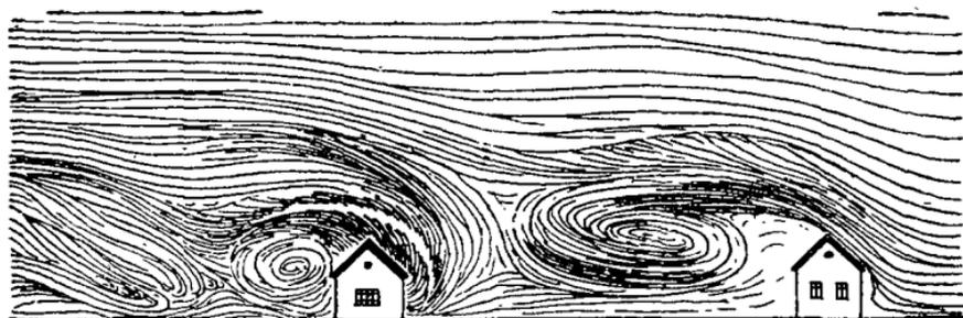
Рис. 206. Аэродинамический спектр вокруг моделей домов.
