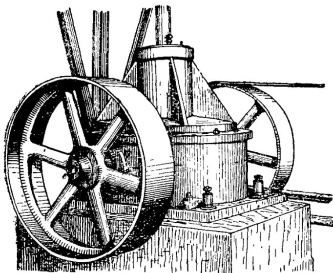
Рис. 152. Редуктор к ветродвигателю Д-18.
