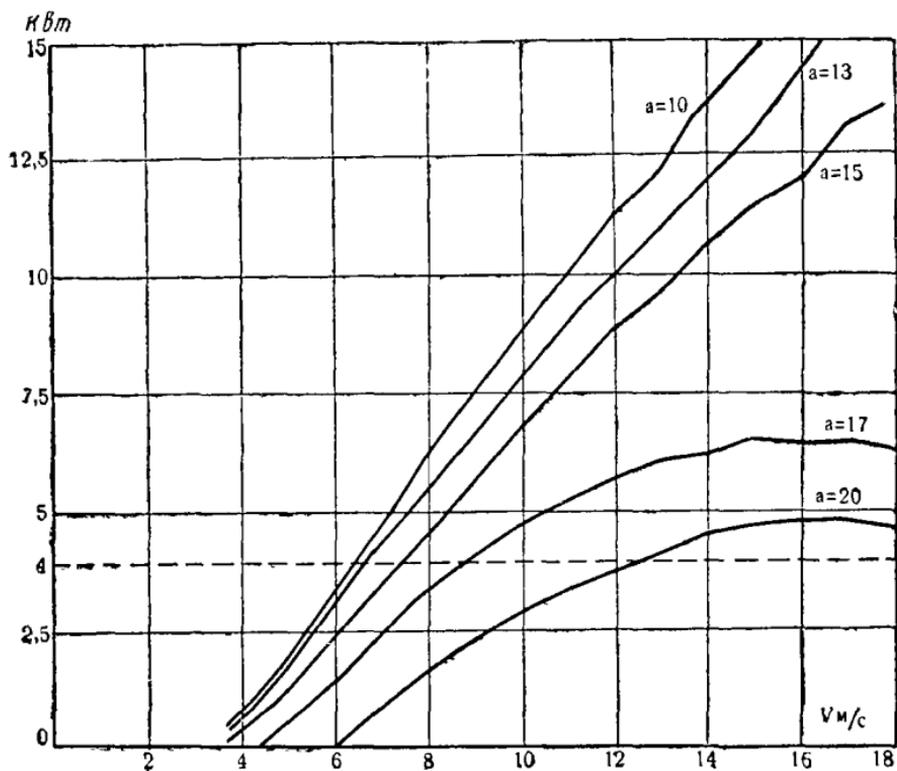
Рис. 318. Изменение мощности ветроколеса при различных  $a$  положения муфты в зависимости от скорости ветра.
