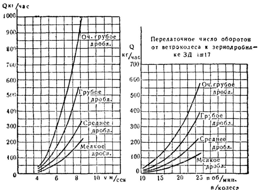
Рис. 249. Характеристика производительности зернодробилки в зависимости от скорости ветра и оборотов ветроколеса.
