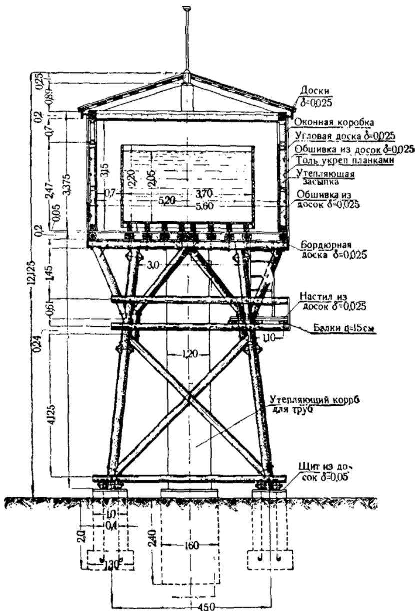
Рис. 261. Водонапорная башня конструкции ВМЭ.
