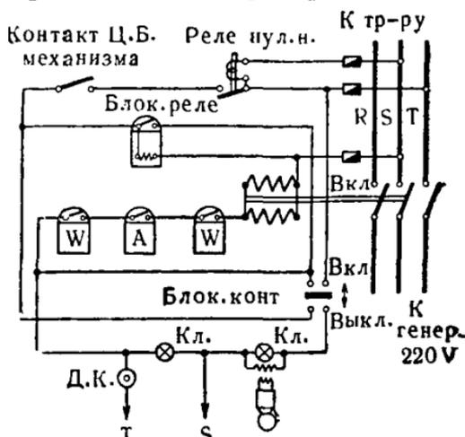
Рис. 324. Принципиальная схема автоматического включения и защиты генератора.
