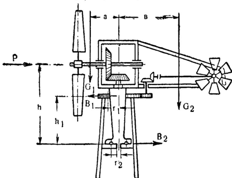
Рис. 183. Схема головки для определения сил трения.
