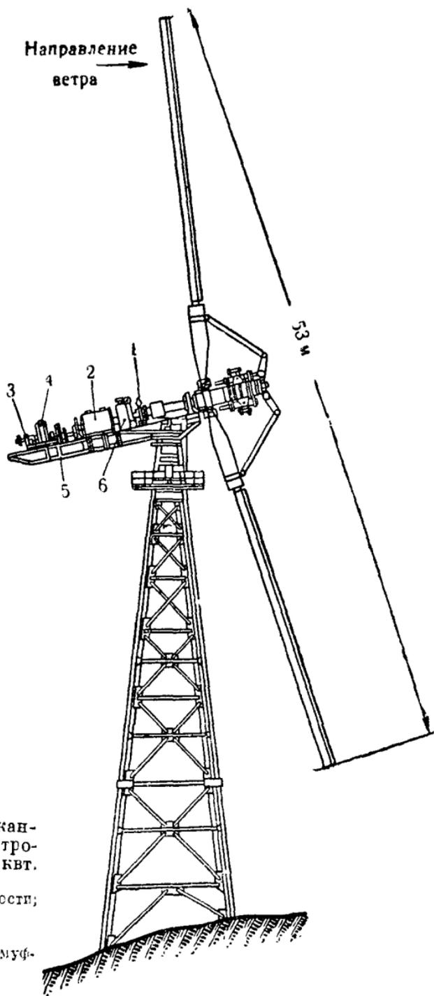
Рис. 336. Американская ветроэлектростанция на 1 000 квт.
