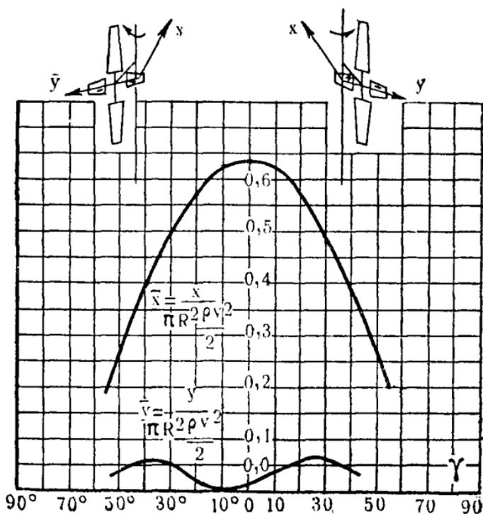
Рис. 102. Кривые коэффициентов  $\bar{Y}$  и  $\bar{X}$  аэродинамических сил модели 4-лопастного ветряка «Сюр» без хвоста с нагрузкой в зависимости от угла поворота ветряка от нормального положения к ветру;  $n = 1860$  об/мин.,  $Z_n = 5$ .
