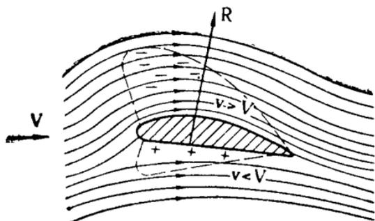
Рис. 31а. Распределение давлений над и под крылом.
