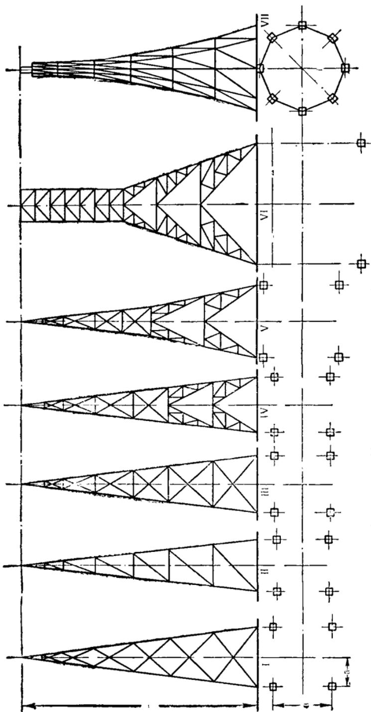
Рис. 187. Конструктивные схемы башен типа А.
