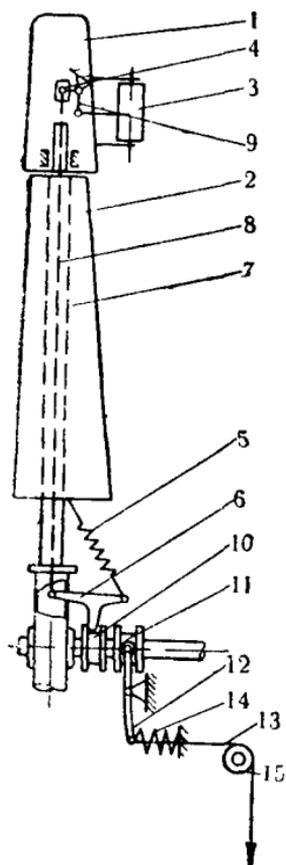
Рис. 132. Схема стабилизаторного регулирования поворотом конца лопасти:
