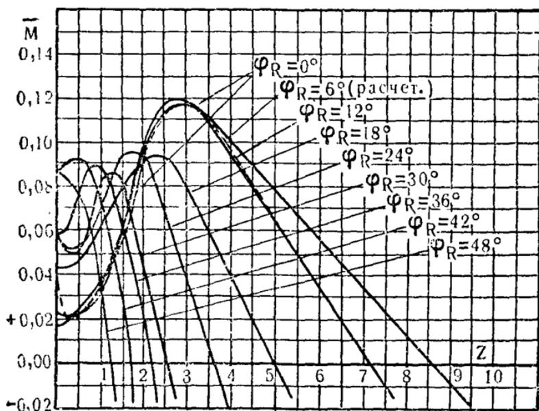
Рис. 97. Характеристики ветроколеса  $D=8$  м,  $Z_n=4,5$ ,  $i=3$ , испытанного при разных углах заклинивания лопасти.
