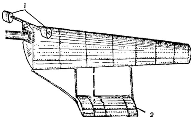
Рис. 131. Крыло со стабилизатором и компенсирующими грузами:
