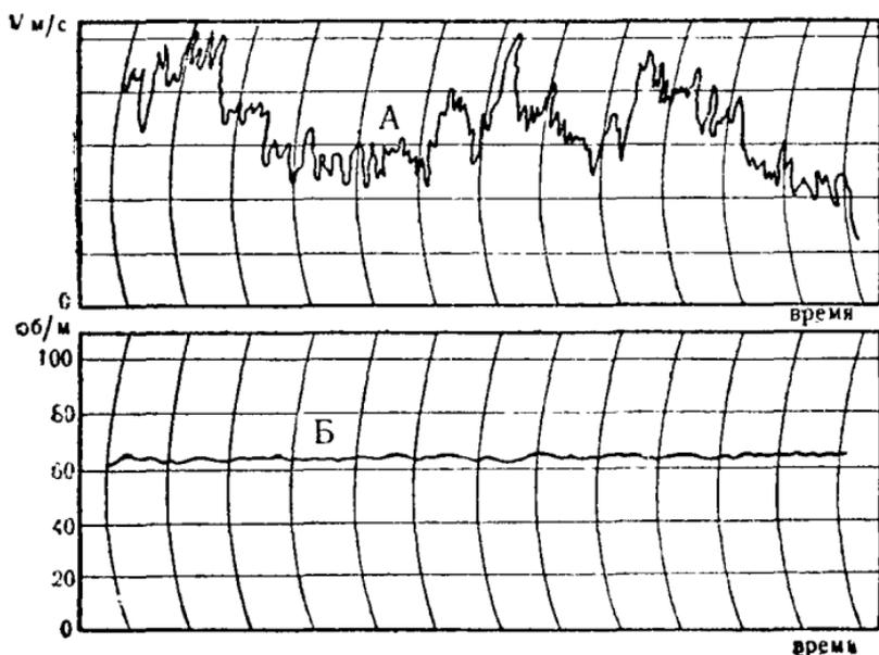
Рис. 133. Характеристика оборотов ветроколеса со стабилизаторным регулированием.
