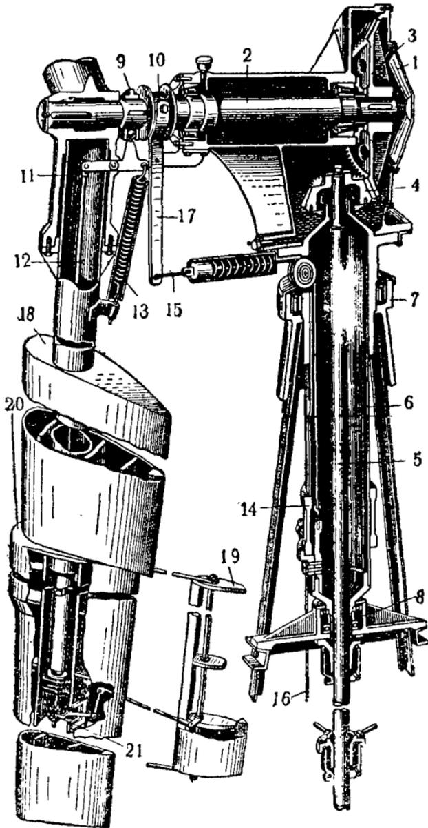
Рис. 143. Головка ветродвигателя ВМЭ Д-12:
