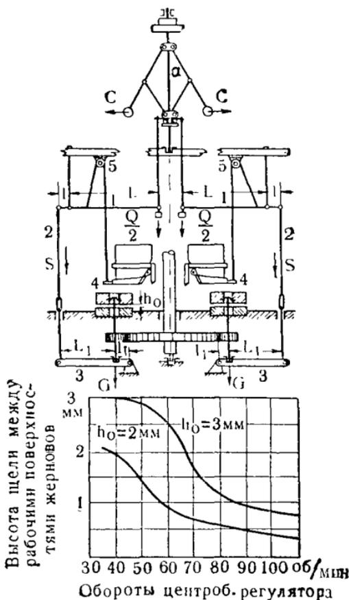
Рис. 246. Схема автоматического регулирования жерновов.
