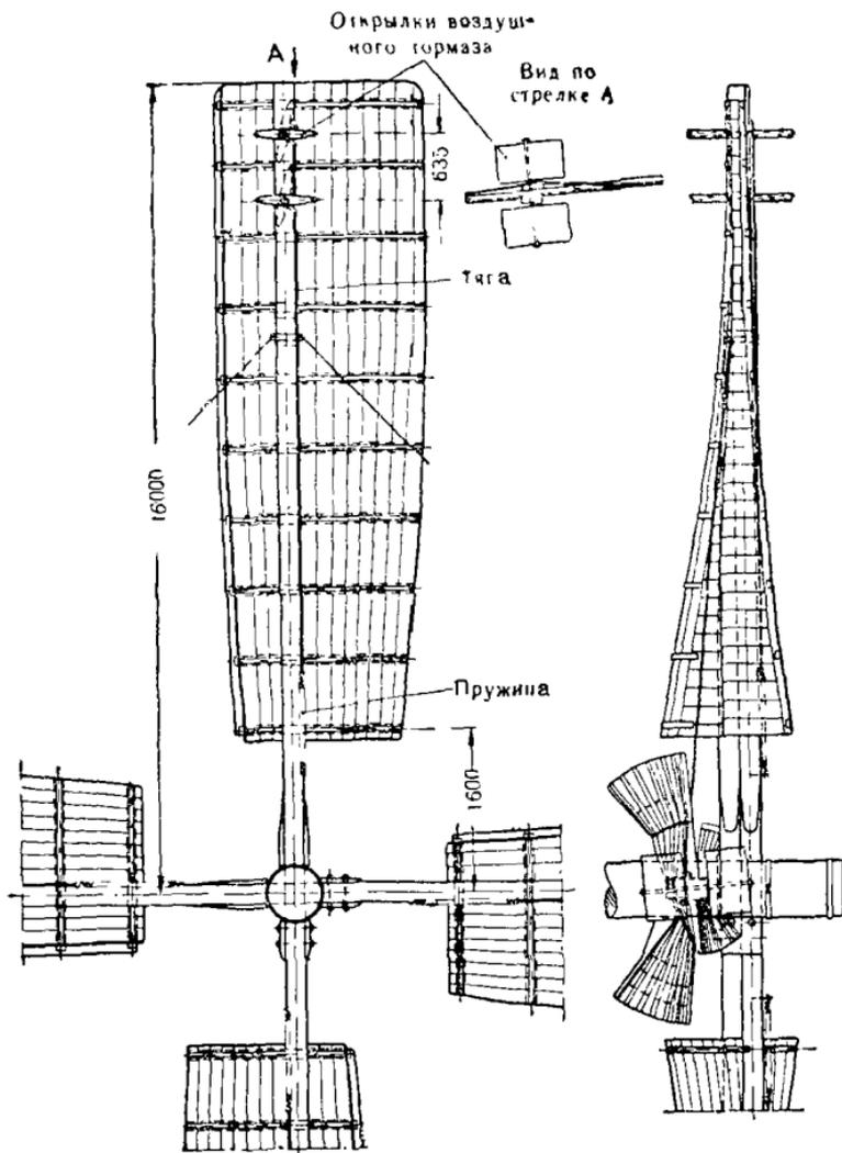
Рис. 297. Крылья с воздушными тормозами ветряной мельницы, показанной на рисунке 296.
