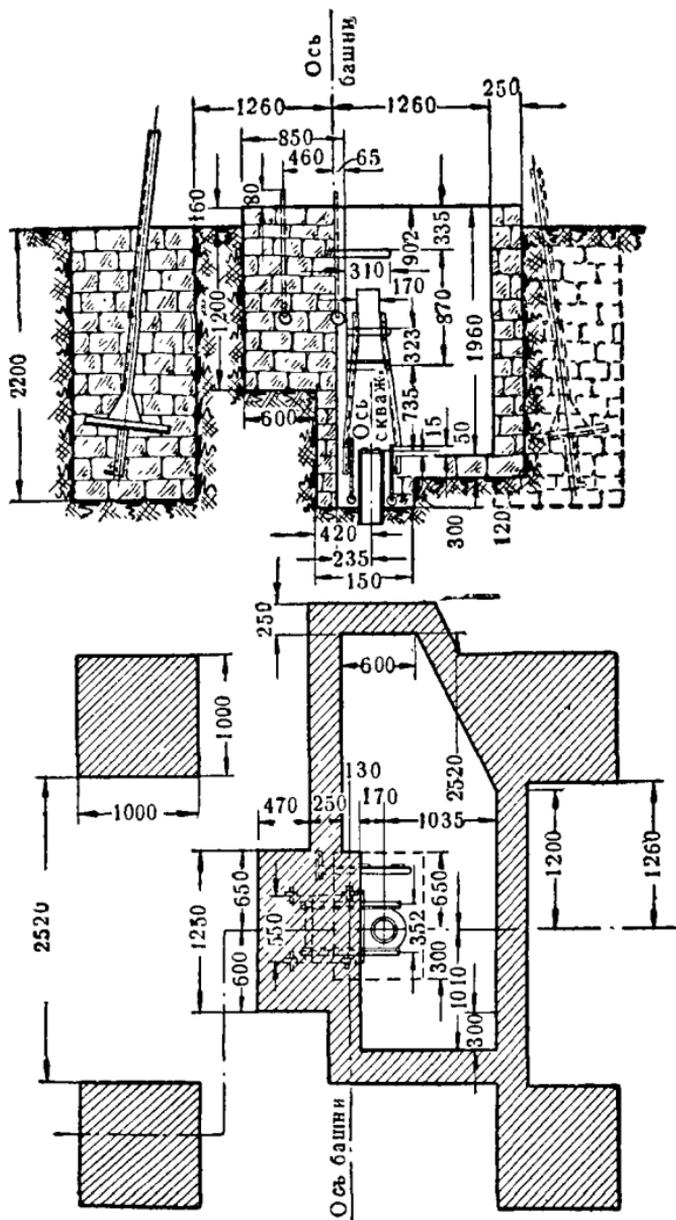
Рис. 340. Фундаменты и шахта насосного оборудования.
