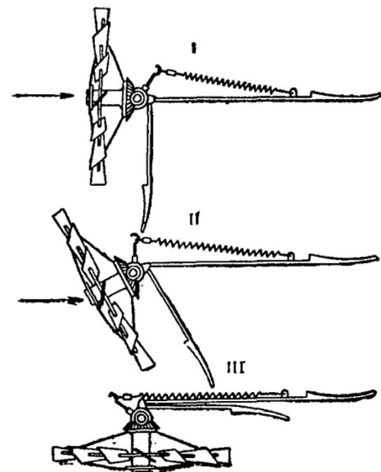
Рис. 117. Схема регулирования выведением ветроколеса из-под ветра с помощью боковой лопасти.
