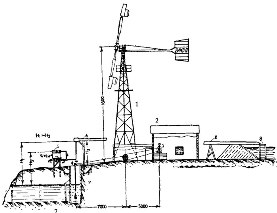
Рис. 274. Конструктивная схема ветрооросительной установки с ветродвигателем ВИМЭ Д-12:
