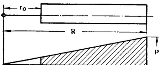
Рис. 172. Нагрузка по длине и хорде лопасти.
