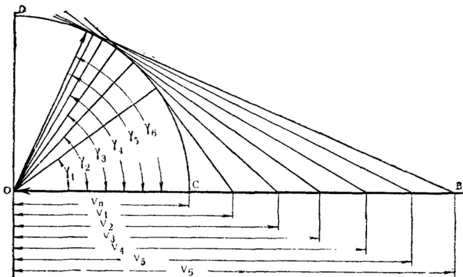
Рис. 126. Графическое определение углов  $\gamma$ .
