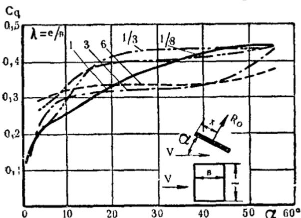
Рис. 106. Кривые центра давления плоских пластинок по Эйфелю.
