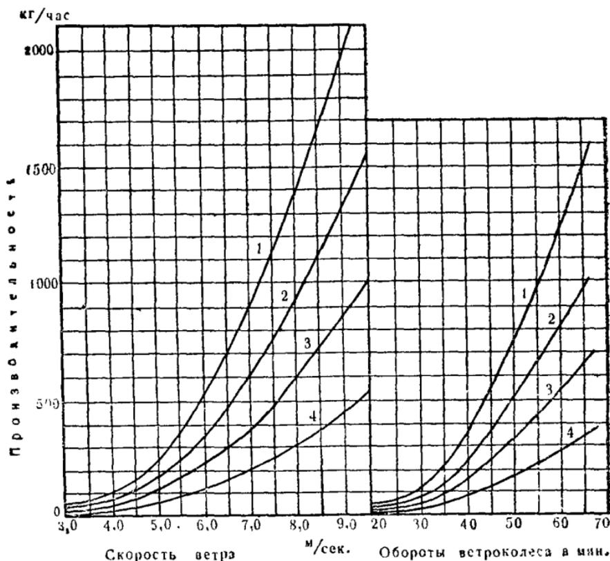
Рис. 251. Характеристики производительности ветродвигателя ВИМЭ Д-12 с фермером при разной тонкости помола в зависимости от скорости ветра:
