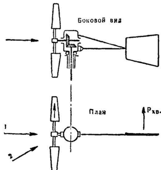
Рис. 98. Схема установка ветроколеса на ветер при помощи хвоста.
