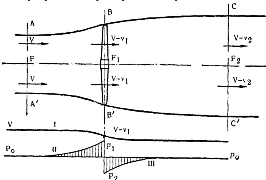
Рис. 50. Характеристика воздушного потока, протекающего через ветроколесо.
