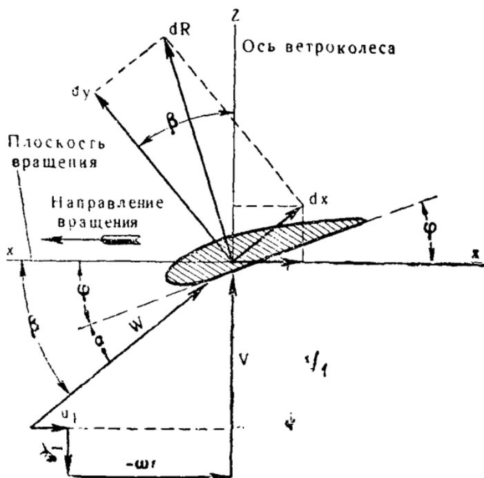
Рис. 57. План скоростей воздушного потока при набегаании его на элемент лопасти.
