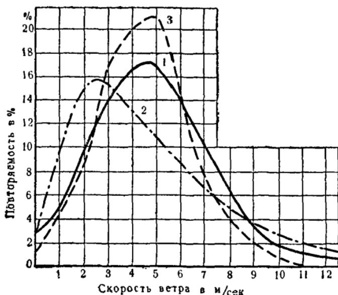
Рис. 210. Сравнение кривых повторяемости по Гуллину и Поморцеву с действительными повторяемостями для Москвы:
