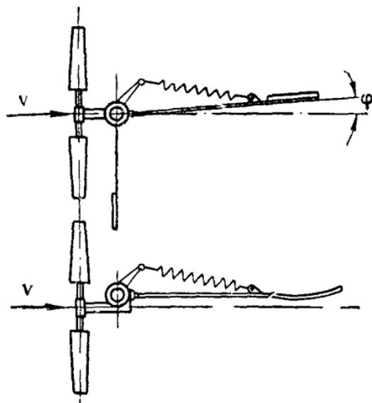
Рис. 111. Перекос хвоста относительно направления ветра с целью компенсации моментов от боковой лопаты и ветроколеса.
