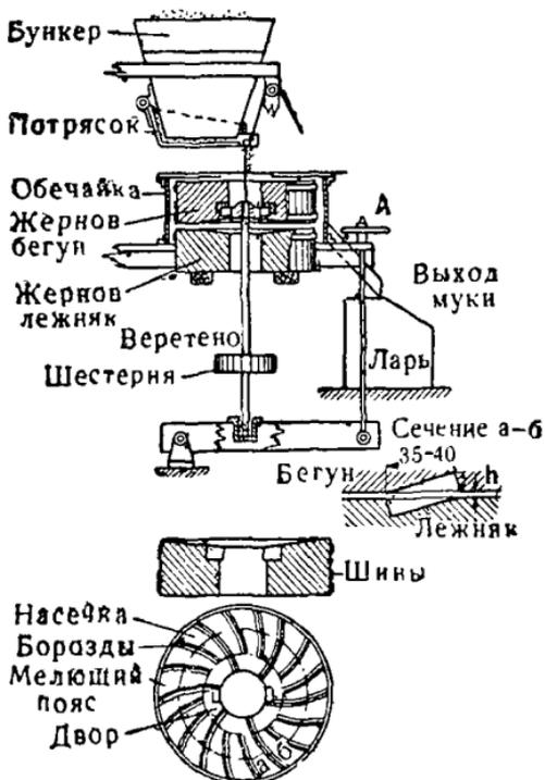
Рис. 245. Жерновой постав, регулируемый вручную.
