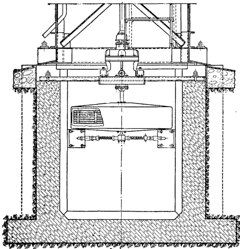
Рис. 155. Инерционный аккумулятор к ветродвигателю ЦАГИ Д-18.
