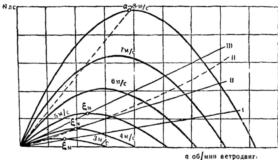
Рис. 219. Совмещённая характеристика ветродвигателя и поршневых насосов разных мощностей.
