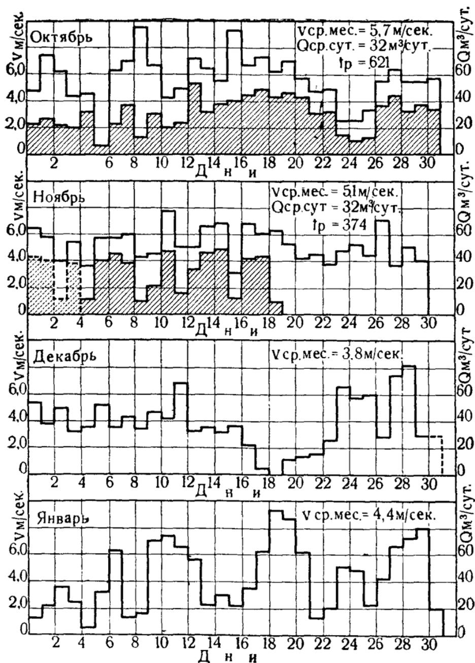
Рис. 269. График годовой работы ветронасосной установки ТВ-5, показанной на рисунке 268.
