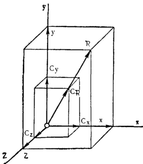
Рис. 24. Разложение коэффициента  $C_R$  по поточным осям координат.
