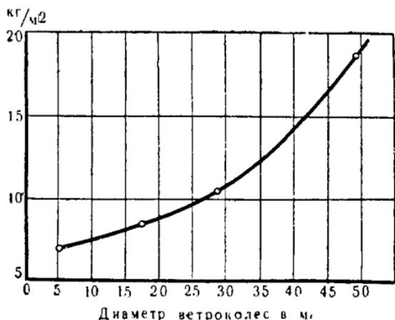
Рис. 169. Характеристика веса ветроколёс на один кв. метр ометаемой площади быстроходных ветродвигателей.
