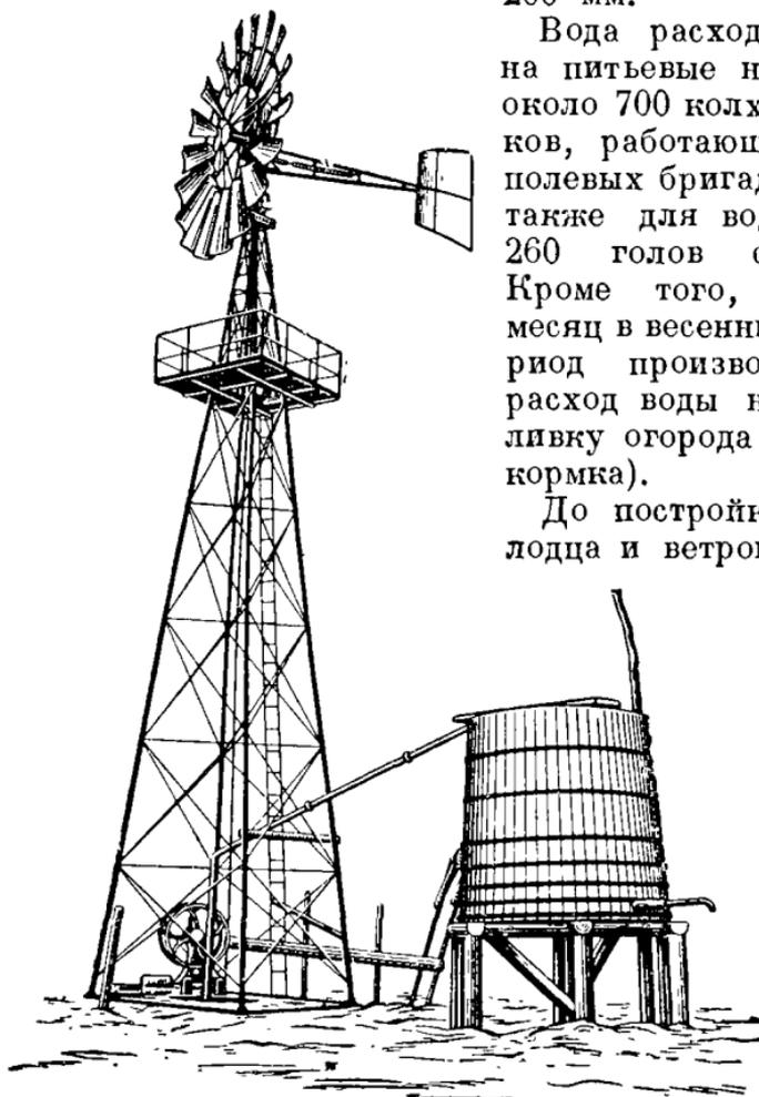
Рис. 268. Ветронасосная установка ТВ-5 в селе Лески, Киевской области.
