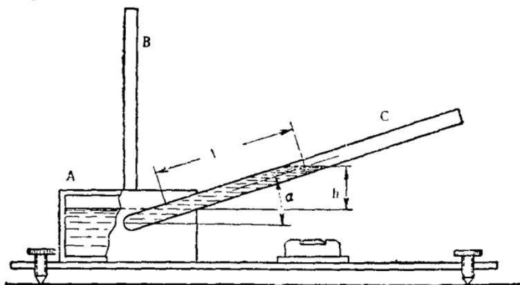
Рис. 205. Схема микроманометра.
