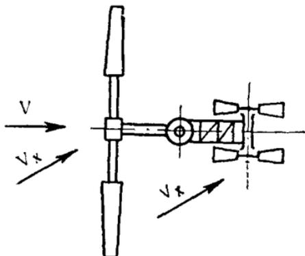
Рис. 114. Схема установка ветроколеса на ветер виндрозами.
