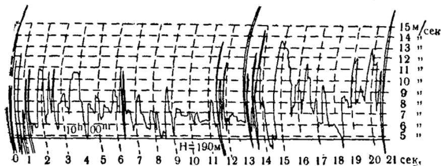
Рис. 213. Анемографическая запись скорости ветра за 20 сек. на высоте 190 м.
