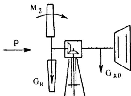
Рис. 182. Нагрузка на головку ветродвигателя.
