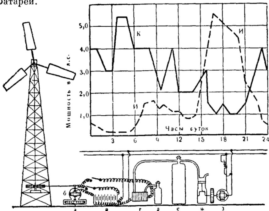
Рис. 215. Схема водородной установки Уфимцева.
