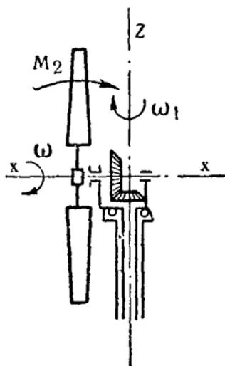
Рис. 112. Схема действия гироскопического момента на ветроколесо.
