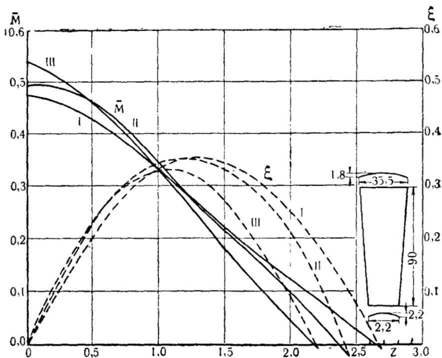
Рис. 74. Аэродинамическая характеристика 18-лопастного ветроколеса.
