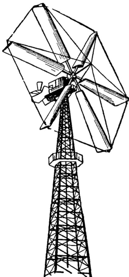
Рис. 330. Ветроэлектростанция на 30 квт с ветродвигателем системы Кумме.
