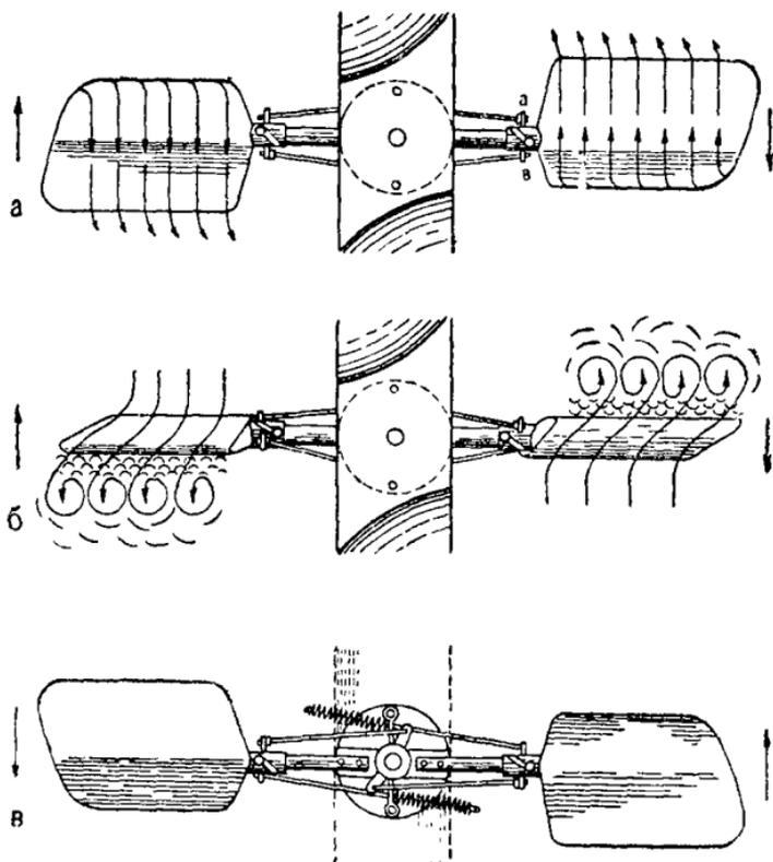
Рис. 335. Регулирование «Винд-Импеллер» изменением положения тормозящих поверхностей ветроколеса:
