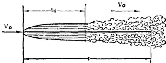
Рис. 20. Переход ламинарного потока в турбулентный.
