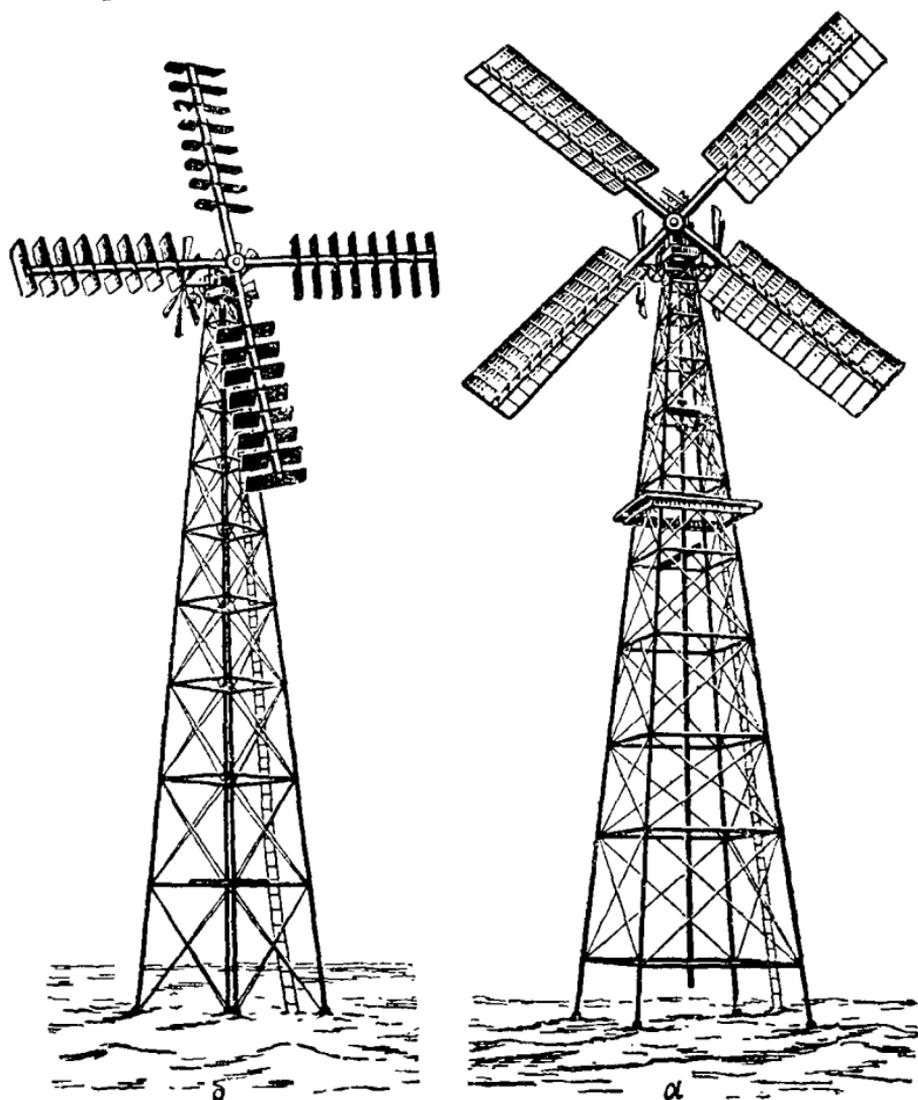
Рис. 128. Ветродвижитель, регулирующий уменьшением поверхности крыльев.
