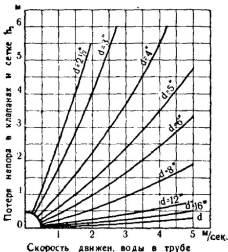
Рис. 223. График для определения потерь в клапанах и сетке.
