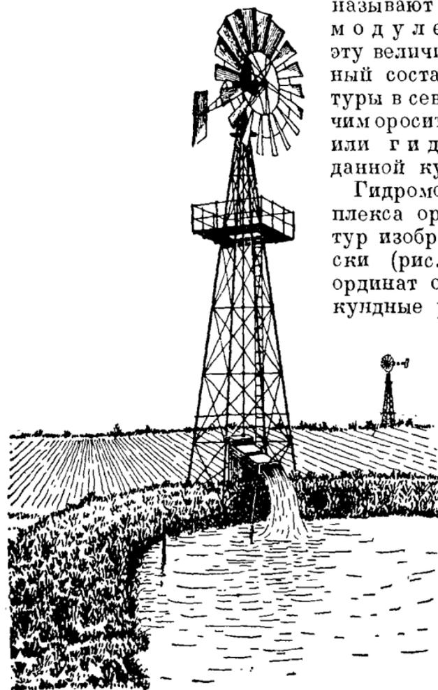
Рис. 273. Маломощная ветрооросительная установка.
