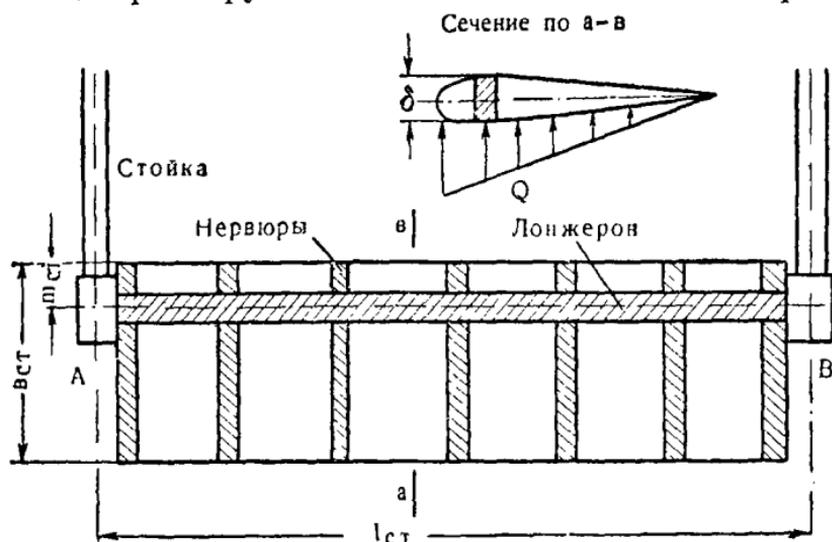
Рис. 177. Нагрузка на стабилизатор.
