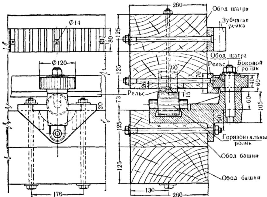
Рис. 292. Роликовая опора шатра ветряной мельницы ВМЭ Д-16.
