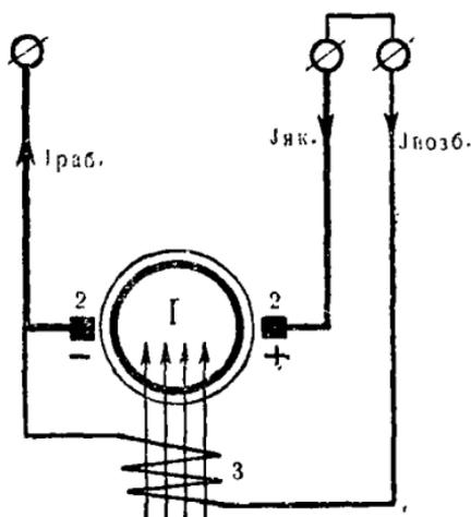
Рис. 302. Схема шунтового генератора постоянного тока:
