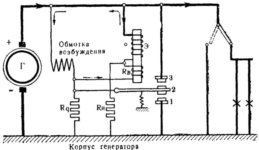
Рис. 308. Регулятор напряжения ВР.
