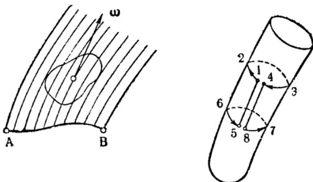
Рис. 12. Замкнутый контур на поверхности вихря и контур на поверхности вихревой трубки.
