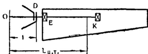
Рис. 174. Схема крыла к расчёту маха при горизонтальном его положении.
