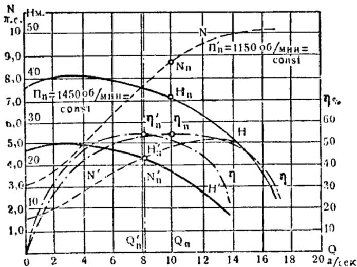
Рис. 230. Характеристики  $H-Q$ ;  $N-Q$ ;  $\eta-Q$  для двух режимов  $n = 1450$  об/мин. и  $n = 1150$  об/мин. центробежного насоса.
