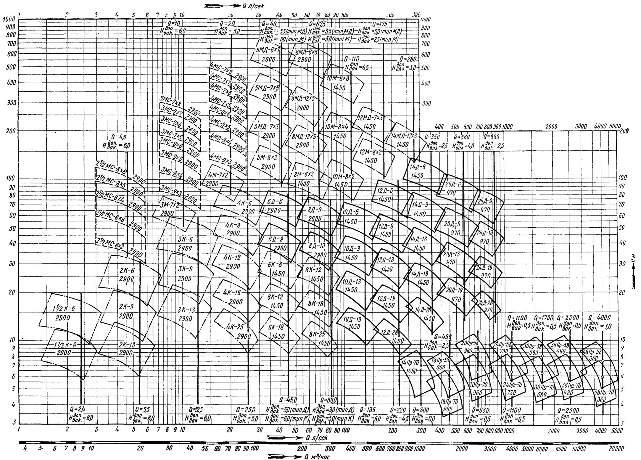
Рис. 239а. Графики для определения характеристик центробежных насосов типа «К», «Д», «М», «МД» и «Пр».
