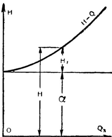
Рис. 225. Характеристика трубопровода.
