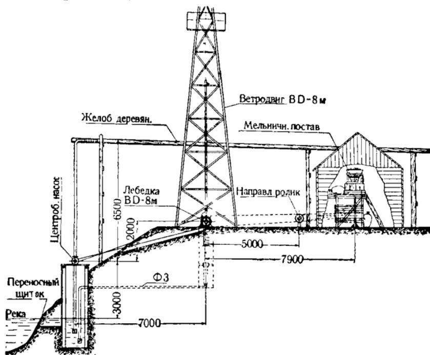
Рис. 276. Конструктивная схема ветроустановки, показанной на рисунке 275.
