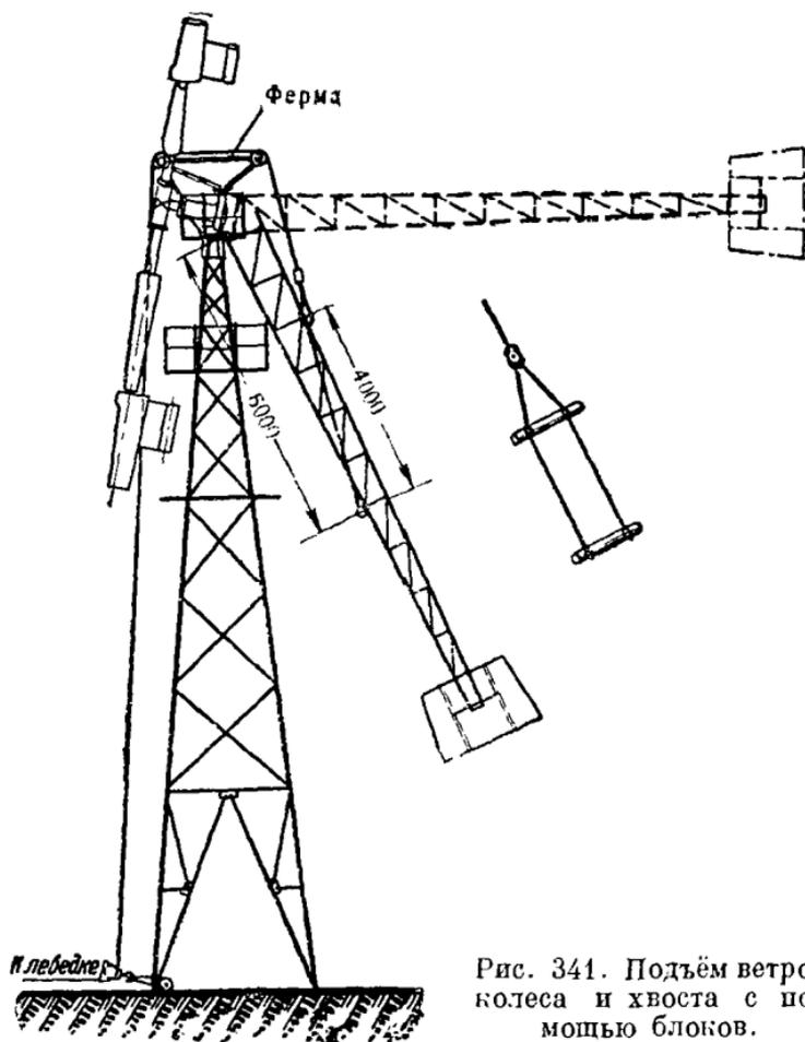
Рис. 341. Подъём ветроколеса и хвоста с помощью блоков.
