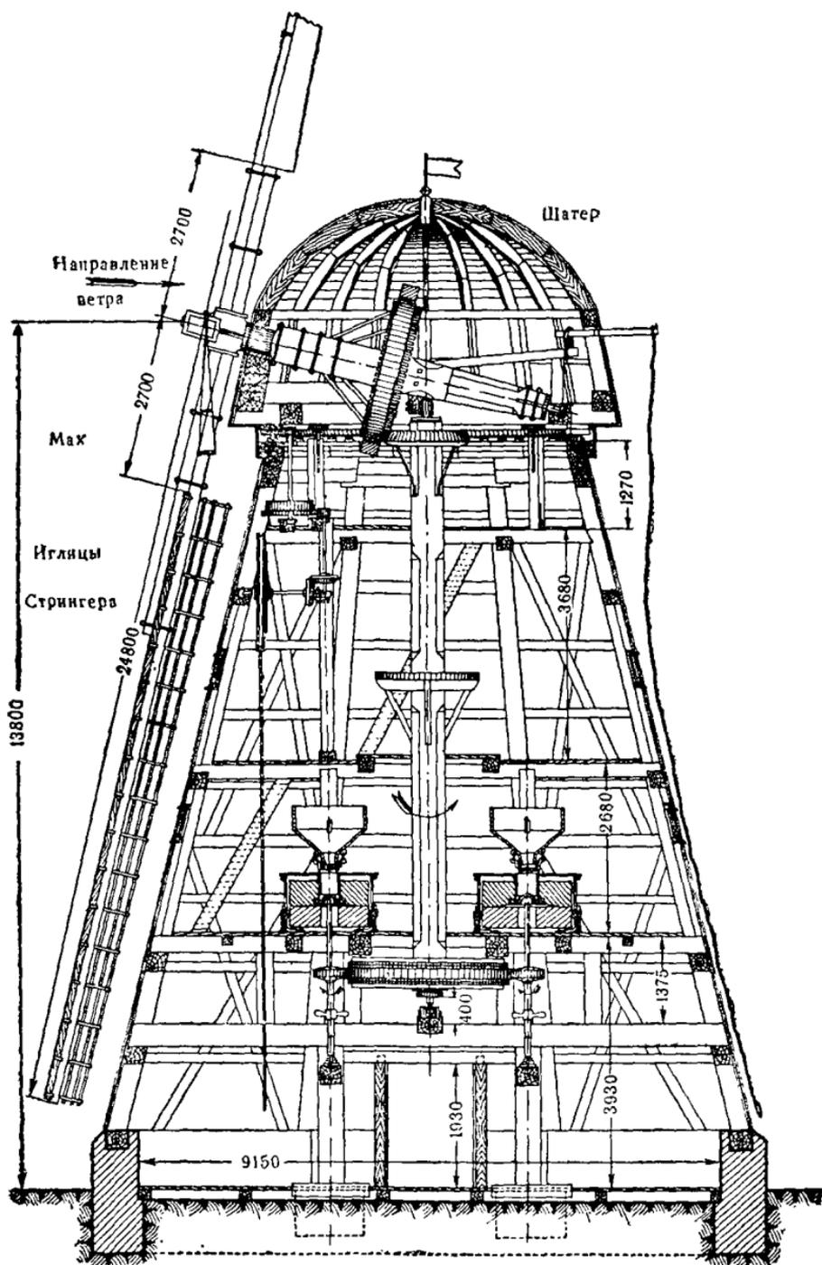
Рис. 278. Разрез шатровой ветряной мельницы.
