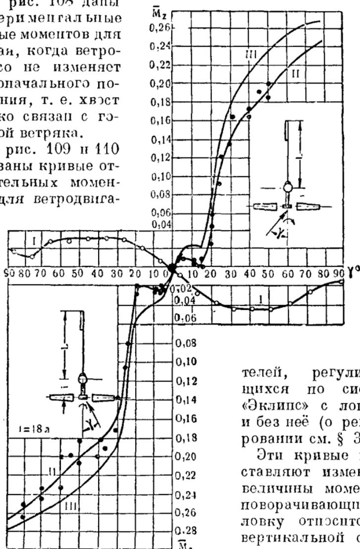
Рис. 108. Кривые моментов сил, действующих на систему ветряка при изменениях направления ветра.
