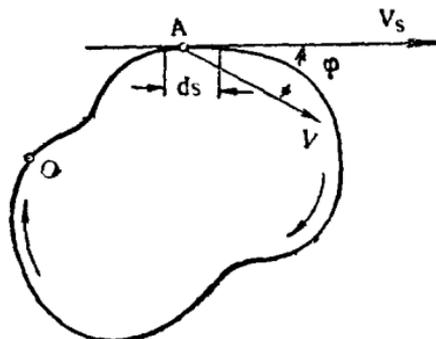
Рис. 8. Циркуляция скорости по замкнутому контуру.
