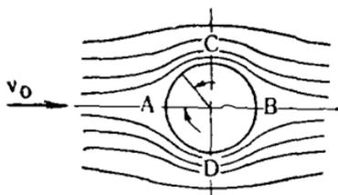
Рис. 45. Схема набегающего воздушного потока на цилиндр, находящийся в покое.
