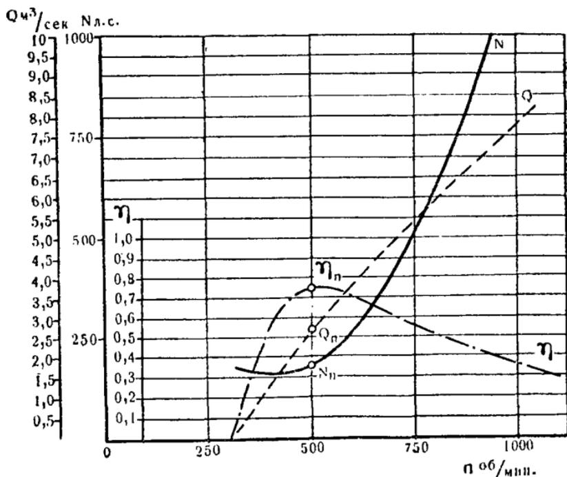
Рис. 236. Размерная характеристика пропеллерного насоса  $N=183$  л. с.;  $n=500$  об/мин.
