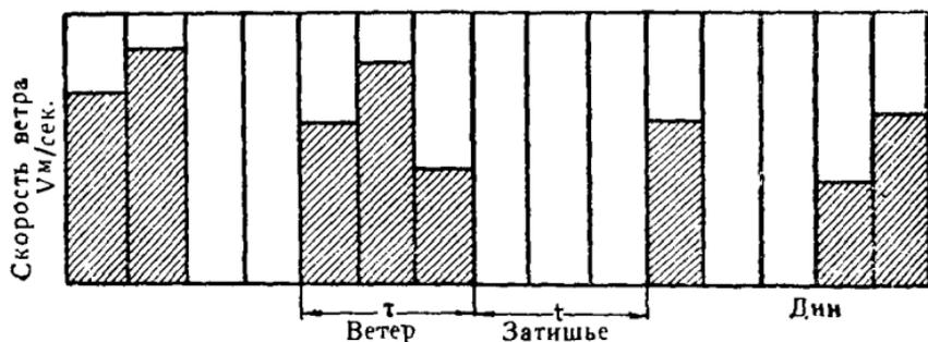
Рис. 257. График возможного колебания среднесуточных скоростей ветра.
