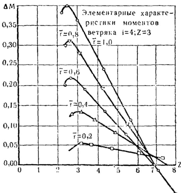
Рис. 60. Характеристика отвлечённых моментов каждого сечения крыла.
