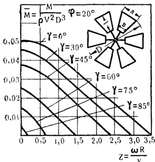
Рис. 115. Характеристика крутящих моментов виндроз для разных углов направления ветра к плоскости вращения.
