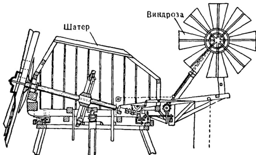
Рис. 279. Виндрозы для установка ветряной мельницы на ветер.
