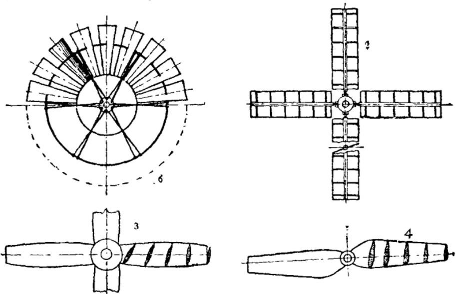
Рис. 37. Схемы ветроколёс крыльчатых ветродвигателей:
