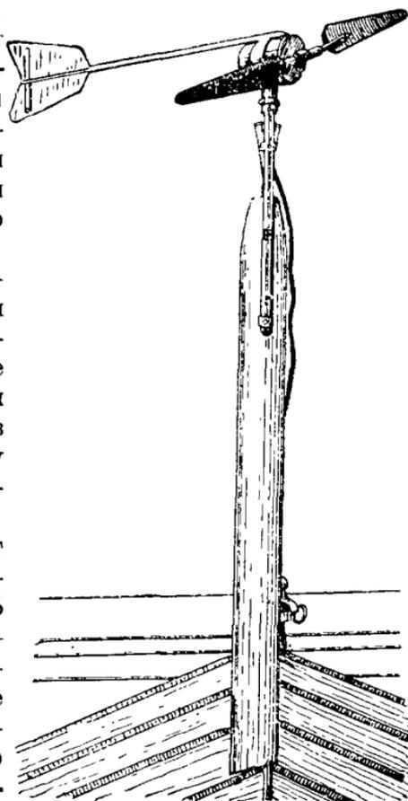
Рис. 312. Ветрозарядный агрегат ВИСХОМ РД-1,5.
