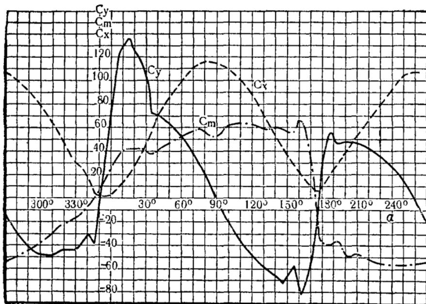
Рис. 25. Характеристики коэффициентов  $C_y$ ,  $C_x$  и  $C_m$  крыла, полученные при круговой обдувке.
