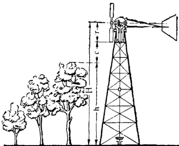
Рис. 186б. Определение высоты башни.
