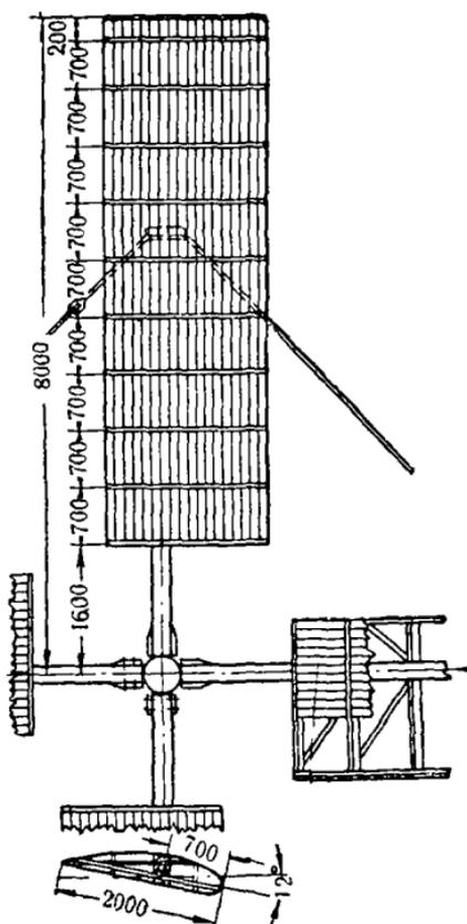
Рис. 285. Крылья ветряной мельницы ВМЭ Д-16 с обтекаемым профилем.
