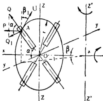
вращения точки  $A$  вокруг оси  $X-X$ . Направление силы  $P$  перпендикулярно относительной скорости  $U$  и оси вращения всей системы  $z'-z'$ . Угол  $\beta_1$  составлен скоростью  $U$  и осью  $z'-z'$ . Эти силы вызывают относительно осей  $OX$ ,  $OY$  и  $OZ$  моменты  $M_x$ ,  $M_y$  и  $M_z$ .
