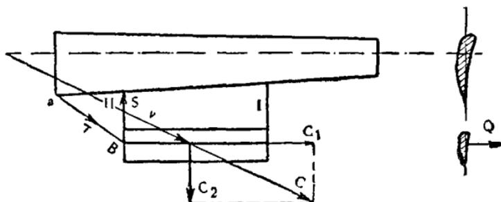
Рис. 178. Действие сил на стабилизатор.
