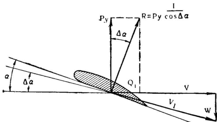
Рис. 30. Графическое изображение силы индуктивного сопротивления.
