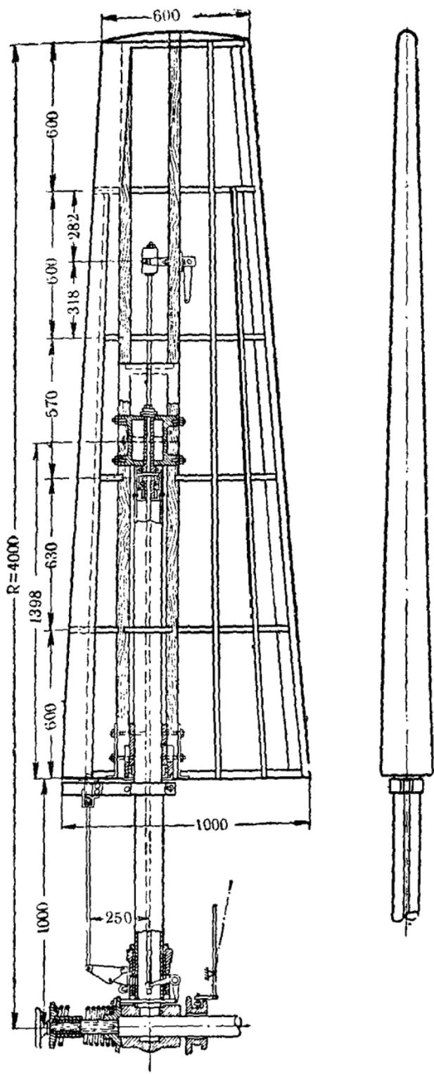
Рис. 93. Конструкция крыла экспериментального ветроколеса  $D=8$  м,  $Z_n=4,5$ ,  $t=3$ ,  $\frac{m}{b}=0,35$ .
