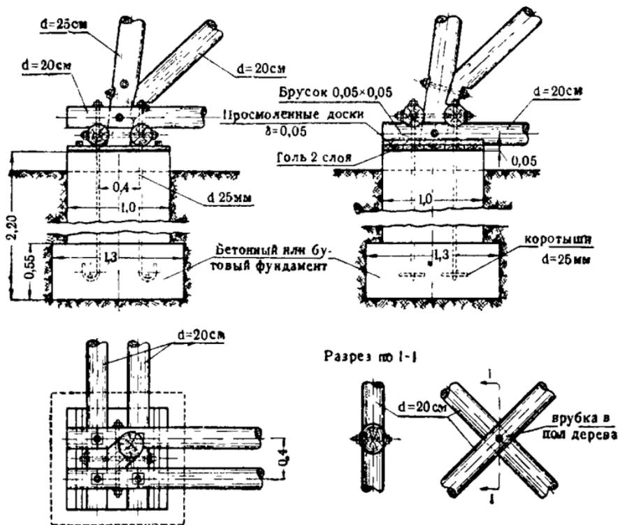
Рис. 263. Фундамент под ноги водонапорной башни.
