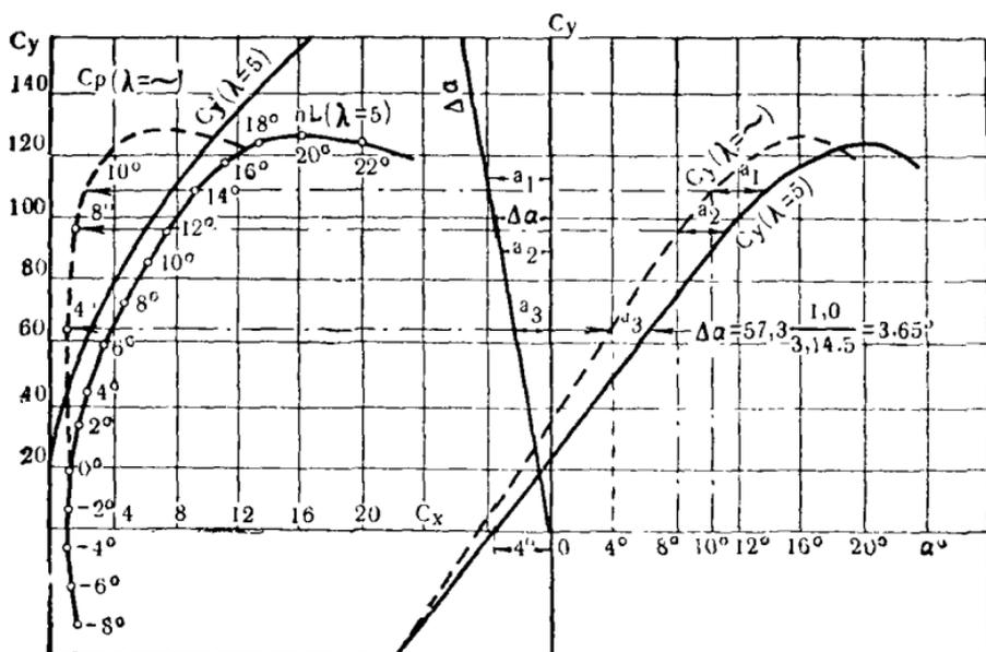
Рис. 36. Графическое построение характеристики крыла бесконечного размаха (пример).
