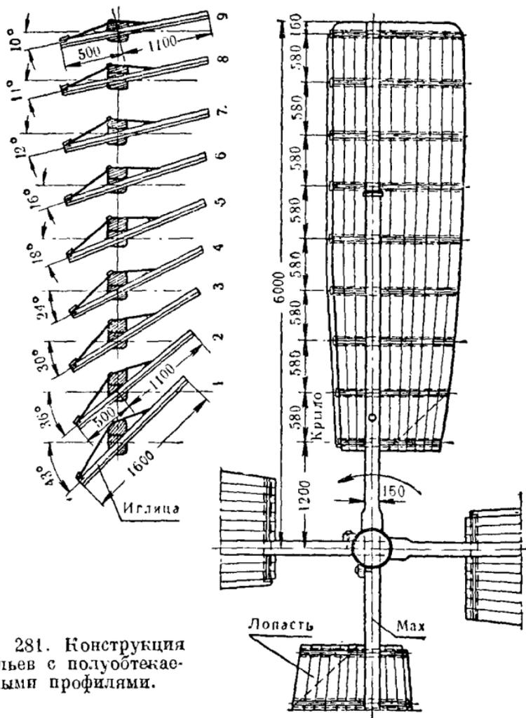
Рис. 281. Конструкция крыльев с полуобтекаемыми профилями.
