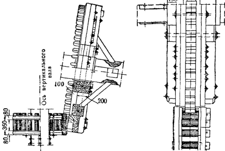
Рис. 289. Верхняя и нижняя передача ветряной мельницы.
