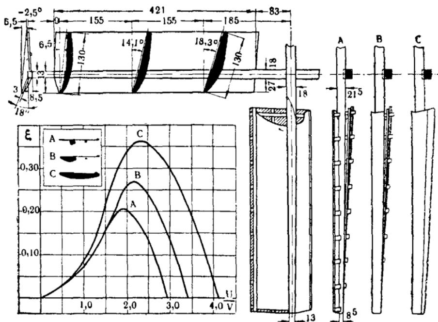
Рис. 77. Характеристика ветроколеса крестьянской ветряной мельницы с различными профилями лопастей крыла:
