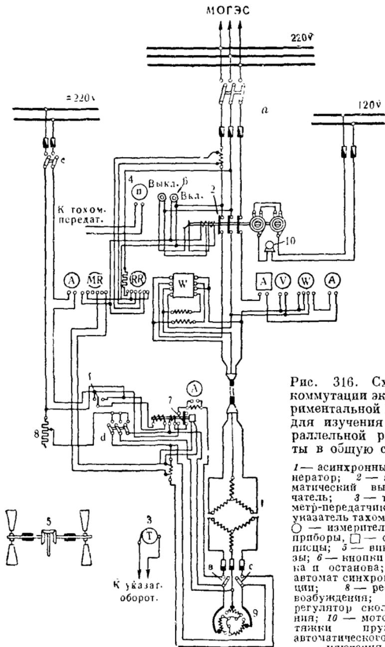
Рис. 316. Схема коммутации экспериментальной ВЭС для изучения параллельной работы в общую сеть:
