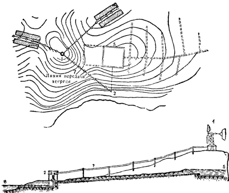
Рис. 214. Схема ветроустановки с гидроаккумулятором.
