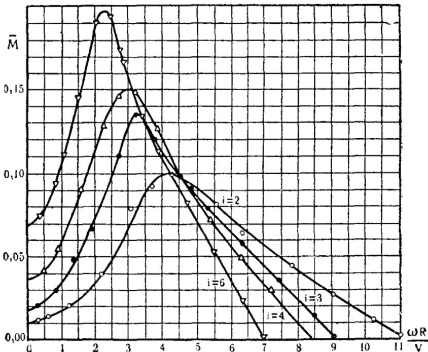
Рис. 79. Характеристика моментов ветроколеса с различным числом лопастей.
