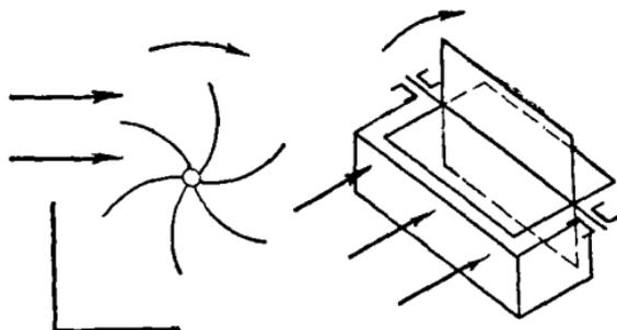
Рис. 40. Схема ветроколеса барабанного типа.
