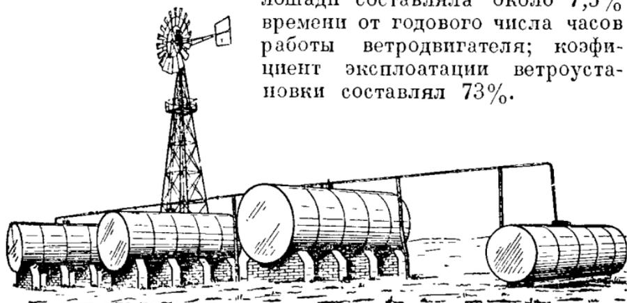
Рис. 270. Ветроустановка ТВ-5 для перекачки горючего.
