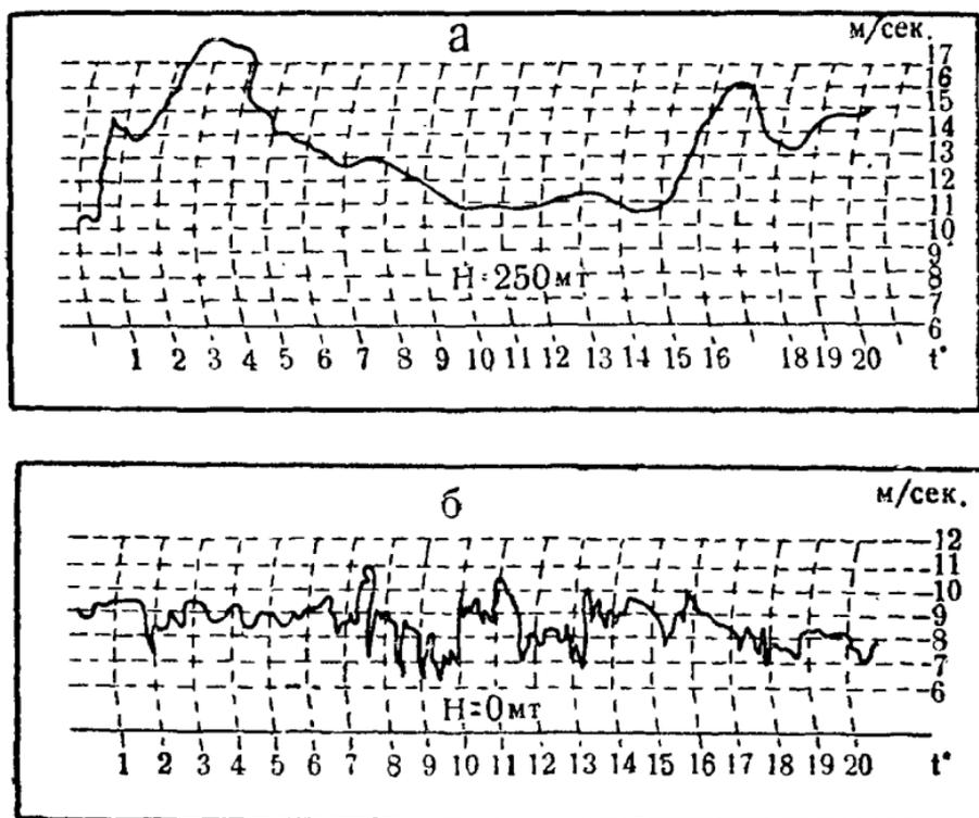
Рис. 211. Характеристики ветра: а — на высоте 250 м; б — на поверхности земли.
