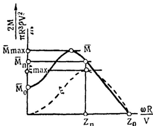
Рис. 73. Построение аэродинамической характеристики ветроколеса.
