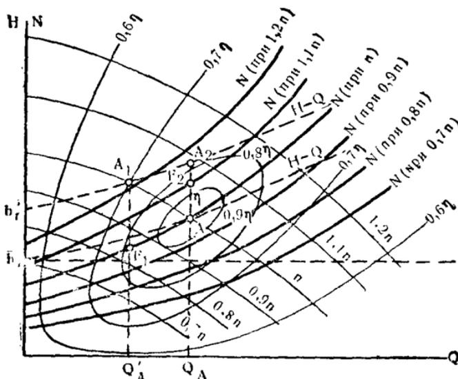
Рис. 227. Универсальная характеристика центробежных насосов.
