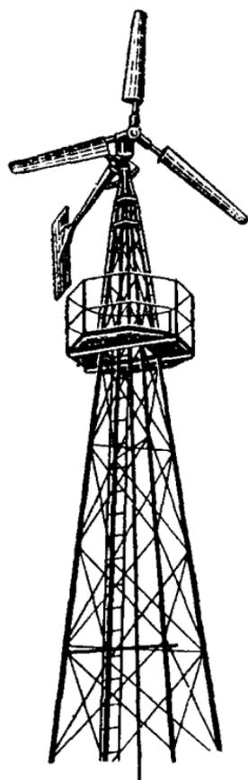
Рис. 144. Быстроходный ветродвигатель ВИМЭ Д-5.
