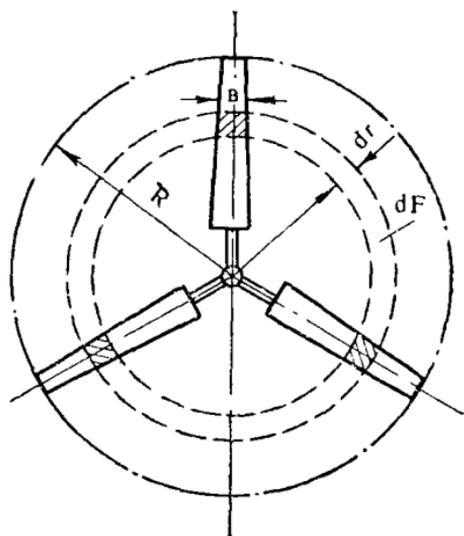
Рис. 55. Выделение элементарных лопастей на ветроколесе.
