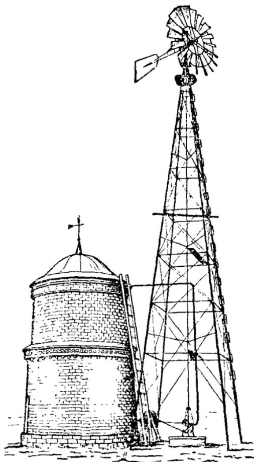
Рис. 258. Ветроустановка с металлическим баком на 20 м<sup>3</sup> в кирпичной кладке.
