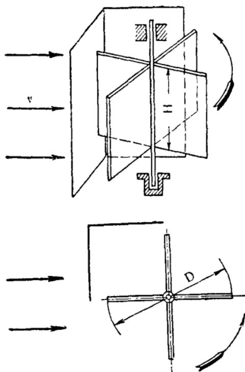
Рис. 38. Схема карусельного ветряка.
