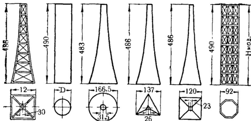
Рис. 191. Типы моделей башен, продутых в аэродинамической трубе.
