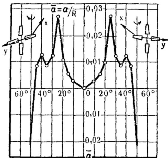
Рис. 104. Кривые центров давления  $\bar{a} = \frac{a}{R}$  4-лопастного ветряка «Сюр» без хвоста с нагрузкой в зависимости от угла  $\gamma$ .
