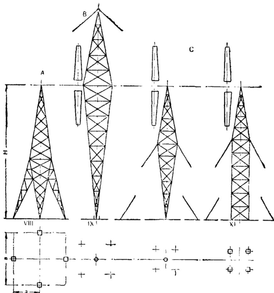
Рис. 188. Конструктивные схемы башен типа А, В и С.
