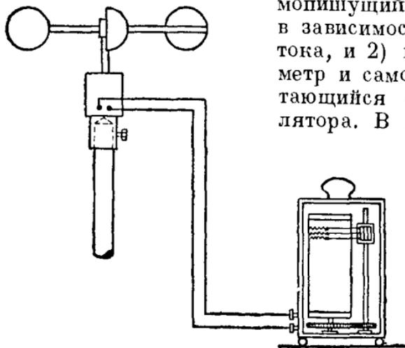
Контактный анемометр с самописцем показан на рис. 202. На бумаге, надетой на барабан самописца,
