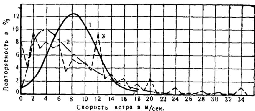
Рис. 209. Сравнение кривых повторяемости по Поморцеву и Гуллиену с действительными повторяемостями в природе:
