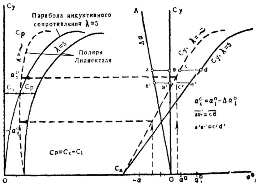
Рис. 34. Перестройка диаграммы Лилиентала с одного размаха крыла  $\lambda=5$  на другой  $\lambda=5$ .
