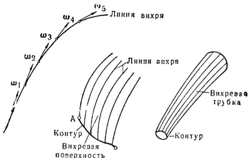
Рис. 10. Линия вихря, вихревая поверхность и вихревая трубка.
