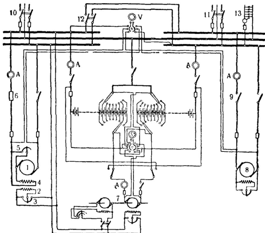
Рис. 331. Схема включения ветродвигателя и резервного двигателя.
