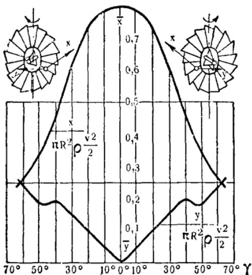
Рис. 101. Кривые коэффициентов  $Y$  и  $X$  аэродинамических сил действующих на многолопастное ветроколесо в зависимости от угла поворота ветряка от нормального положения  $M = \text{Const}$ ,  $n = 624$  об/мин,  $Z_n = 1,4$ .
