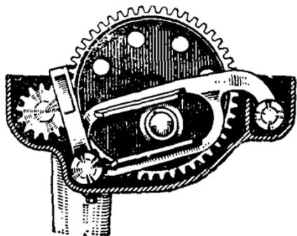
Рис. 157. Общий вид головки ветродвигателя «АСЕ».
