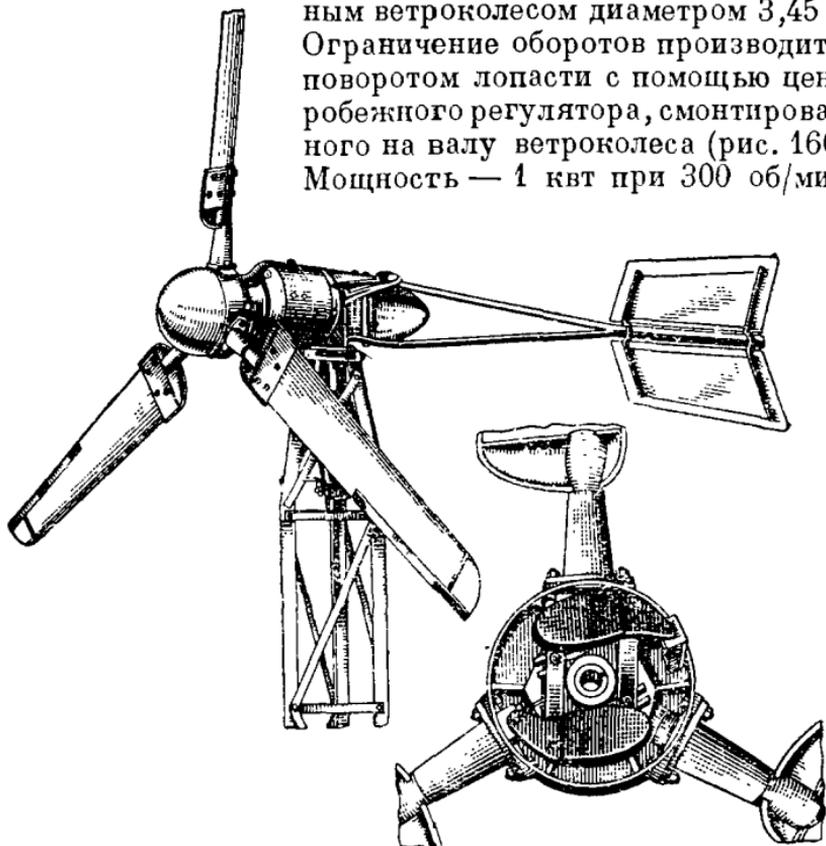
Рис. 166. Ветроэлектрический двигатель «Роралайт».
