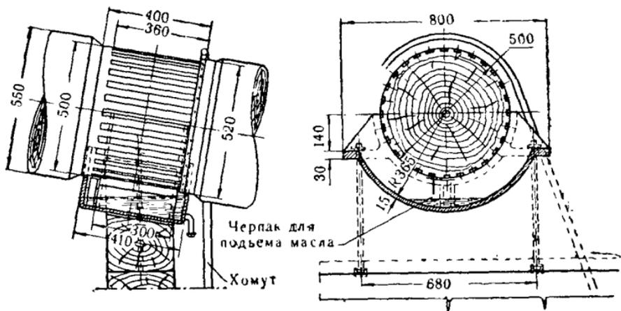
Рис. 286. Передний подшипник главного вала ветряной мельницы.
