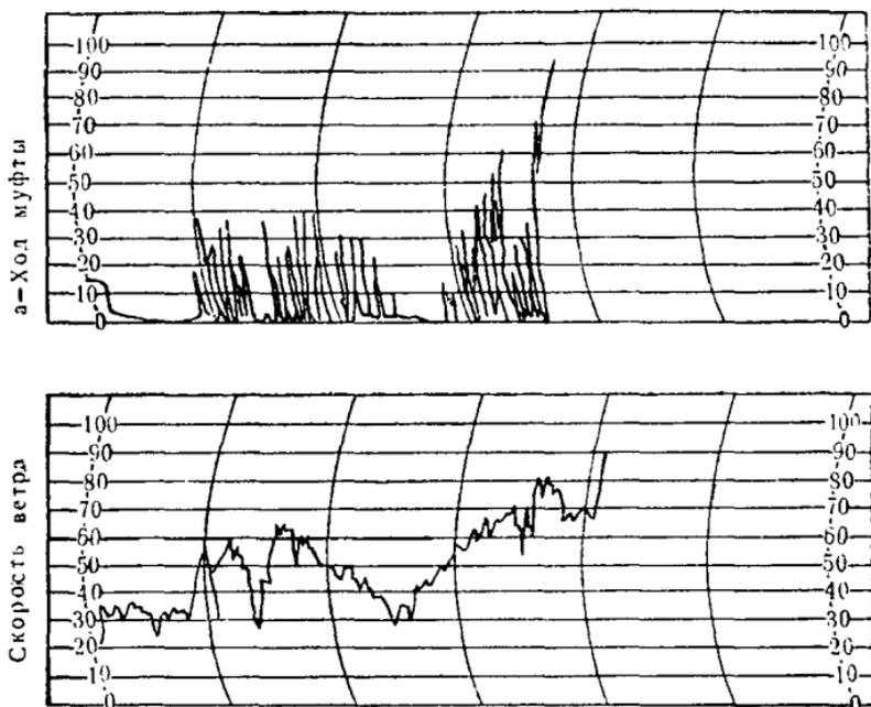
Рис. 319. Запись хода  $a$  муфты при работе ветроколеса с прибором «Аскания», действующим на муфту в зависимости от скорости ветра.
