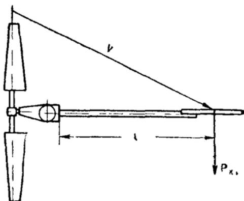
Рис. 181. Нагрузка на хвост с жёстким креплением к головке ветряка.
