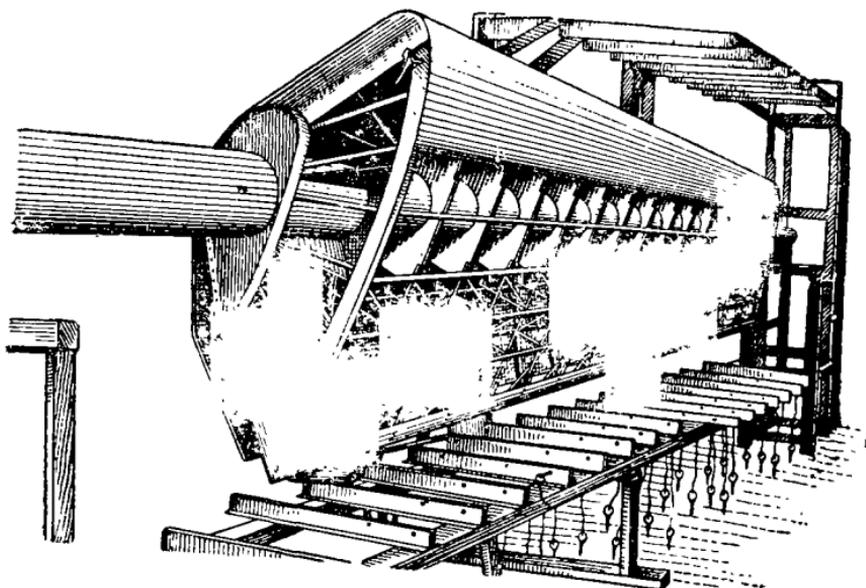
Рис. 149. Крыло с частично снятой обшивкой.
