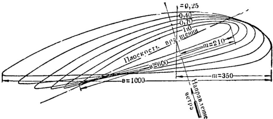
Рис. 94. Совмещение сочений лопасти крыла, показанного на рисунке 93.
