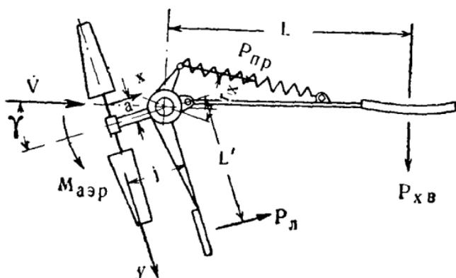
Рис. 119. Схема действия сил ветра на систему ветродвигателя, регулирующегося с помощью боковой лопасти.
