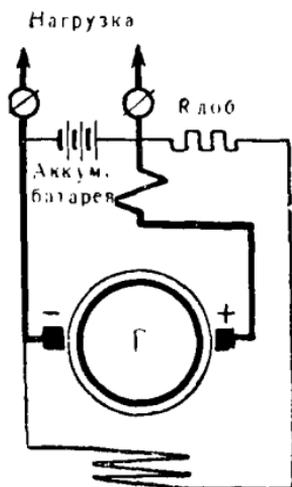
Рис. 306. Приключение аккумуляторной батареи к клеммам генератора (буфером).
