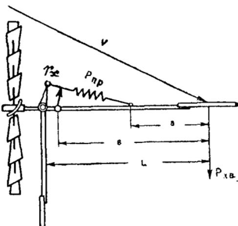
Рис. 180. Нагрузка на хвост, закреплённый шарнирно с пружиной.
