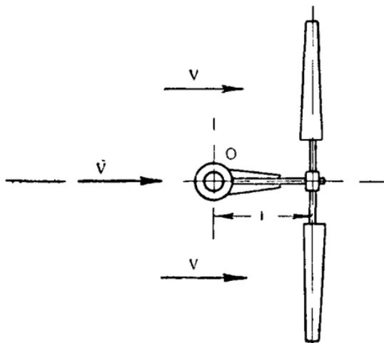
Рис. 116. Установ на ветер расположением ветроколеса за башней.
