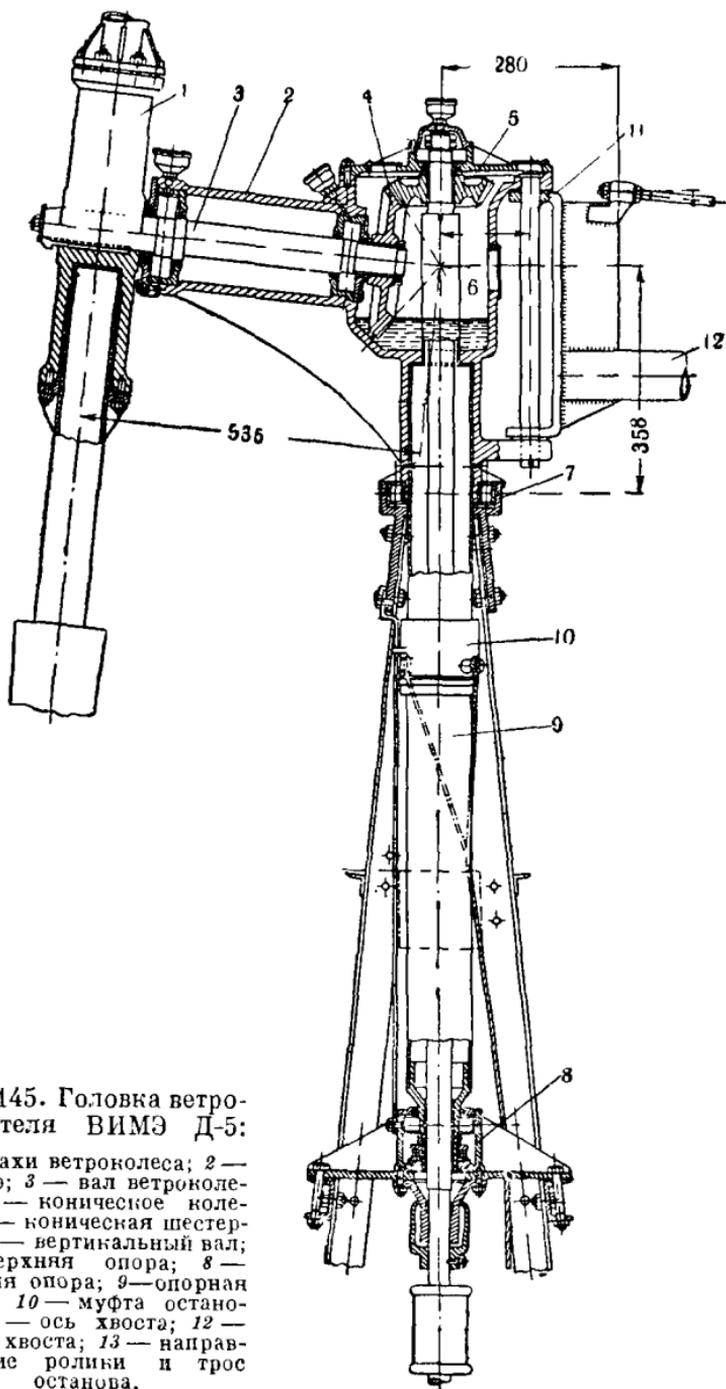
Рис. 145. Головка ветродвигателя ВИМЭ Д-5:
