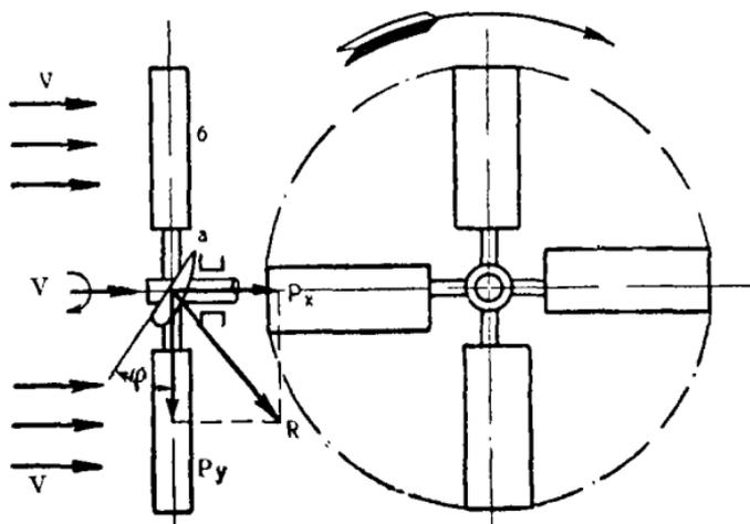
Рис. 43. Конструктивная схема крыльчатого ветроколеса.
