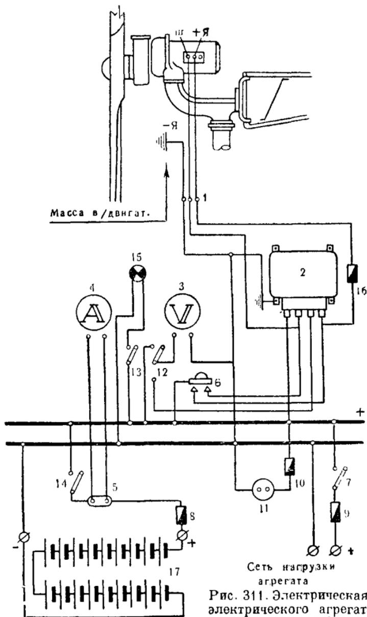
Рис. 311. Электрическая схема ветроэлектрического агрегата ВЭСХОМ Д-3,5:
