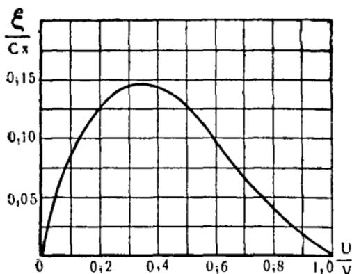
Рис. 42. Характеристика идеального коэффициента использования энергии ветра поверхностью, перемещающейся в направлении ветра.
