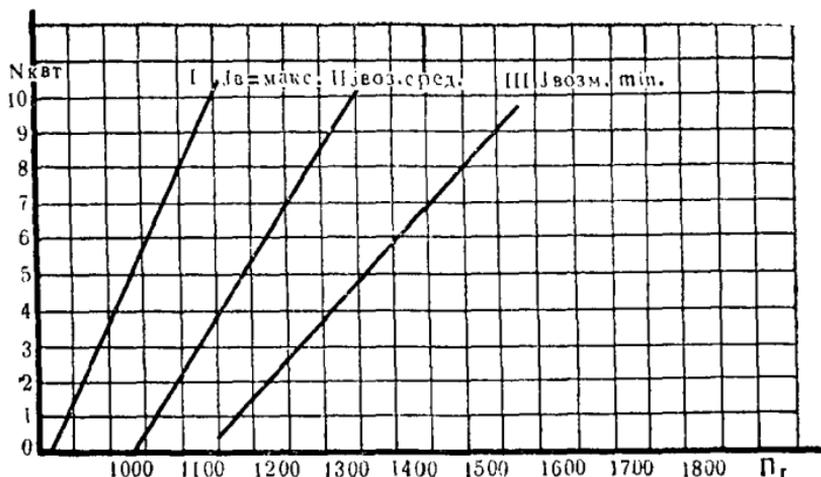
Рис. 305. Характеристика шунтового генератора с разным возбуждением.
