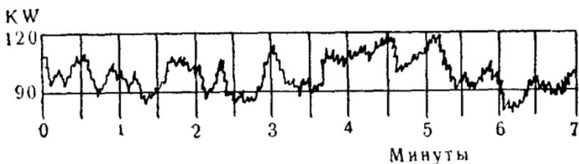
Рис. 326. Запись мощности ВЭС Д-30 при работе параллельно в сеть с асинхронным генератором.
