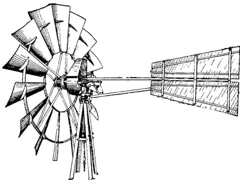
Рис. 159. Общий вид головки ветродвигателя «Стовер».
