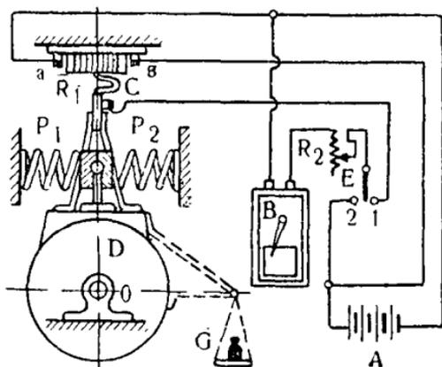
Рис. 91. Схема электродинамометра.
