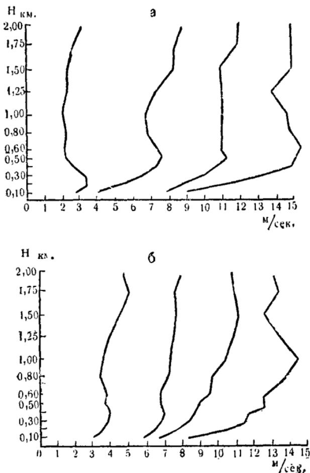
Рис. 212. Характеристика изменения скорости ветра по высоте: а — зимой в 1 час; б — летом в 13 часов.
