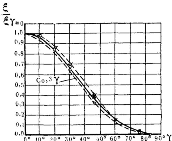
Рис. 123. Характеристика  $\frac{\xi}{\xi_{\gamma=0}}$  в зависимости от углов ветроколеса.
