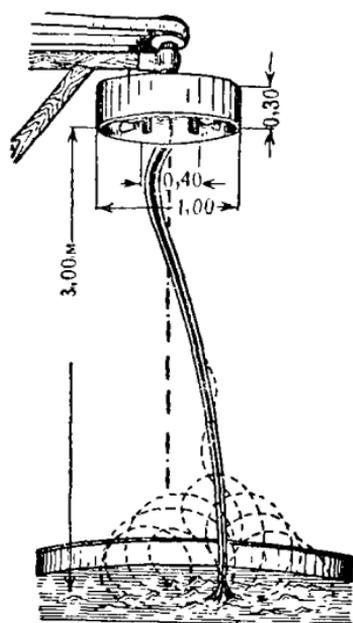
Рис. 5. Прибор для образования вихрей.
