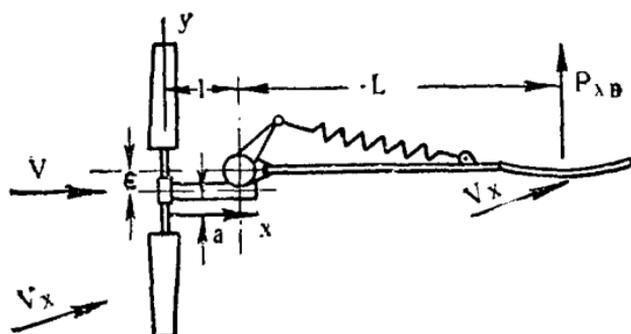
Рис. 100. Схема действия сил на ветряк, ось которого смещена относительно вертикальной оси башни.
