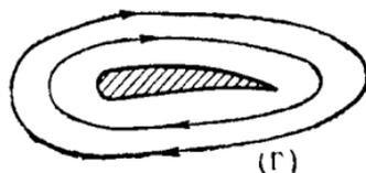
Рис. 31б. Циркуляция скорости вокруг крыла.
