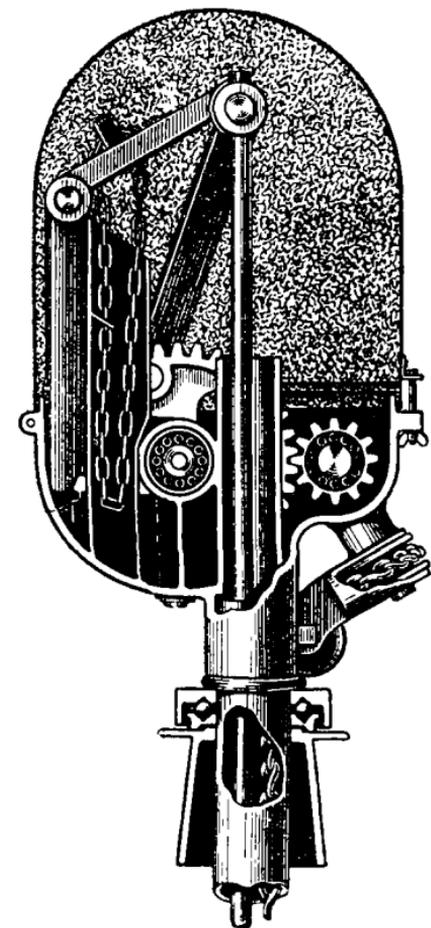
Рис. 163. Головка ветродвигателя «Гигант».
