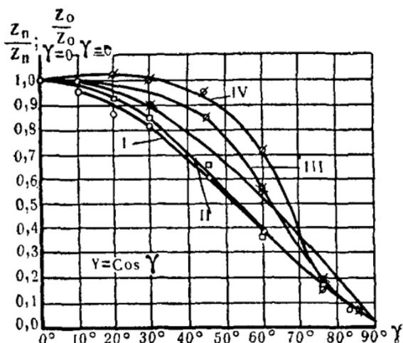
Рис. 124. Характеристика нормальной и синхронной скорости вращения ветроколёс.
