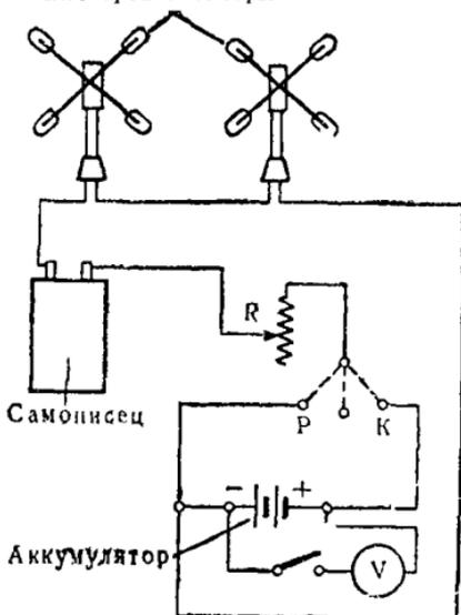
Рис. 90. Схема измерения скорости ветра двумя электродинамометрами.
