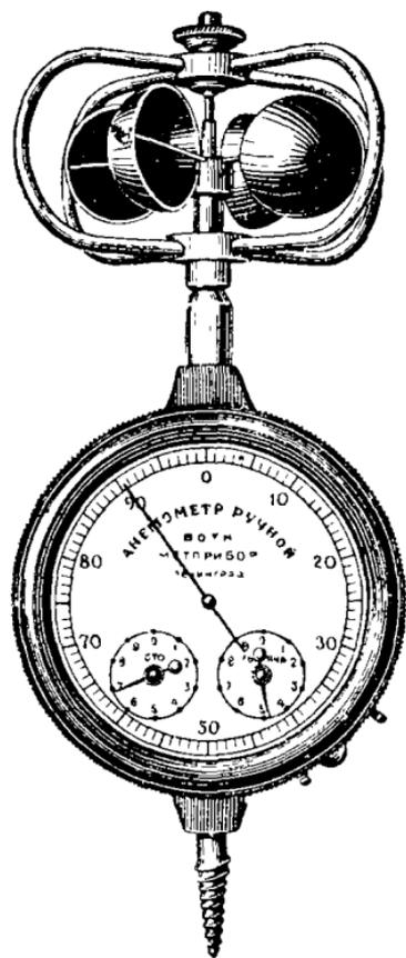
Рис. 200. Анемометр завода «Метприбор».
