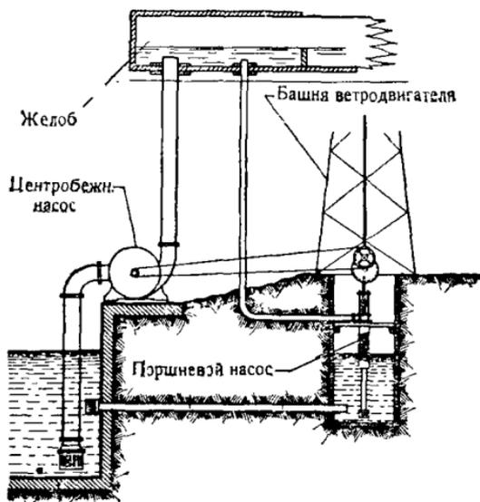
Рис. 241. Схема параллельной работы центробежного и поршневого насосов.
