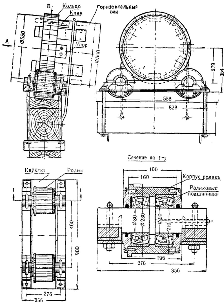
Рис. 287. Роликовая опора переднего подшипника главного вала.
