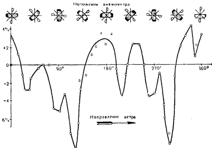
Рис. 201. Изменение показаний анемометра в зависимости от различных положений его в потоке ветра.
