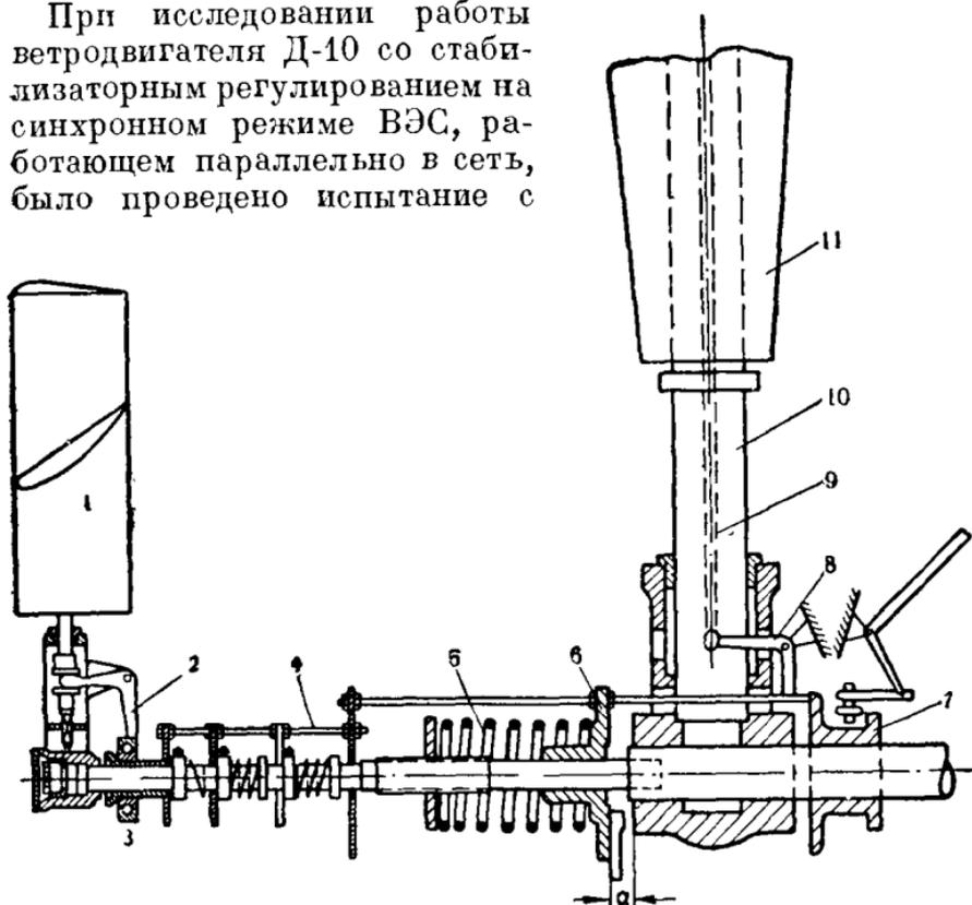
Рис. 317. Приспособление В. С. Шаманина для ограничения мощности ветродвигателя, регулирующегося поворотом лопасти под действием центробежных сил:
