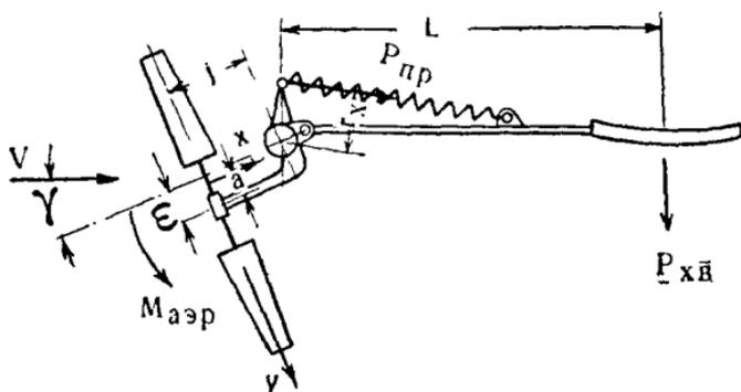
Рис. 120. Схема действия сил на систему ветродвигателя, регулирующегося выводом ветроколеса из-под ветра за счёт смещения оси ветроколеса относительно оси башни.
