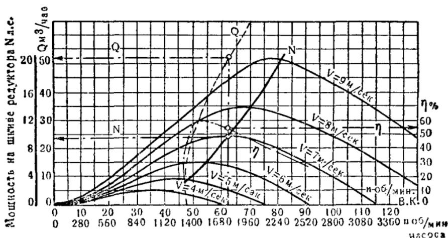
Рис. 233. Совмещённые характеристики ветродвигателя ВПМЭ Д-12 и центробежного насоса.
