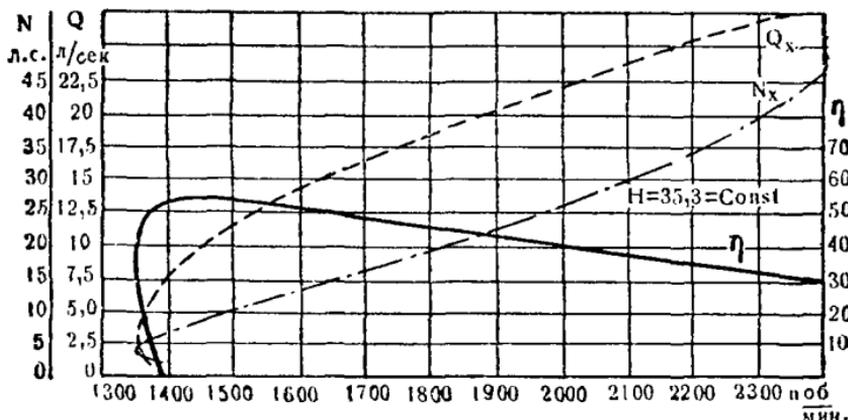
Рис. 228. Пересчитанная характеристика центробежного насоса в зависимости от  $n$  при  $H = \text{Const}$ .
