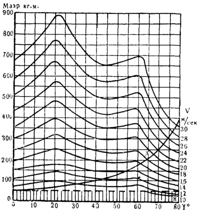
Рис. 127. Кривые аэродинамических моментов ветродвигателя ТВ-8.
