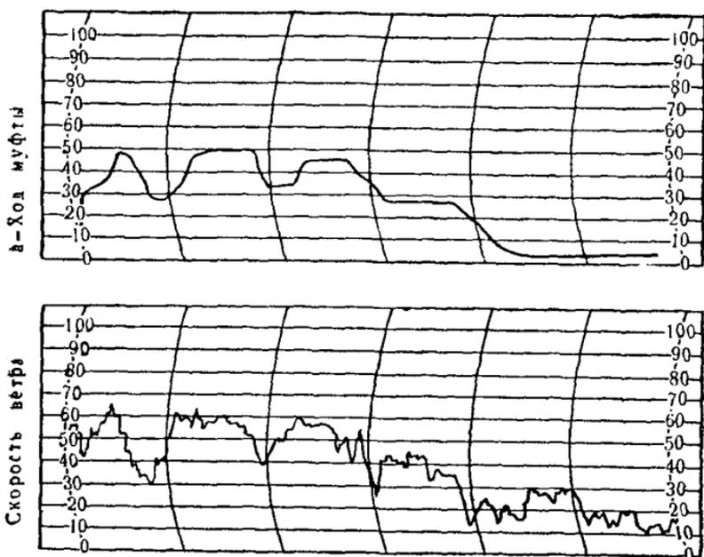
Рис. 320. Запись хода  $a$  муфты при работе ветроколеса с ветрянкой, действующей на муфту в зависимости от скорости ветра.
