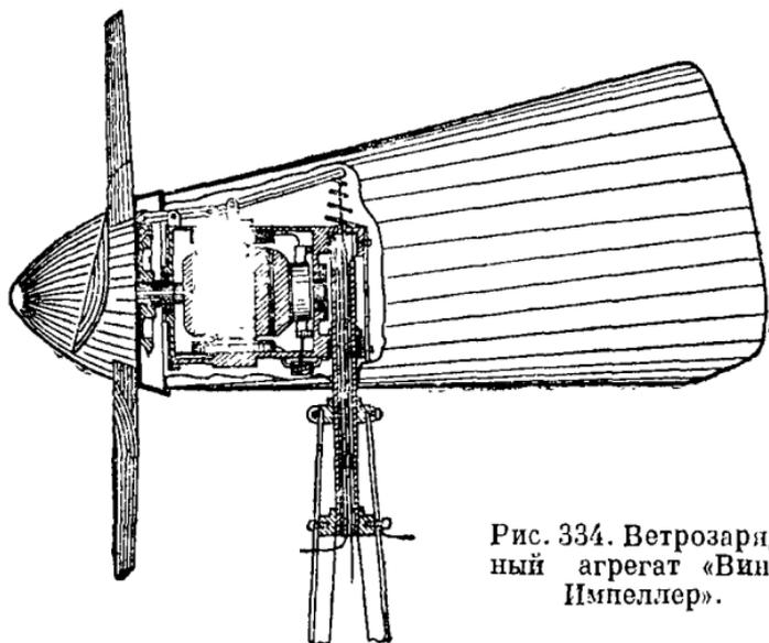
Рис. 334. Ветрозарядный агрегат «Винд-Импеллер».
