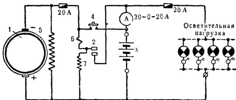
Рис. 313. Электрическая схема ветрозарядного агрегата ВИСХОМ РД-1,5:
