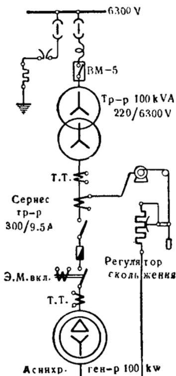
Рис. 323. Электрическая схема ветроэлектростанции Д-30.
