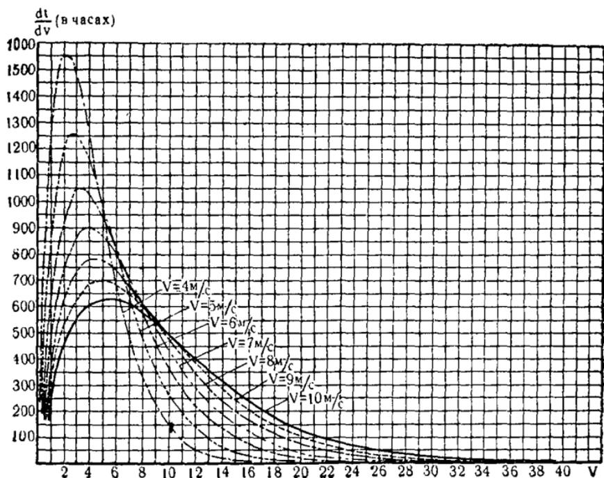
Рис. 208. Кривые повторяемости ветров по Гуллиену.
