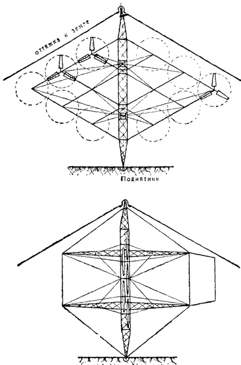
Рис. 329. Схема многоветряковой ветроэлектростанции системы А. Г. Уфимцева и В. П. Ветчинкина.
