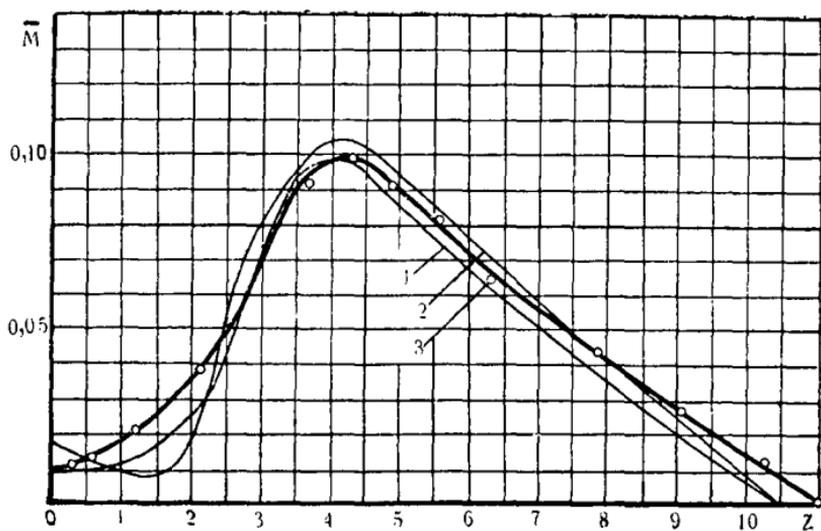
Рис. 81. Характеристики моментов теоретические и экспериментальные для 2-лопастной модели ветроколеса.
