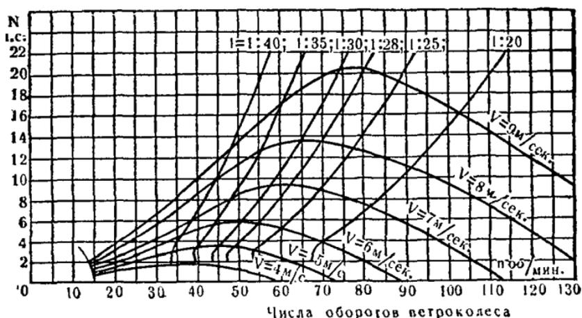
Рис. 237. Совмещённые характеристики ветродвигателя ВИМЭ Д-12 и центробежного насоса при разных передаточных отношениях.
