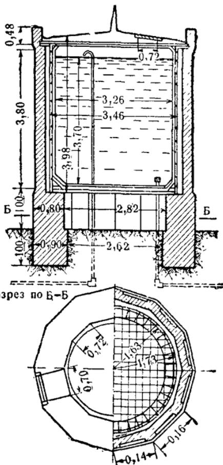
Рис. 259. Железобетонный резервуар на  $30 \text{ м}^3$ .
