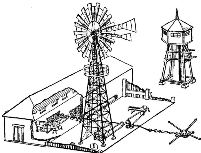
Рис. 267. Ветроустановка ТВ-8 для работы на кормоцех.
