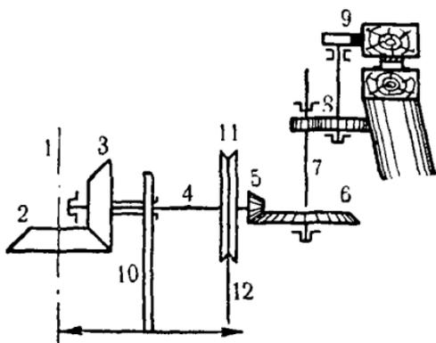
Рис. 293. Схема поворота шатра с помощью передачи.
