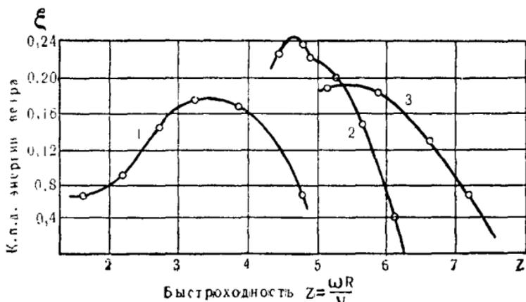
Рис. 325. Аэродинамическая характеристика крыльев ветроэлектростанции Д-30.
