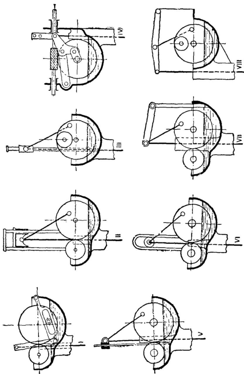
Рис. 156. Схемы передаточных механизмов ветродвигателей, работающих с поршневыми насосами.
