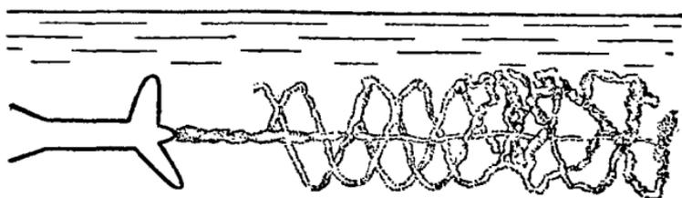
Рис. 4. Вихреобразование за винтом моторной лодки.
