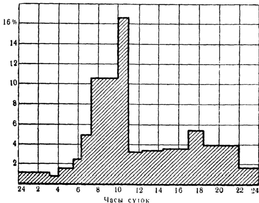
Рис. 256. Суточный график расхода воды для животных.
