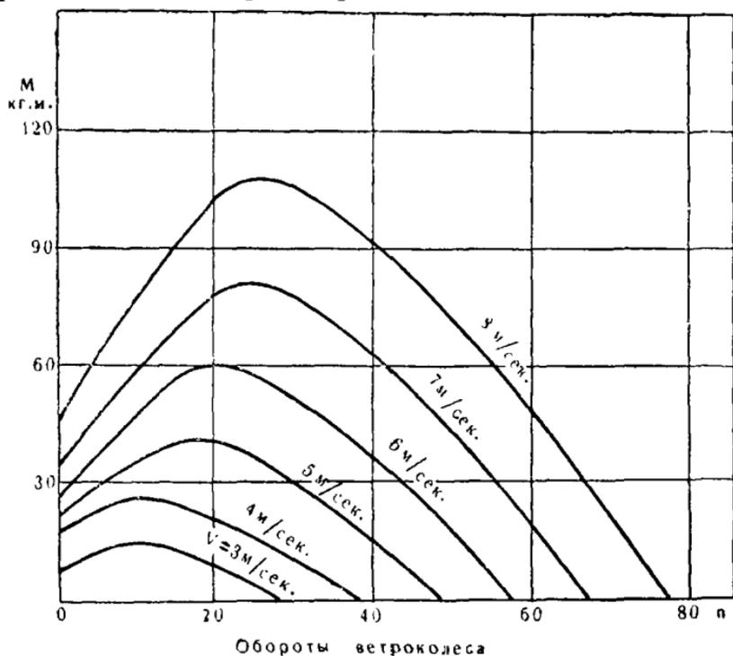
Рис. 220. Характеристика размерных моментов ветроколеса ВИМЭ Д-8.
