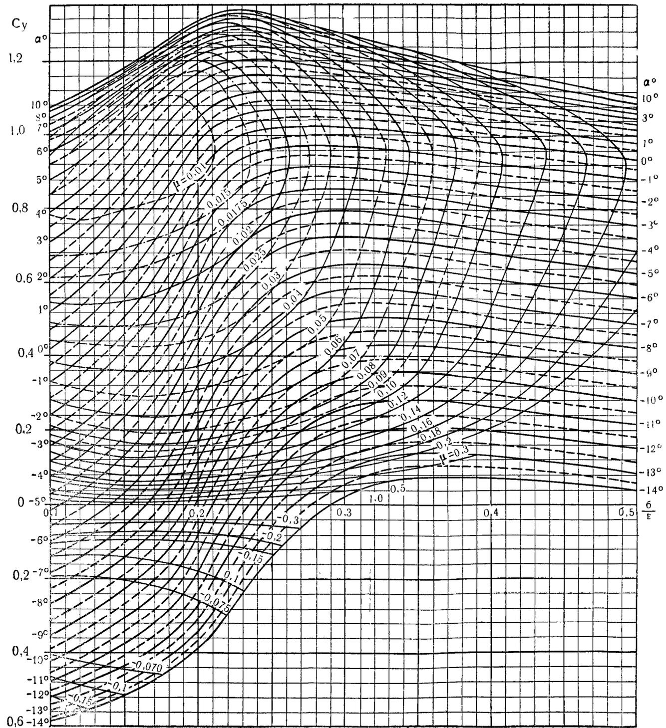
Рис. 63. График для определения  $C_y$  и  $\mu$  крыльев бесконечного размаха с профилем «Эсперо» в зависимости от  $\alpha = 14$  до  $10^\circ$ .
