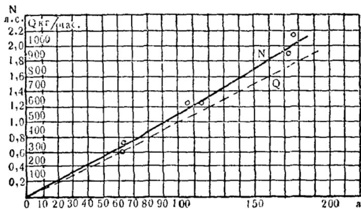
Рис. 254. Расход мощности на работу соломорезки в зависимости от оборотов и производительность (свежая ржаная солома).
