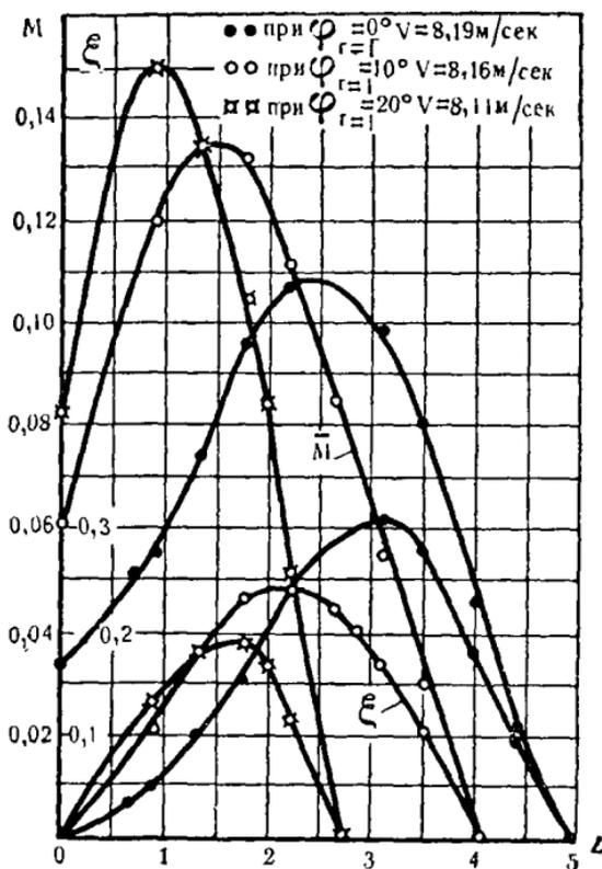
Рис. 282. Характеристика крыльев с полуобтекаемыми профилями.
