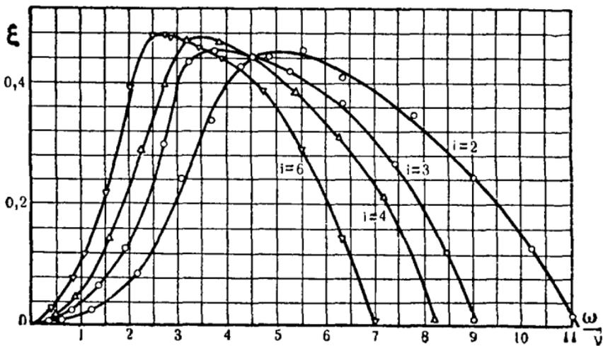
Рис. 78. Характеристика ветроколеса с различным числом лопастей.
