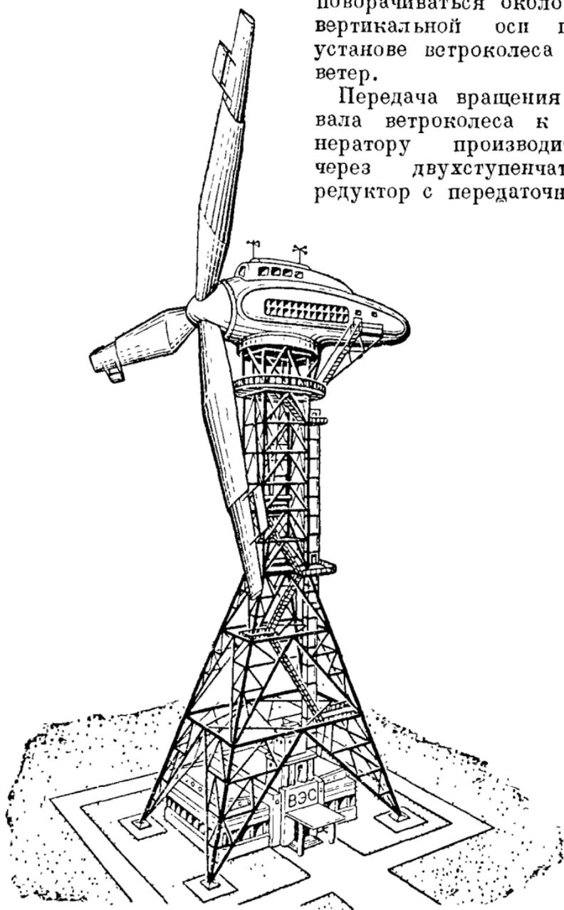
Рис. 327. Ветроэлектростанция ЦВЭИ Д-50 на 1 000 квт (проект).
