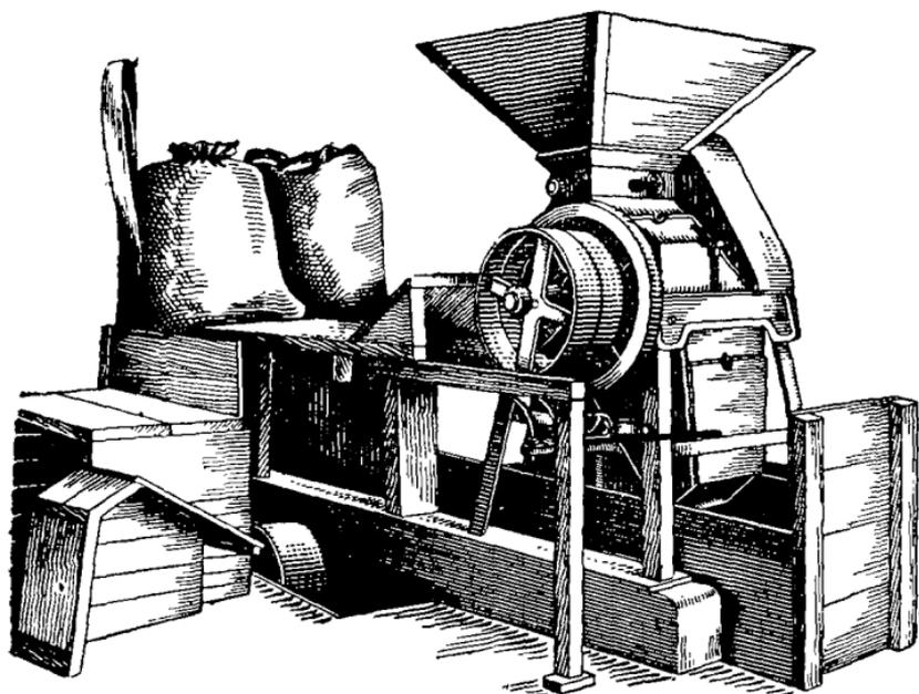
Рис. 248. Зернодробилка-плющилка 3Д.
