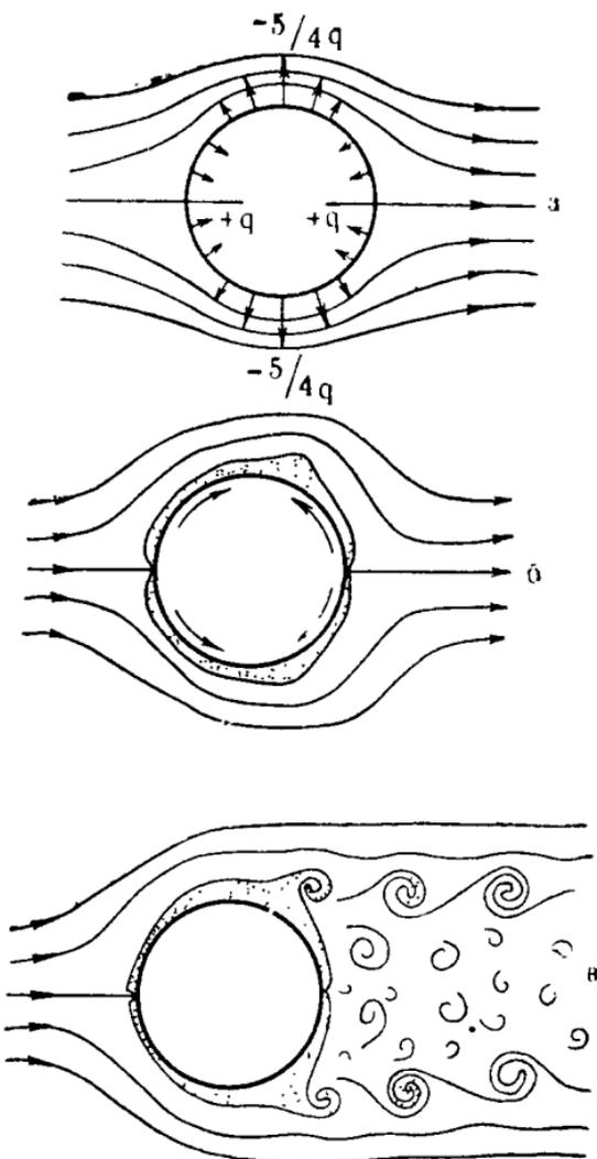
Рис. 22. Образование вихрей позади шара.
