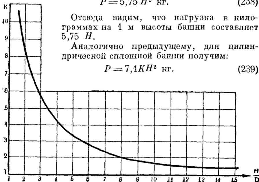
Рис. 192. Зависимость коэффициента  $K$  цилиндрических башен от отношения высоты к диаметру башни.
