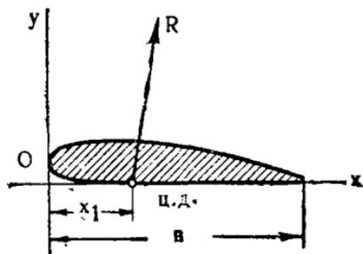
Рис. 27. Определение центра давления.
