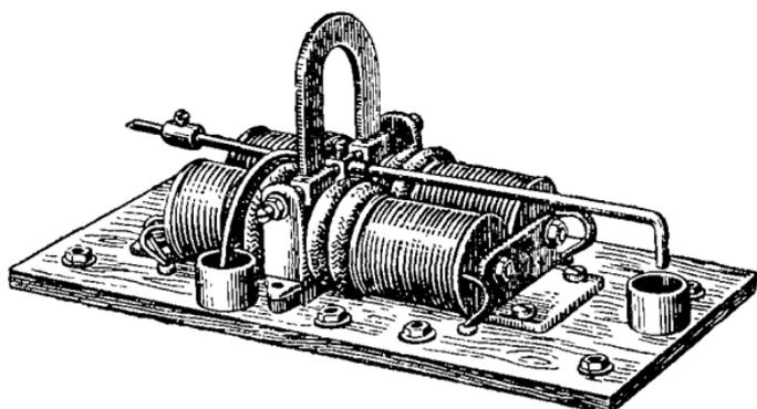
Рис. 300. Автоматический выключатель.
