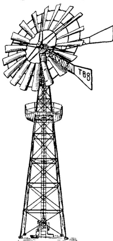
Рис. 140. Ветродвигатель ТВ-8.
