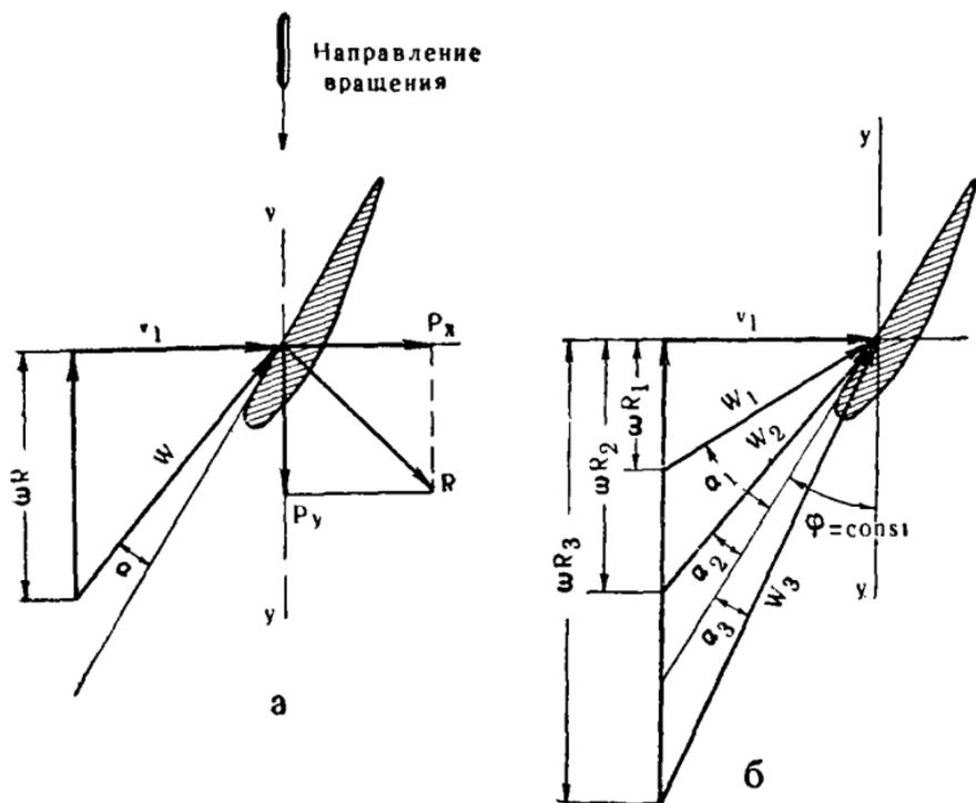
Рис. 44. а — схема действия сил воздушного потока на элемент лопасти; б — графическое изображение относительного потока, набегającego на элементы лопасти, расположенные на разных радиусах ветроколеса.
