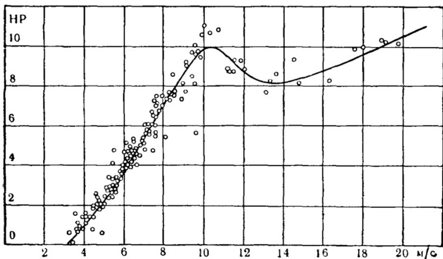
Рис. 321. Характеристика мощности ветроэлектрического агрегата, работающего без регулирования в общую электросеть.
