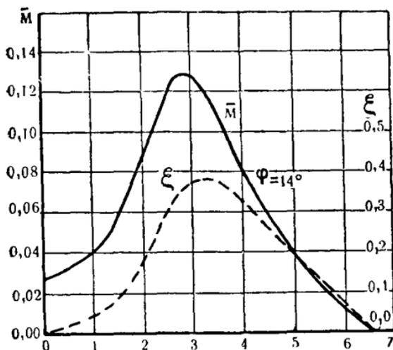
Рис. 76. Характеристика 4-лопастного ветроколеса с обтекаемыми плоскими лопастями. Угол заклинивания  $\varphi = 14^\circ = \text{Const.}$
