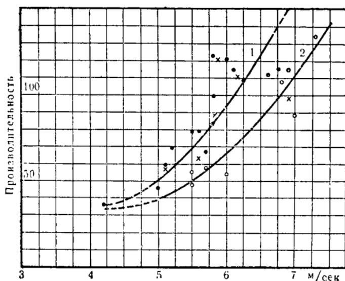
Рис. 299. Характеристика производительности ветряной мельницы ВИМЭ Д-10:
