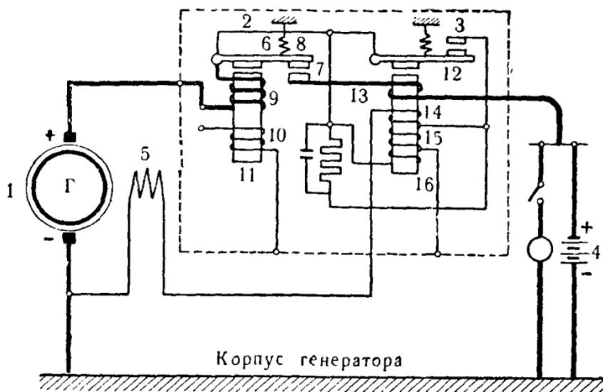
Рис. 309. Электрическая схема реле-регулятора РР:
