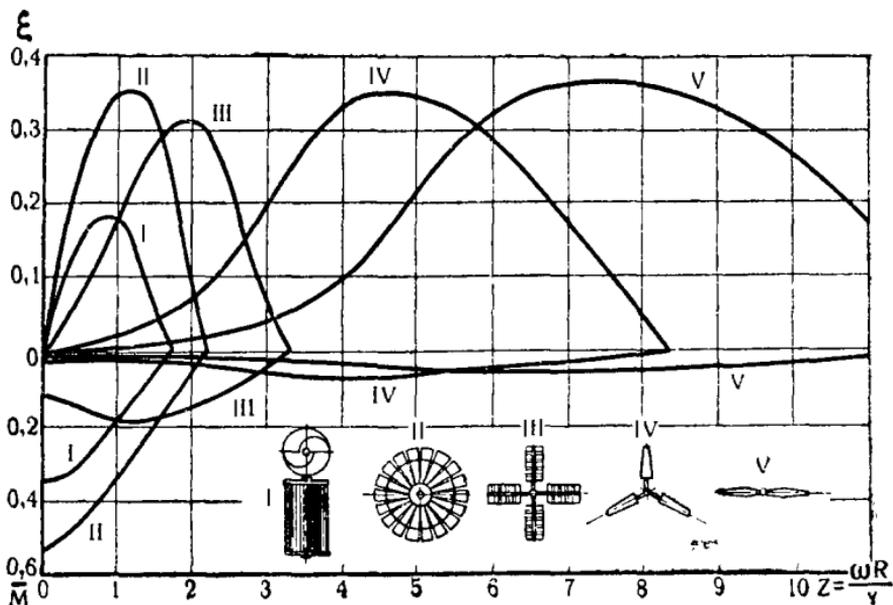
Рис. 216. Аэродинамические характеристики ветроколёс различных систем.
