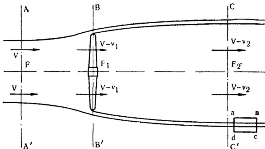
Рис. 52. Схема прохождения воздушного потока через ветроколесо.
