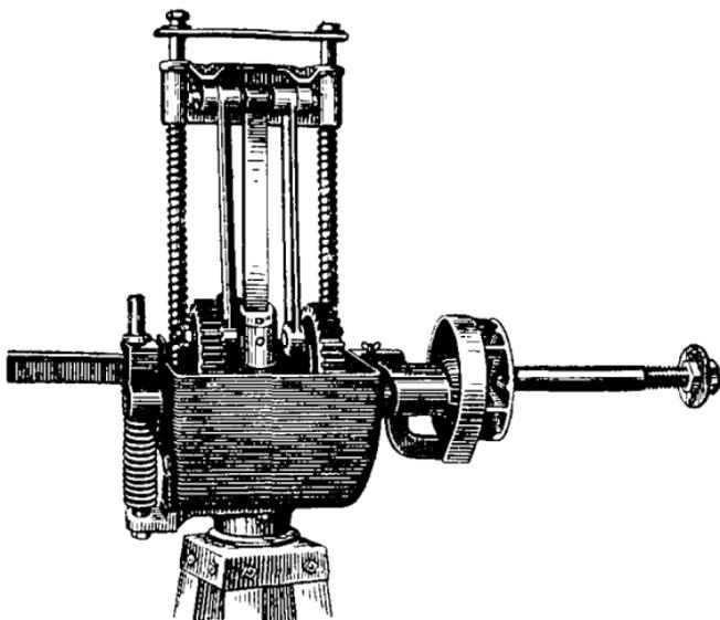
Рис. 158. Головка ветродвигателя «Фриман».
