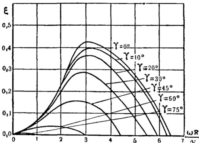
Рис. 122. Характеристика 4-лопастного ветряка в зависимости от угла  $\gamma$  отклонения оси ветряка от направления ветра.
