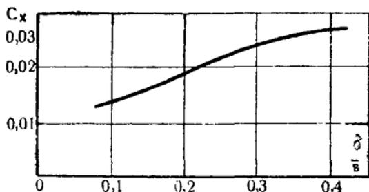
Рис. 194. Значения коэффициентов  $C_x$  в зависимости от  $\frac{\delta}{v}$
