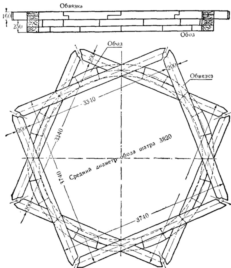
Рис. 291. Обвязка и обод шатра.
