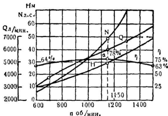
Рис. 226. Характеристика центробежного насоса в зависимости от его числа оборотов.
