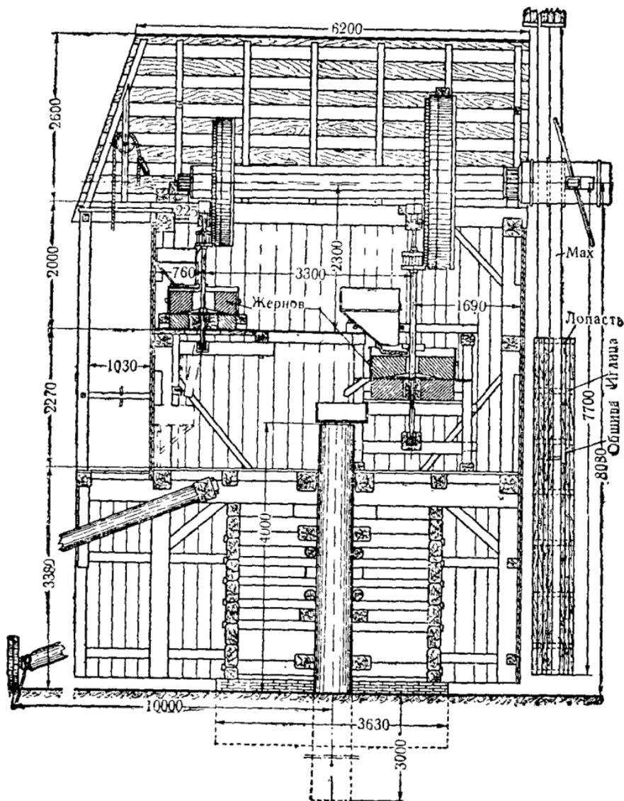
Рис. 277. Разрез козловой ветряной мельницы.
