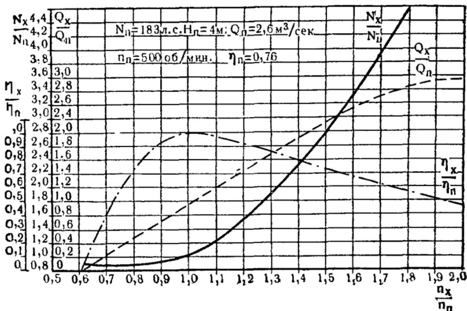
Рис. 235. Безразмерная характеристика пропеллерного насоса  $N=183$  л. с.,  $n=500$  об/мин.,  $Q=2,6$  м<sup>3</sup>/сек.,  $H=4$  м;  $\eta=0,76$ .
