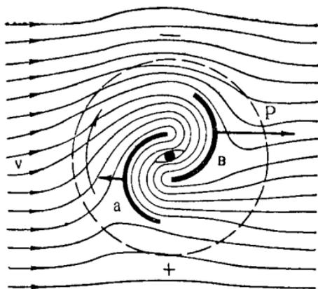
Рис. 49. Схема движения ветрового потока при обтекании ротора Савониуса.
