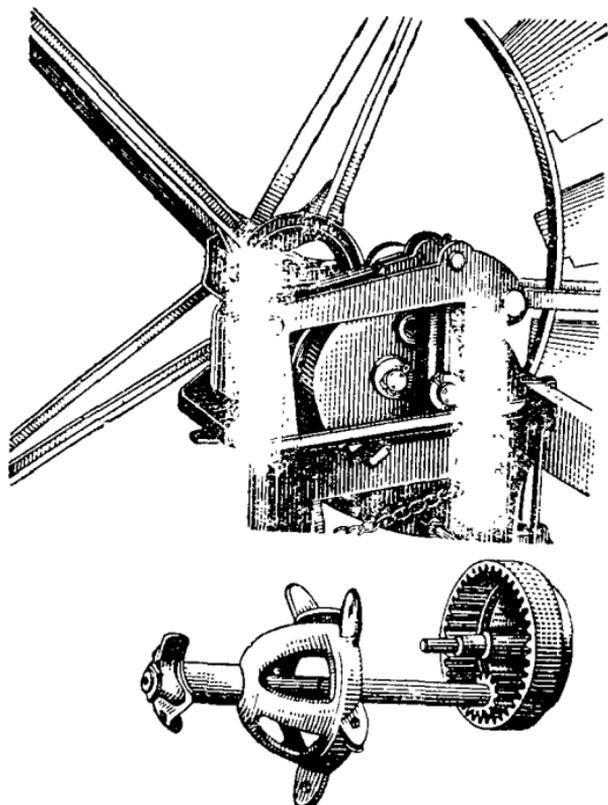
Рис. 164. Головка ветродвигателя «ИЗИ» и передаточный механизм.
