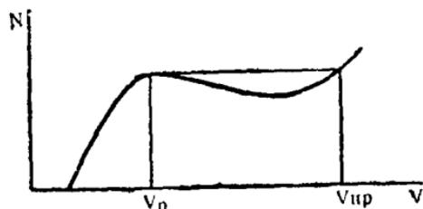
Рабочая характеристика ветряка  $Z=6$  и выше при условии  $n=Const$ ;  $N=f(V)$  дана на рис. 179, где:  $V_p$  — скорость ветра, при которой ветроколесо работает с максимальной мощностью;
