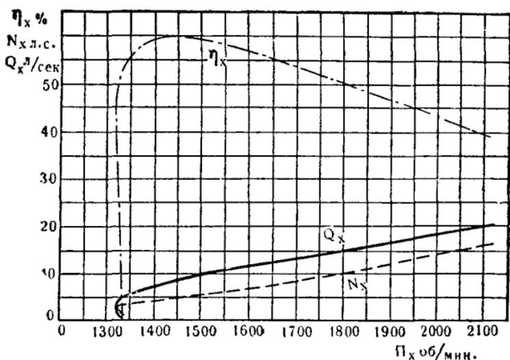
Рис. 232. Пересчитанная характеристика центробежного насоса в зависимости от  $n$  при  $H=24 \text{ м} = \text{Const}$ .
