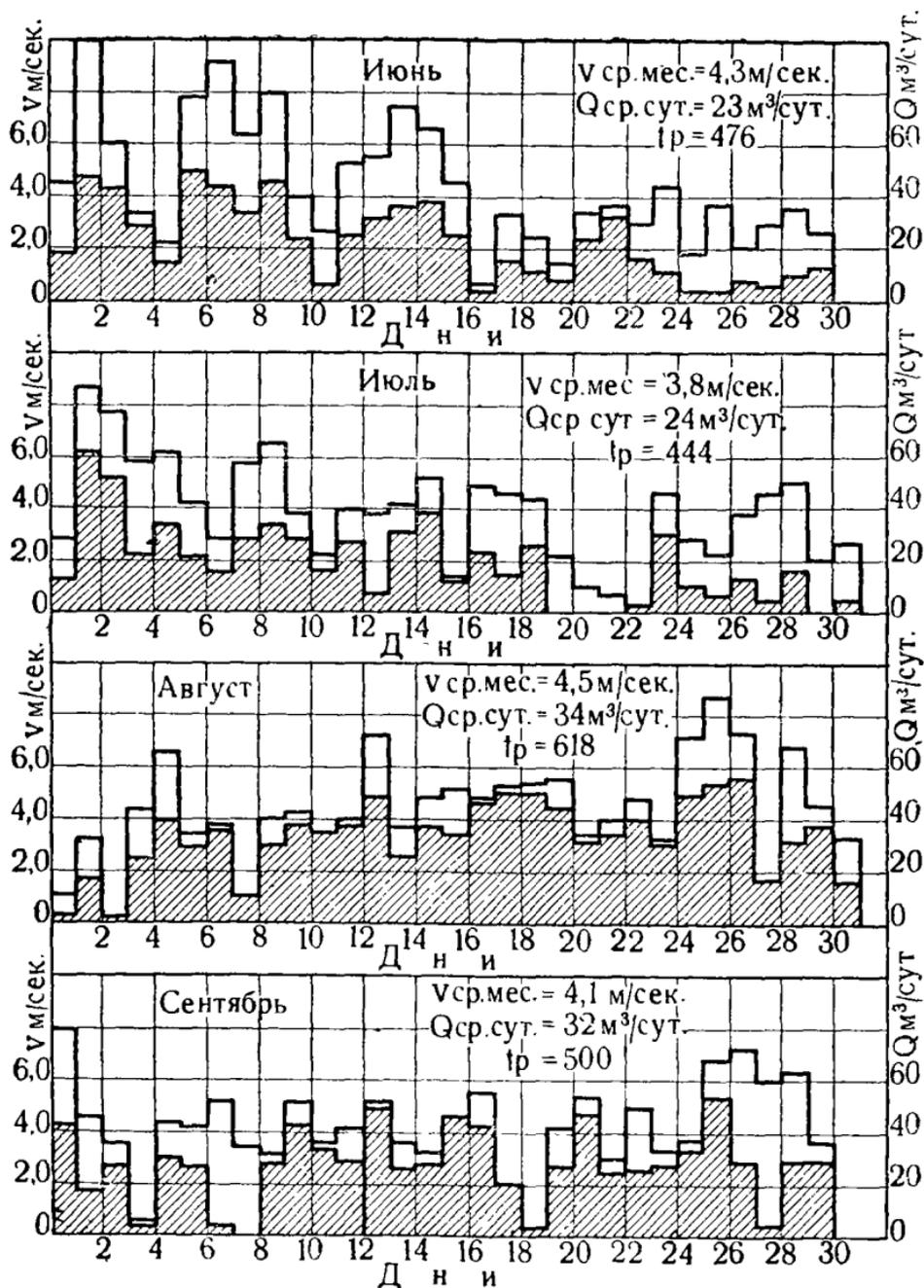
Рис. 269. График годовой работы ветронасосной установки ТВ-5, показанной на рисунке 268 (продолжение).
