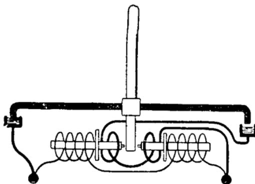
Рис. 301. Схема выключателя.
