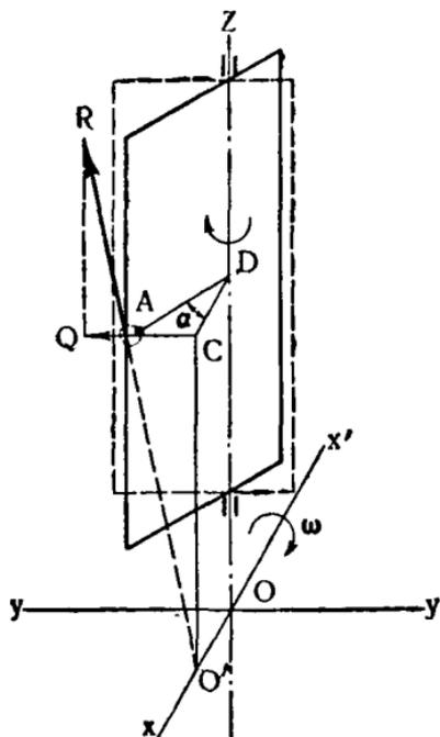
Рис. 134. Силы, действующие на поворотную лопасть.
