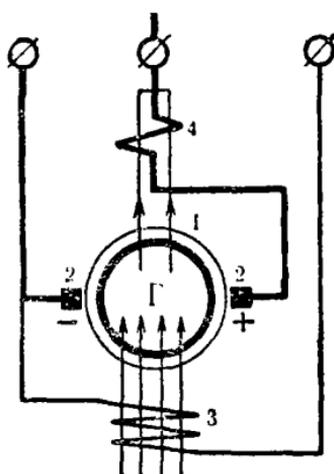
Рис. 303. Схема шунтового генератора с компандным возбуждением:
