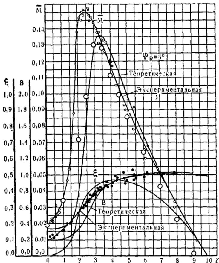
Рис. 86. Экспериментальная и теоретическая характеристика ветряка  $D=2,2$ ;  $Z_n=4,5$ ;  $i=3$ .
