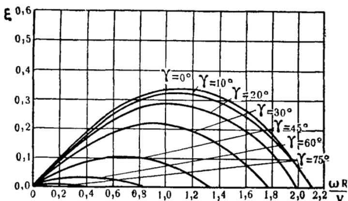
Рис. 121. Характеристика 18-лопастного ветроколеса в зависимости от угла  $\gamma$  отклонения оси вращения от направления ветра.
