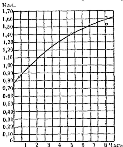
Рис. 253. Расход мощности на соломорезку в зависимости от времени работы с момента заточки ножей.
