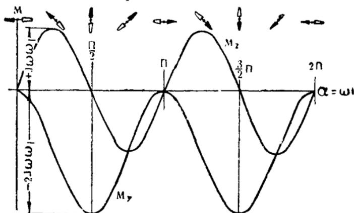
Рис. 113. Характеристика гироскопического момента двухлопастного ветроколеса.
