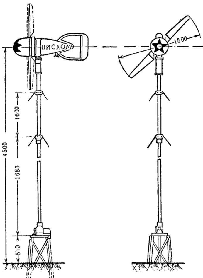
Рис. 314. Ветроэлектрический агрегат ВИСХОМ УД-1,5.
