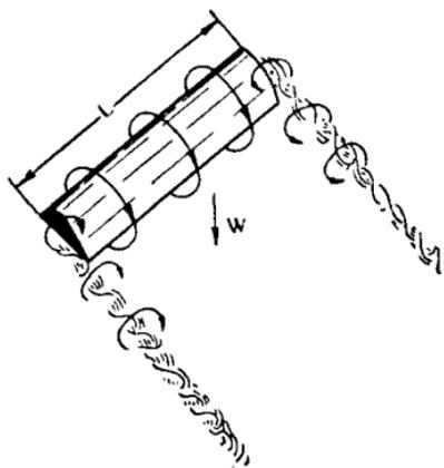
Рис. 29. Вихревые шнуры, сбегаящие с концов крыла конечного размаха.
