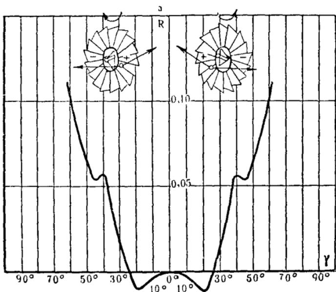
Рис. 103. Кривые центров давления  $\bar{a} = \frac{a}{R}$  18-лопастного ветряка к рисунку 101.
