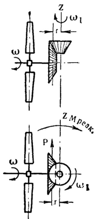
Рис. 107. Схема действия реактивного момента передачи.
