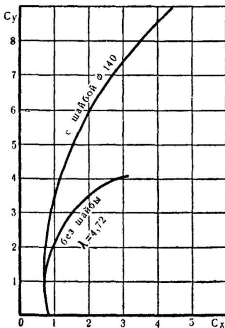
Рис. 48. Поляра ротора к рис. 47.
