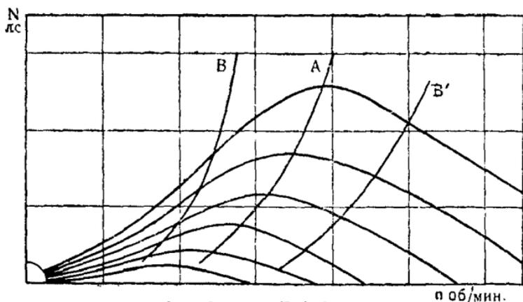
Рис. 218. Рабочая характеристика ветросилового агрегата с различными режимами работы.
