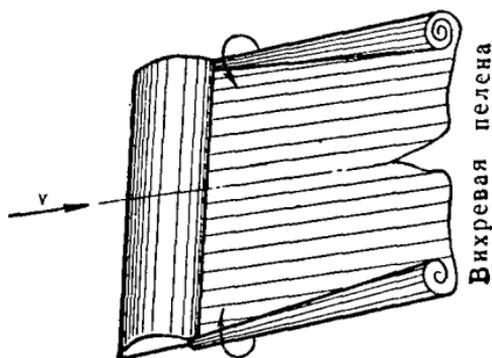
Рис. 28. Вихри, сбегаящие с крыла конечного размаха, образуют позади крыла вихревую пелену.
