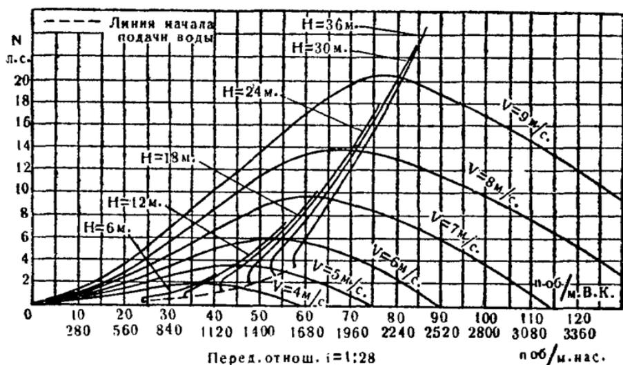
Рис. 234. Совмещённые характеристики ветродвигателя ВИМЭ Д-12 и центробежного насоса при разных напорах.
