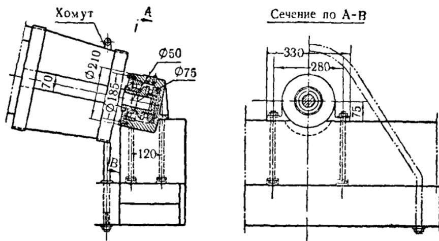
Рис. 288. Задний подшипник главного вала.
