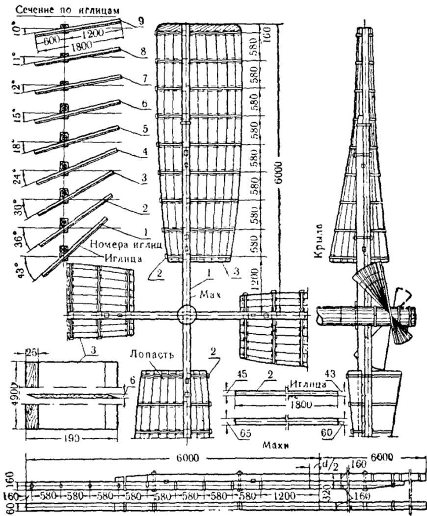
Рис. 280. Конструкция крыльев с плосковинтовыми лопастями.
