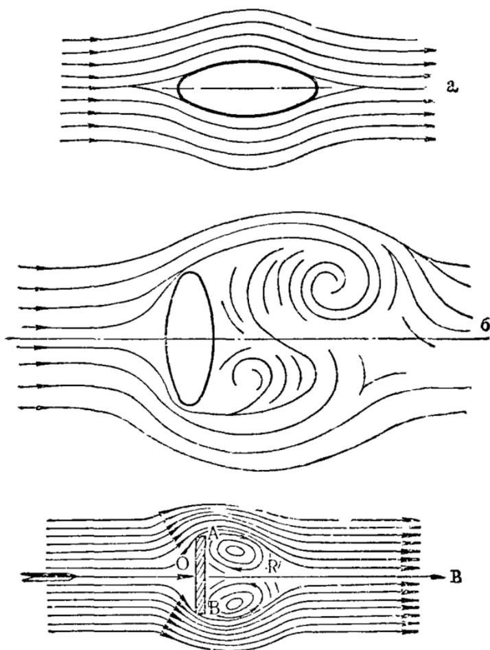
Рис. 21. Образование вихрей позади тел с различным поперечным сечением в потоке.
