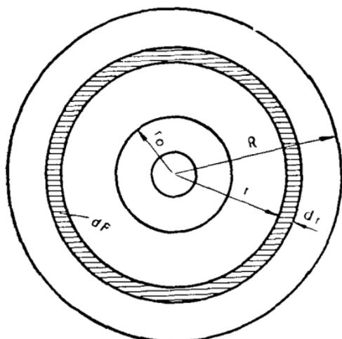
Рис. 242. Элементарная площадка рабочей поверхности жёрнова.
