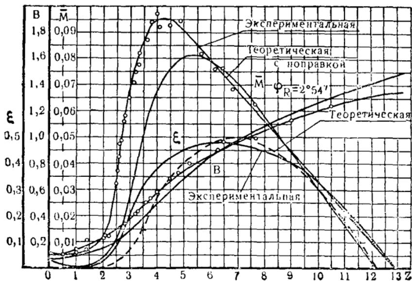
Рис. 85. Экспериментальная и теоретическая характеристика ветряка  $D=2,5$  м;  $Z_n=7$ ;  $i=3$ .
