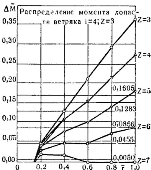
Рис. 61. Изменение отвлеченных моментов вдоль лопасти в зависимости от  $Z$ .
