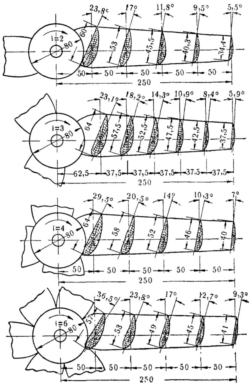
Рис. 80. Модели ветроколёс с различным числом лопастей.
