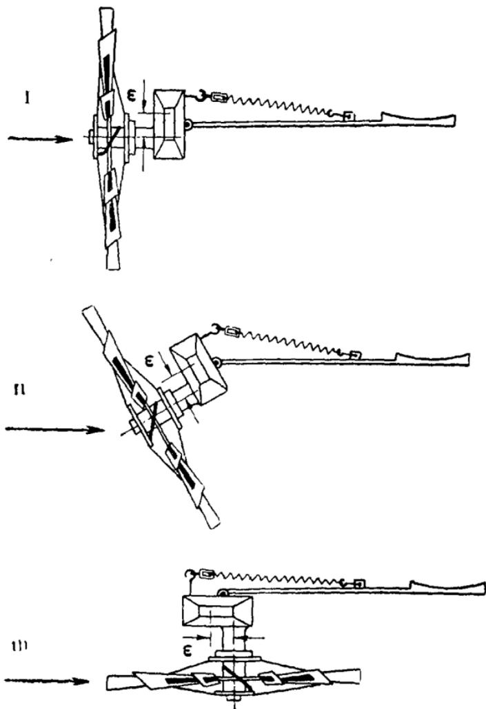
Рис. 118. Схема регулирования выводом ветроколеса из-под ветра за счёт смещения оси ветроколеса относительно оси башни.
