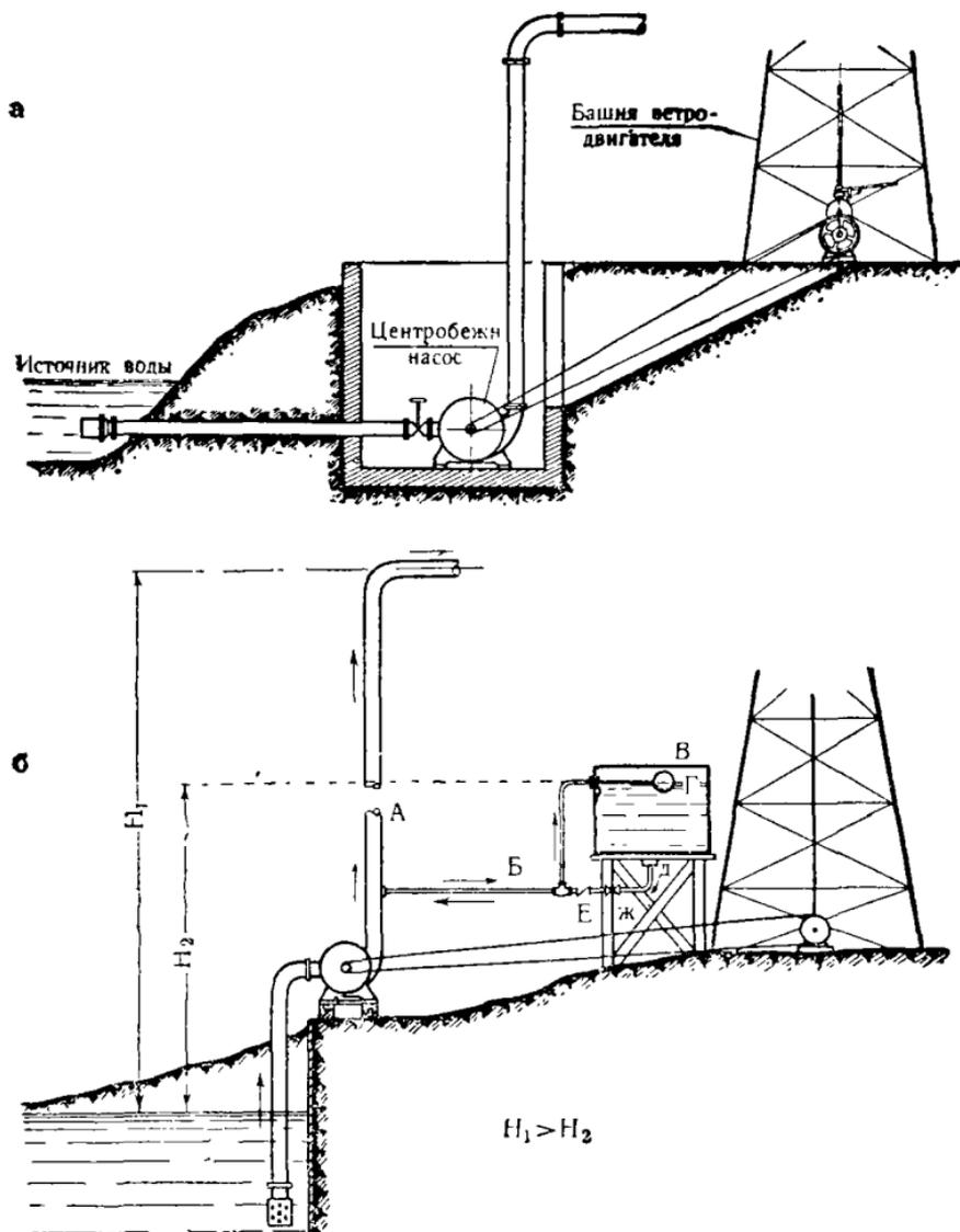
Рис. 240. а) Схема расположения насоса ниже уровня источника воды. б) Схема автоматической заливки центробежного насоса.
