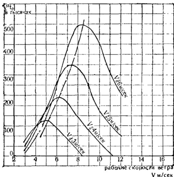
Рис. 238. График для определения оптимальной скорости ветра.
