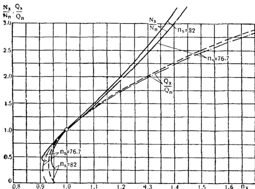
Рис. 229. Безразмерные характеристики  $\frac{N_x}{N_n}$  и  $\frac{Q_x}{Q_n}$  в зависимости от  $\frac{n_x}{n_n}$  для насосов с разными быстроходностями.
