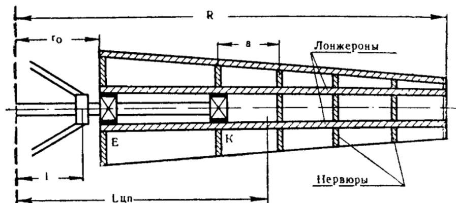
Рис. 175. Схема двухлонжеронного крыла.
