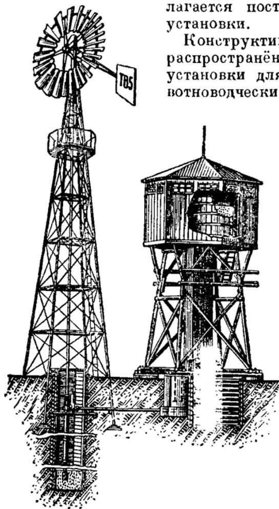
Рис. 255. Конструктивная схема ветронасосной установки.
