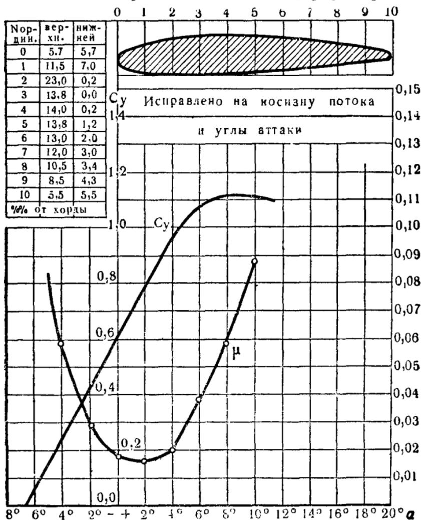
Рис. 59. Кривые для определения  $C_y$  и  $\mu$  в зависимости от  $\alpha$ .
