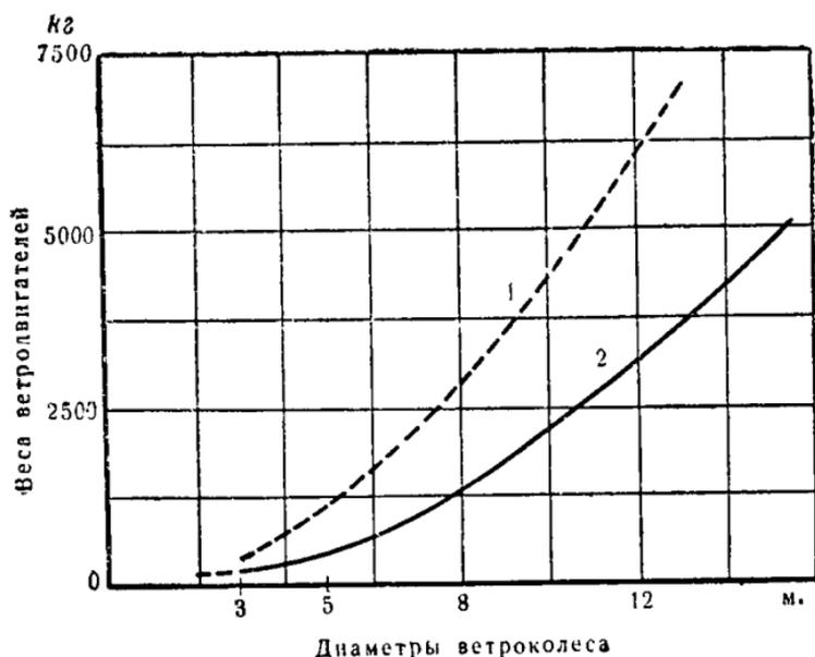
Рис. 168. Кривые веса ветродвигателей без бапп: 1 — вес тихоходных ветродвигателей; 2 — вес быстроходных ветродвигателей.
