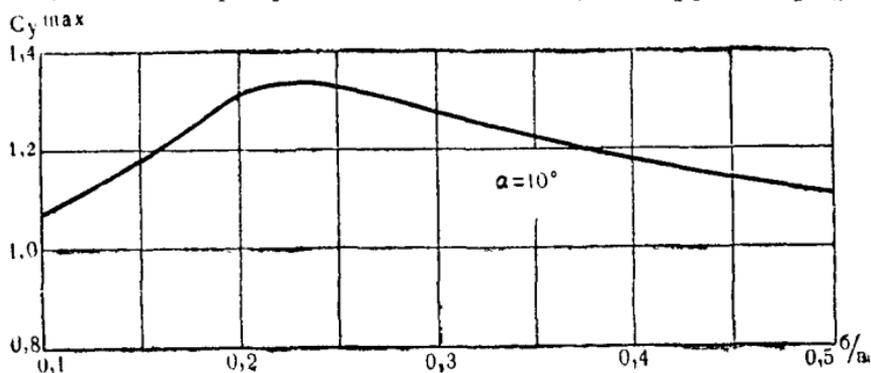
Рис. 171. График  $C_y$  в зависимости от  $\frac{\delta}{\epsilon}$  для профилей «Эсперо»
