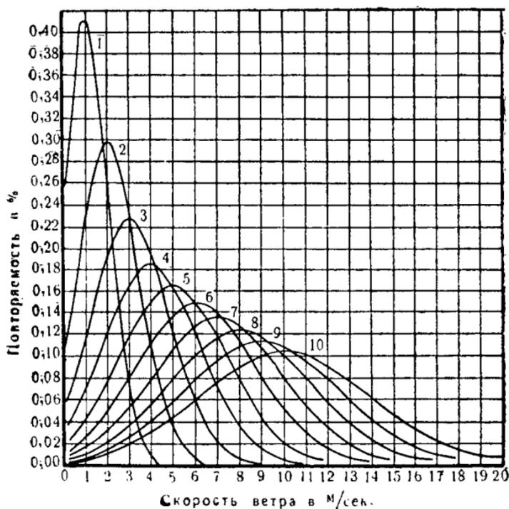
Рис. 207. Кривые повторяемости ветров по М. Поморцеву.
