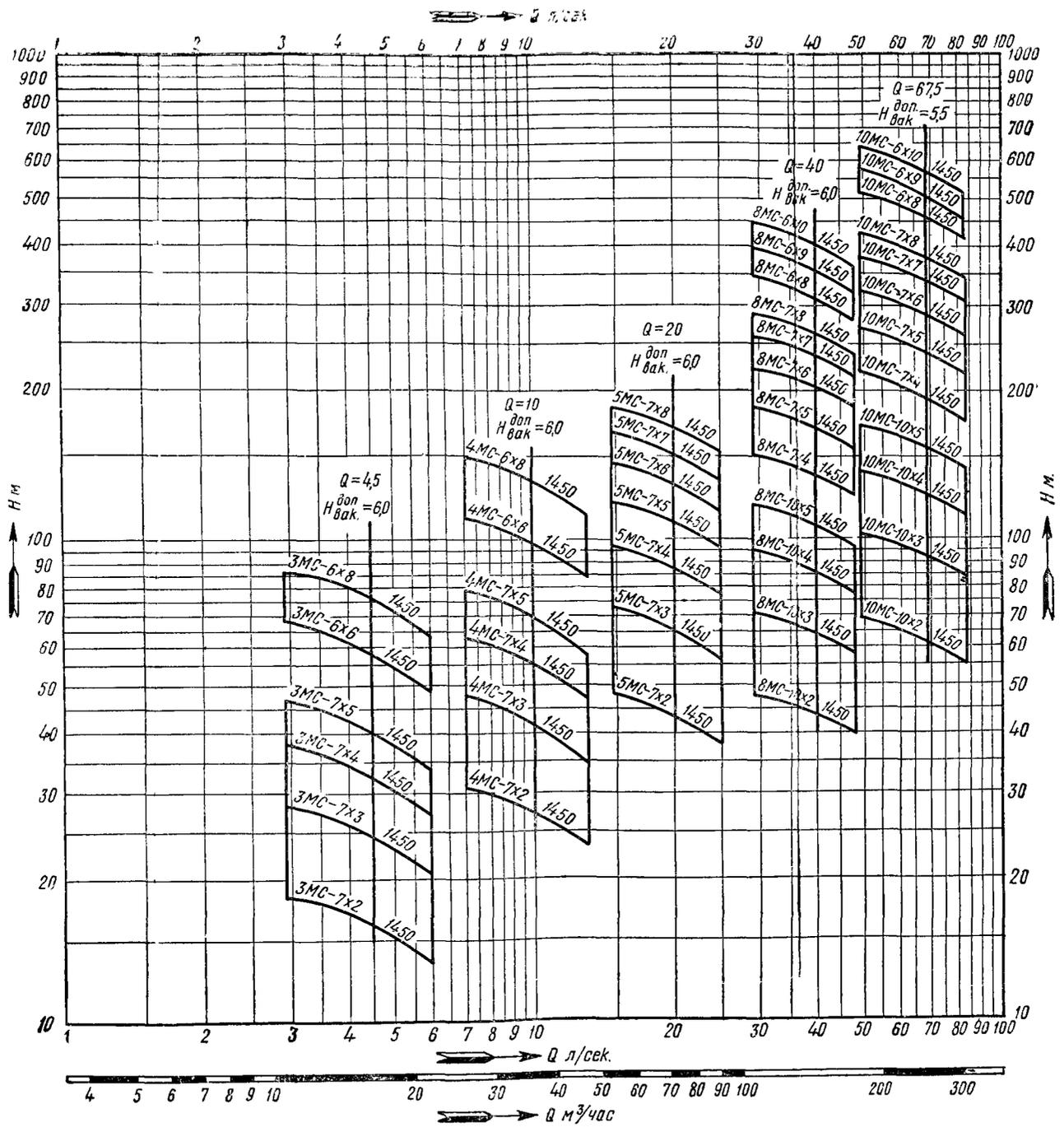
Рис. 2396. График для определения характеристик центробежных насосов типа «МС».
