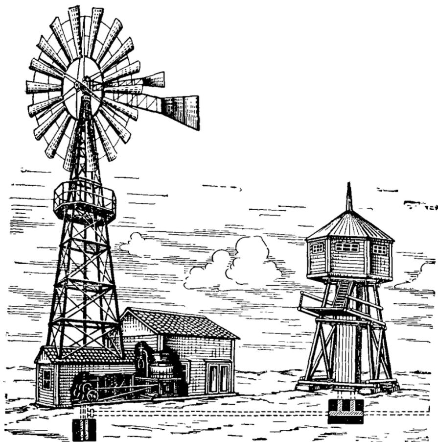
Рис. 266. Ветроустановка ТВ-8 для водоснабжения и помола.
