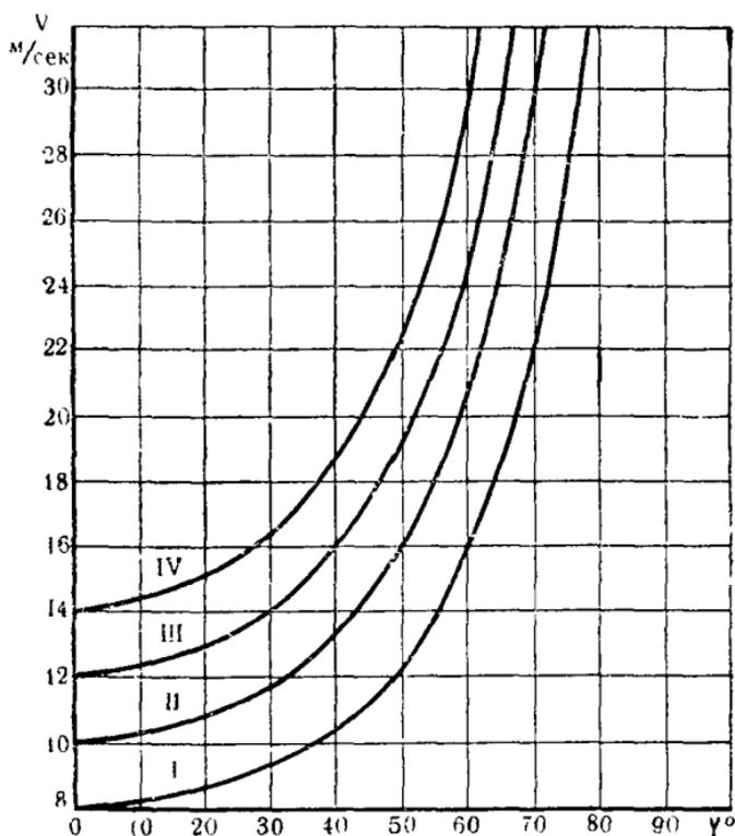
Рис. 125. Кривые изменения углов в зависимости от скорости ветра, при которых должны быть  $N = \text{Const}$  и  $\omega = \text{Const}$ .
