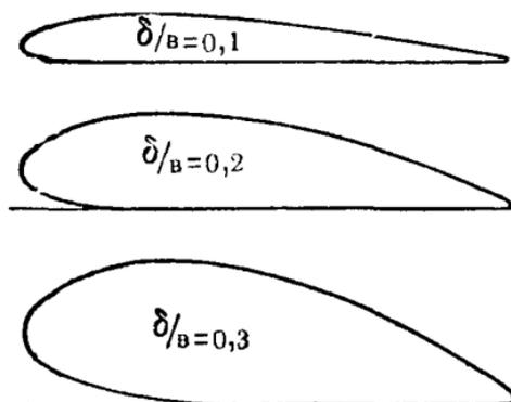
Рис. 65. Профиль «Эсперо» толщиной  $\frac{\delta}{b} = 0,1, 0,2$  и  $0,3$ .
