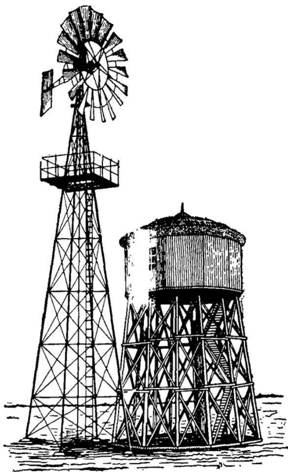
Рис. 265. Ветронасосная установка с ветродвигателем ТВ-5.
