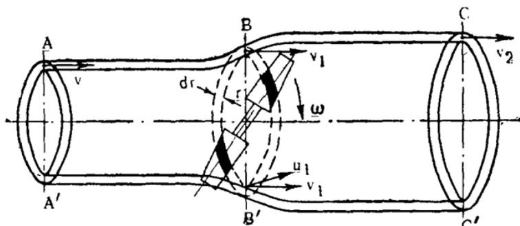
Рис. 56. Элементарная кольцевая струя.
