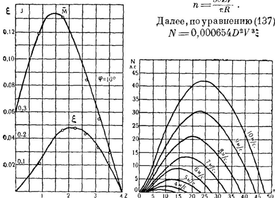
Рис. 217. Аэродинамическая и рабочая характеристика ветродвигателя ВИМЭ Д-16.
