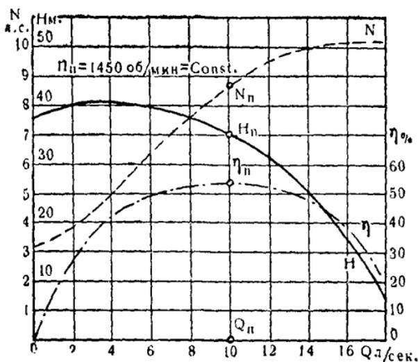
Рис. 224. Характеристика  $H-Q$  и  $N-Q$  при  $n = \text{Const}$  центробежного насоса.
