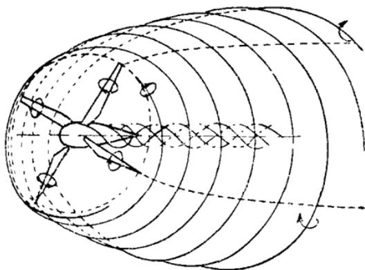
Рис. 51. Образование вихревого соленоида за ветроколесом.
