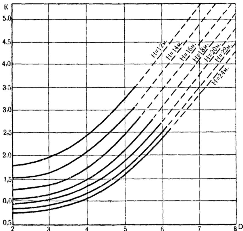
Рис. 190. График коэффициента  $K$  для определения предварительного веса башни.
