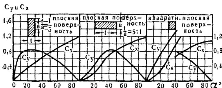
Рис. 105. Изменение коэффициентов  $C_y$  и  $C_x$  пластинок в зависимости от угла  $\alpha$ .
