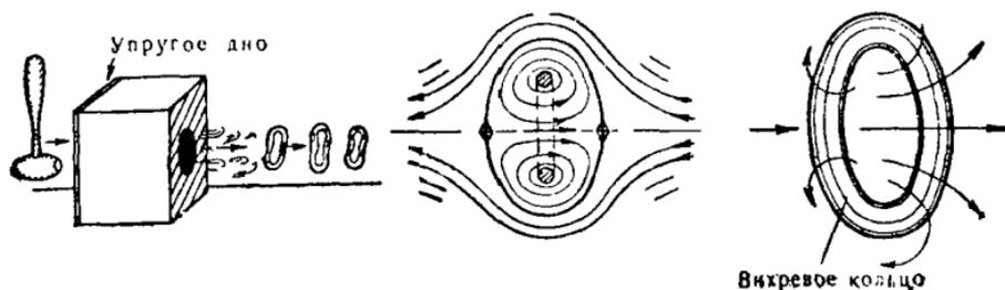
Рис. 6. Прибор для образования вихревых колец.
