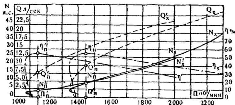
Рис. 231. Пересчитанные характеристики центробежного насоса в зависимости от  $n$  при  $H_n = 35,3 \text{ м} = \text{Const}$  и  $H = 22 \text{ м} = \text{Const}$ .
