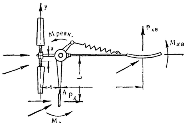
Рис. 99. Схема действия сил на ветряк, имеющий боковую лопату.
