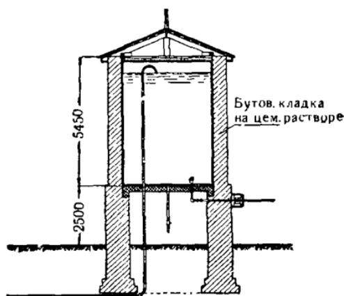
Рис. 260. Резервуар из каменной кладки.
