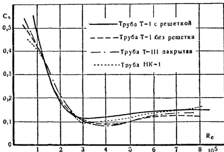
Рис. 18. Изменение коэффициента сопротивления  $C_x$  шара в зависимости от числа Рейнольдса.
