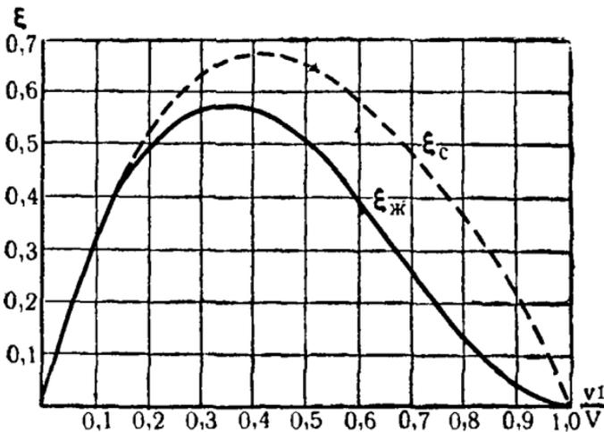
Рис. 54. Изменение коэффициента использования энергии ветра в зависимости от  $\frac{v_1}{V}$ .
