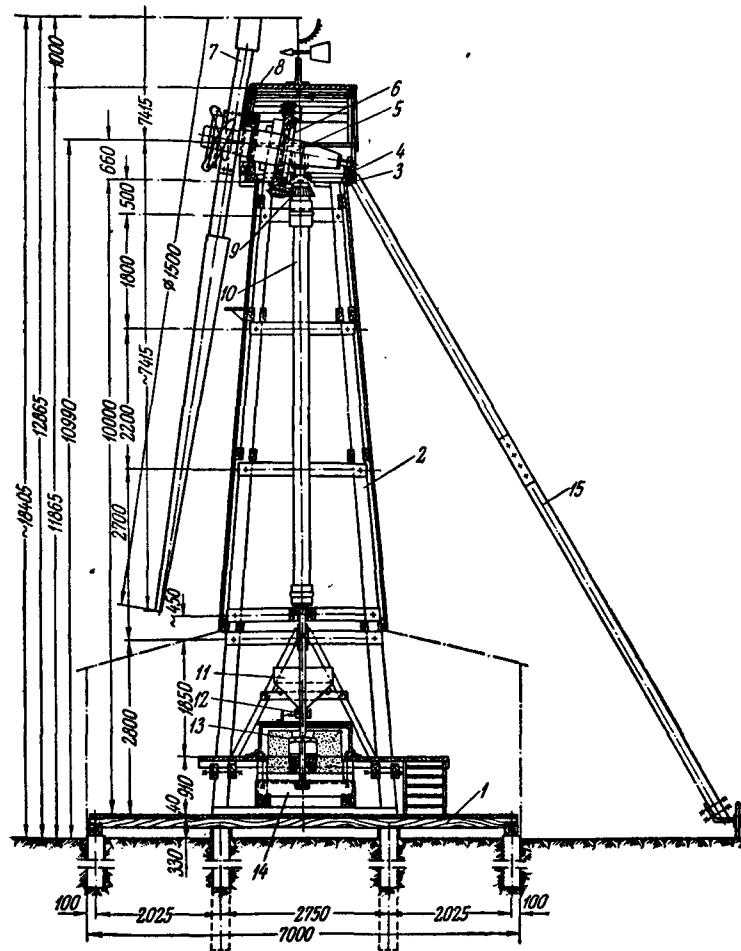
Рис. 97. Быстроходная дерево-металлическая ветряная мельница
