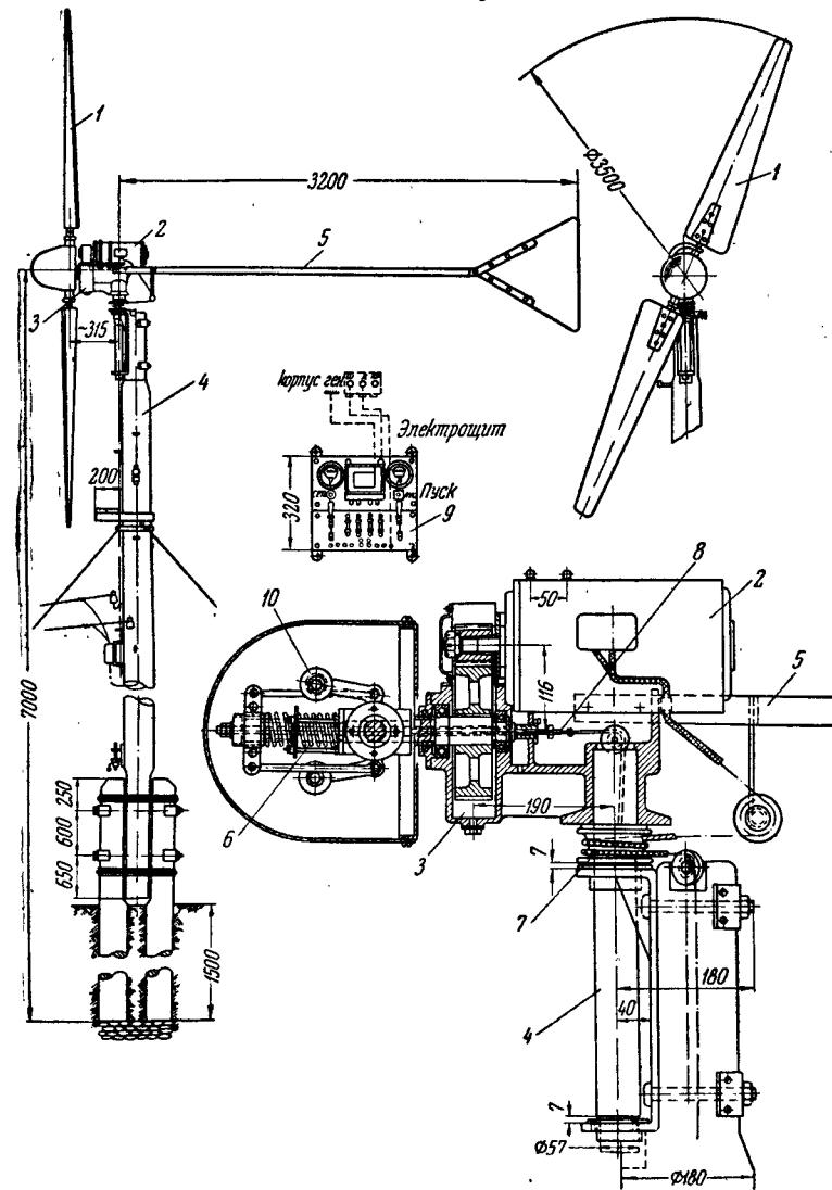
Рис. 74. Ветроэлектрический агрегат ВИМ Д-3.5:
