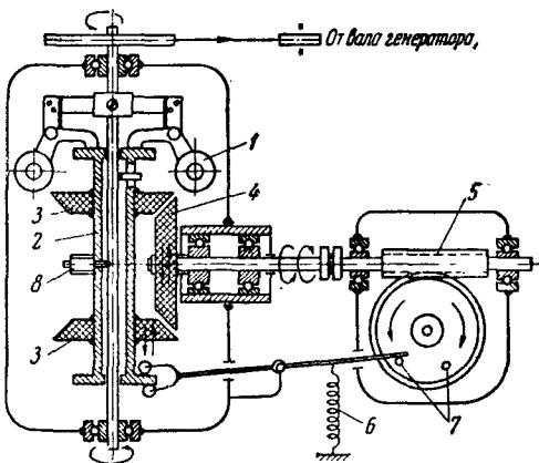
Рис. 79. Серводвигатель автоматического регулирования передаточных отношений бесступенчатой передачи:
