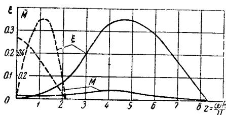
Рис. 2. Аэродинамические характеристики тихоходного 18-лопастного и быстроходного 3-лопастного ветроколес. Пунктирные линии — 18-лопастное ветроколесо, сплошные — 3-лопастное ветроколесо.
