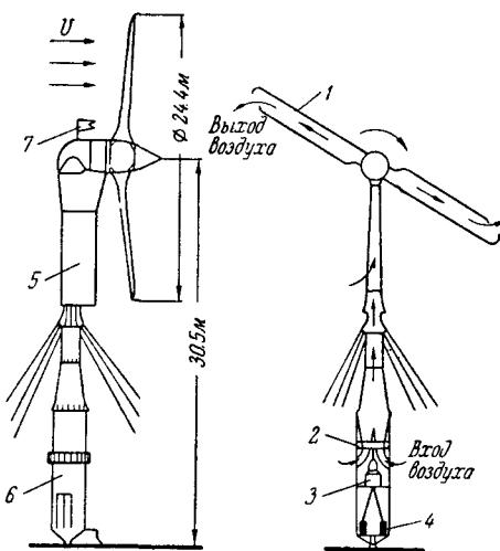
Рис. 45. Разрез ветроэлектрической установки мощностью 100 киловатт:
