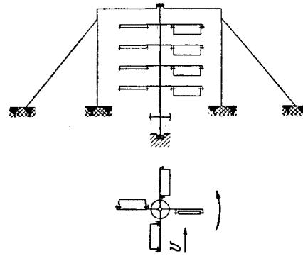
Рис. 10. Схема карусельного ветродвигателя А. В. Громова и Д. Д. Пальникова.
