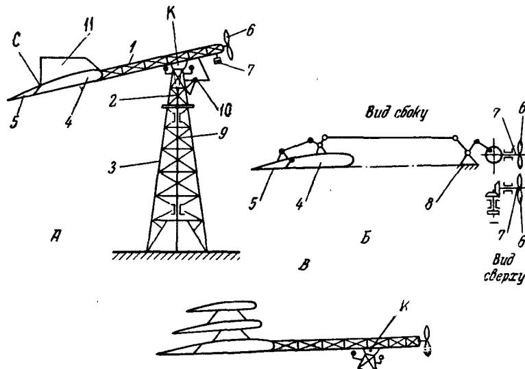
Рис. 28. Ветродвигатель с качающимся хвостом (крылом). А. Н. Конова:
