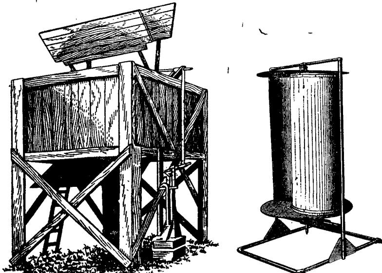
Рис. 5. Карусельный ветродвигатель.
