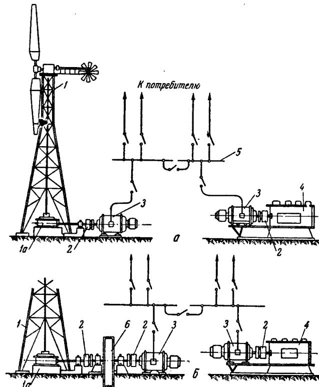
Рис. 87. Кинематическая схема ВЭС, работающей совместно с тепловой станцией равной мощности:
