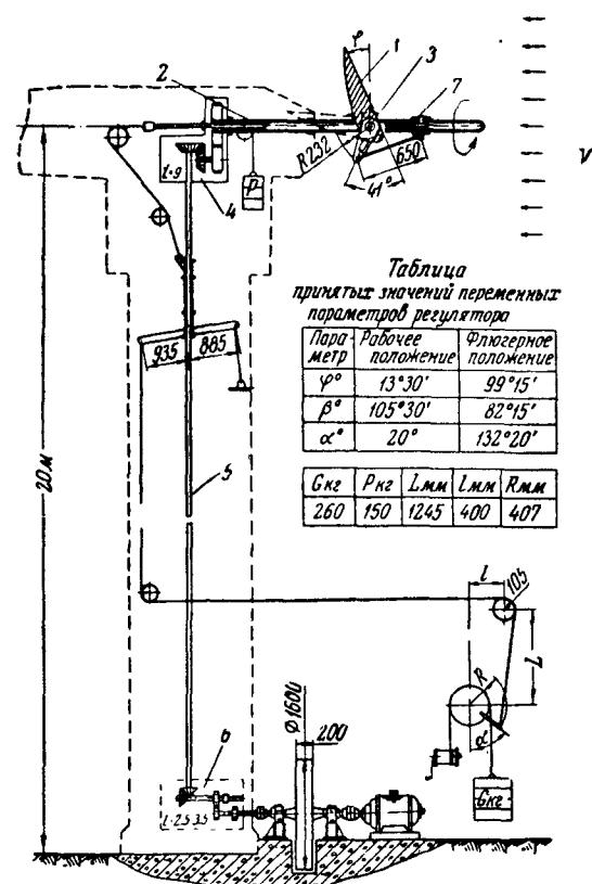
Рис. 30. Схема ветродвигателя 1Д-18 ЦАГИ
