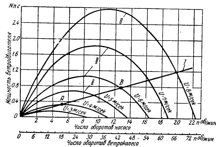
Рис. 47. Совмещенные характеристики мощности ветродвигателя ТВ-5 и поршневого насоса:
