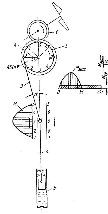
Рис. 48. Схема кривошинного механизма поршневого насоса и диаграмма изменения момента на валу колеса с кривошипным механизмом:
