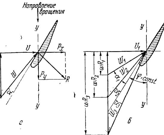
Рис. 4. Силы, возникающие на работающей лопасти:
