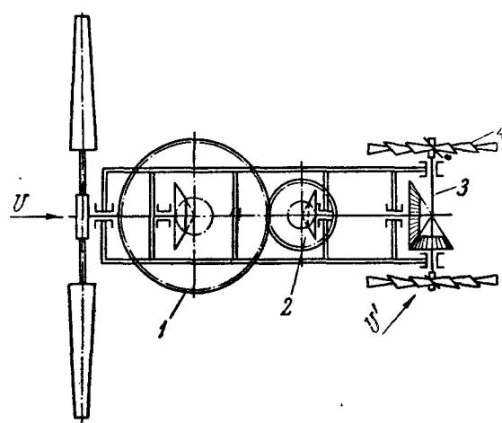
Рис. 24. Виндрозное устройство для поворота ветроколеса на ветер:
