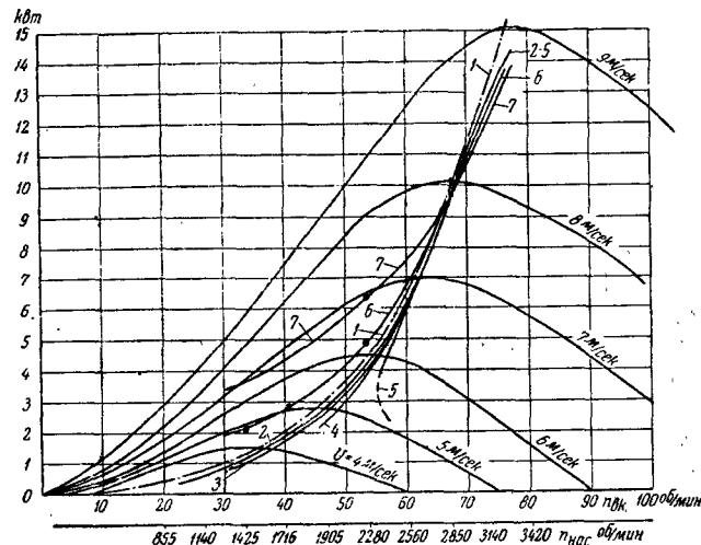
Рис. 64. Совмещенные характеристики мощности ветродвигателя, центробежного и вихревого насосов:
