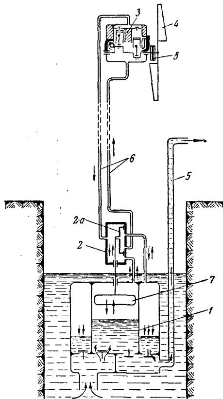
Рис. 69а. Ветрокомпрессорная установка системы В. В. Савотина.
