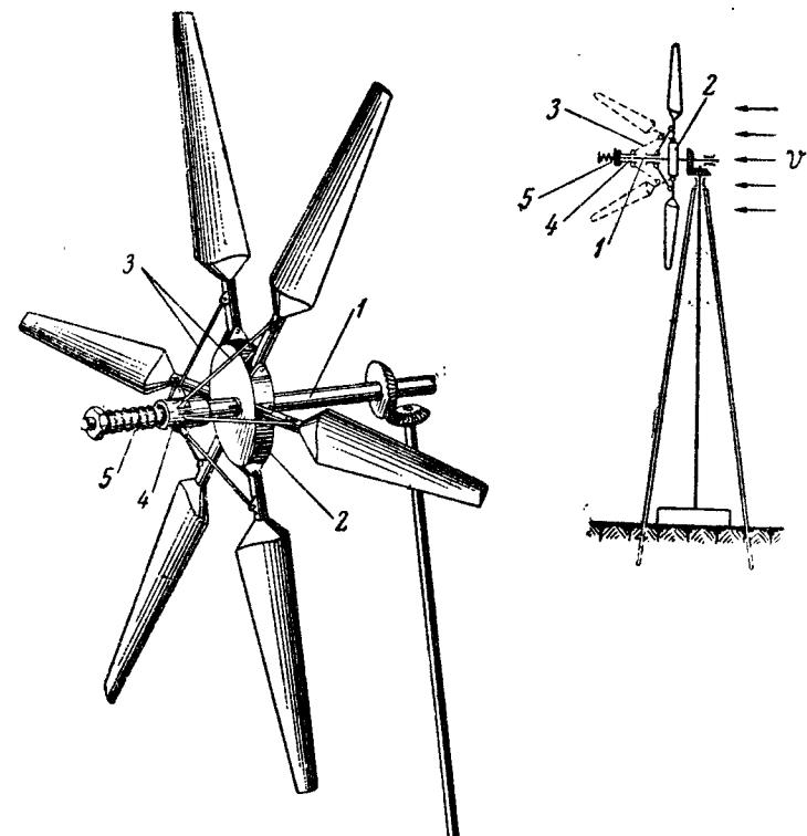
Рис. 38. Ветродвигатель с зонтичным регулированием:
