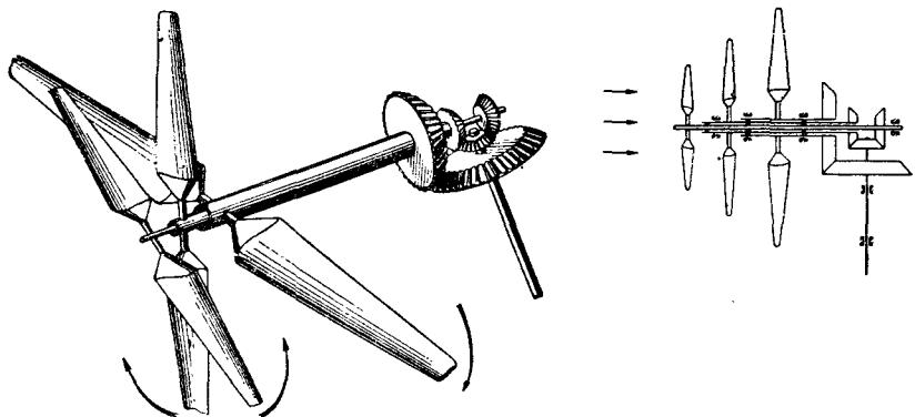
Рис. 25. Схема головки ветродвигателя с тремя соосными ветроколесами.
