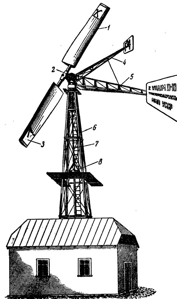
Рис. 59. Ветродвигатель 2 УНДИМ Д-10 с автоматической центробежной муфтой:
