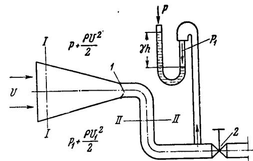
Рис. 93. Предложение И. И. Величко по аккумулированию энергии ветра: 1 — обратный клапан, 2 — вентиль.
