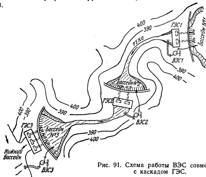
Рис. 91. Схема работы ВЭС совместно с каскадом ГЭС.
