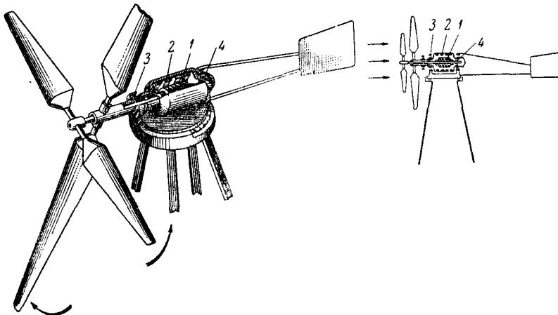
Рис. 26. Схема ветроэлектрического агрегата П. В. Пылкова
