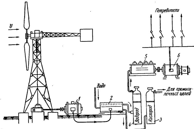
Рис. 96. Водородное аккумулирование А. Г. Уфимцева:
