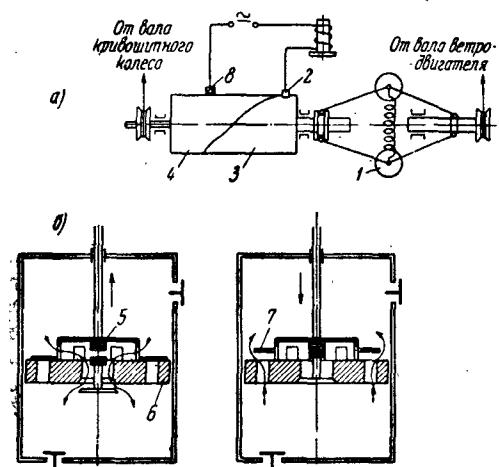
Рис. 63а, 63 б. Механизм В. И. Гранина для наилучшей загрузки ветродвигателя:
