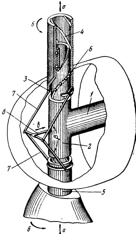
Рис. 32. Регулирование быстроходных ветродвигателей (автор Ю. А. Волков):
