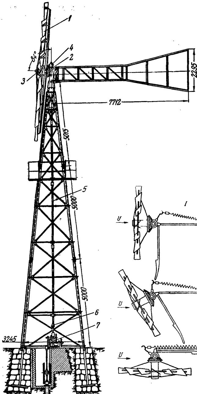
Рис. 41. Ветродвигатель ТВ-8:
