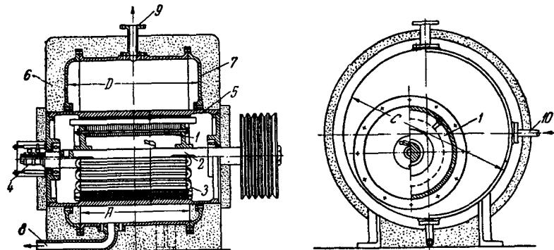
Рис. 94. Электровихревой котел Протопопова:
