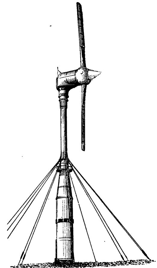
Рис. 44. Ветроустановка с пневматической связью между ветроколесом и генератором
