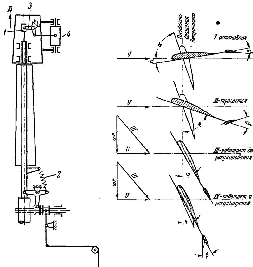
Рис. 22. Схема центробежного регулятора стабилизаторного ветродвигателя:
