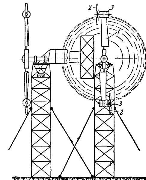
Рис. 27. Схема ветродвигателя с аэродинамической передачей, предложенная А. Г. Уфимцевым:
