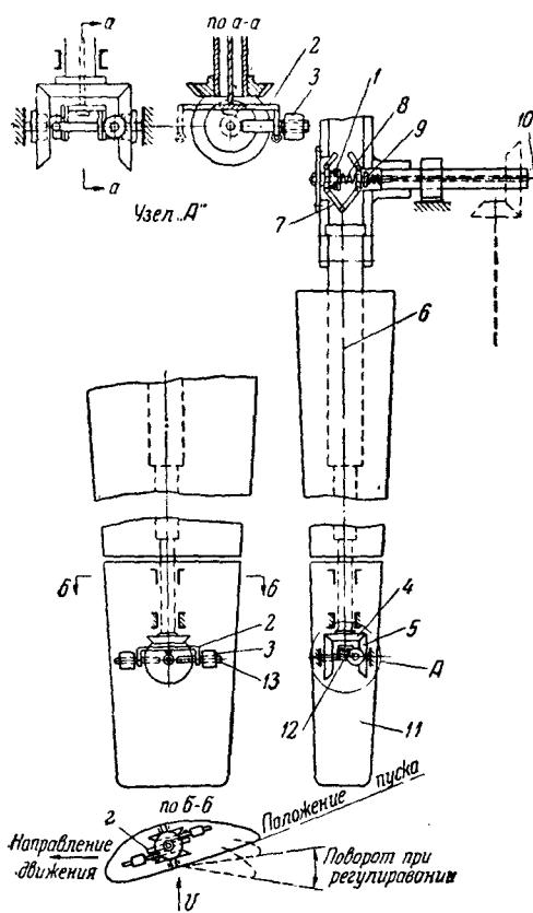
Рис. 33. Регулирование поворотом конца лопасти за счет центробежных сил:
