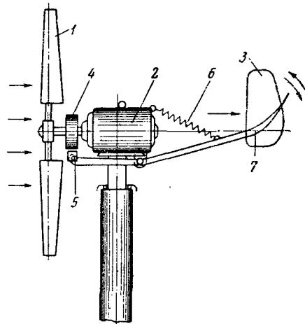
Рис. 35. Схема ветроэлектрического агрегата Д. Д. Жарикова:
