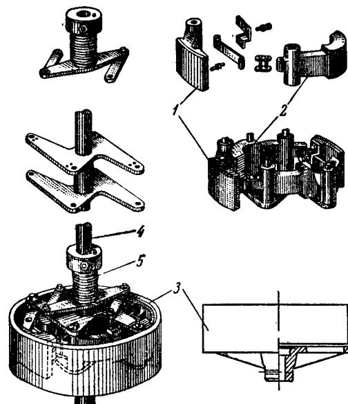
Рис. 60. Центробежная муфта конструкции С. Б. Перли:
