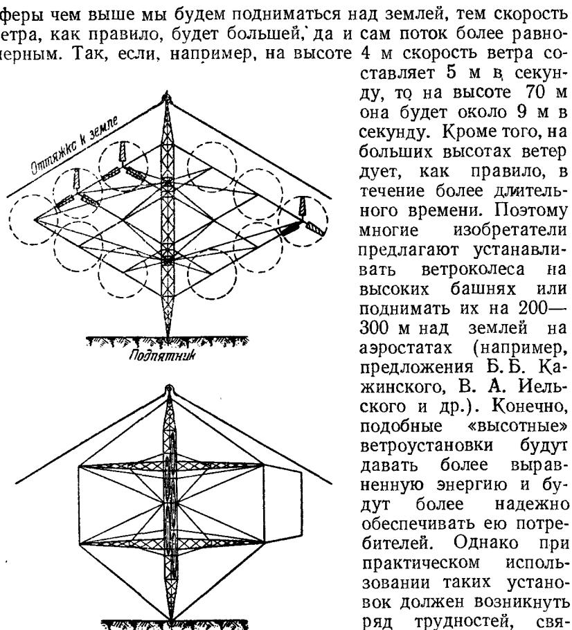
Рис. 29. Схема многоветряковой рамной ветроэлектростанции А. Г. Уфимцева.
