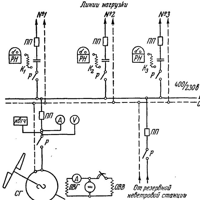
Рис. 80. Электрическая схема ступенчатой загрузки ВЭС:
