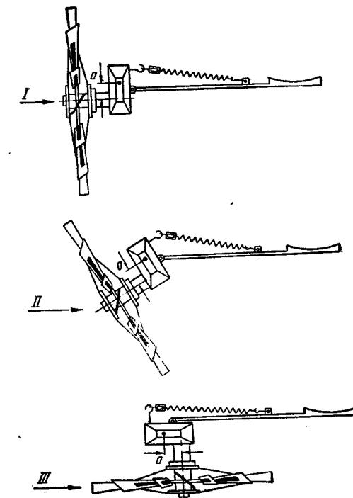
Рис. 40. Схема регулирования за счет эксцентрикитета.
