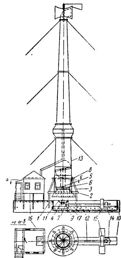
Рис. 19. Воздушная турбина Г. П. Дроздова:
