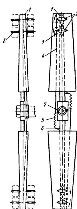
Рис. 31. Ветроколесо с воздушными тормозами:
