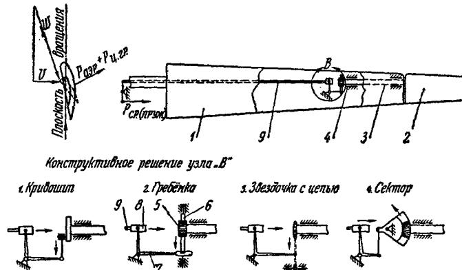
Рис. 34. Аэродинамическое регулирование ветродвигателя поворотом конца лопасти А. С. Добросердова:
