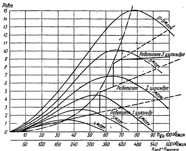
Рис. 66. Совмещенные характеристики быстроходного ветродвигателя и автоматизированного 3-цилиндрового насоса
