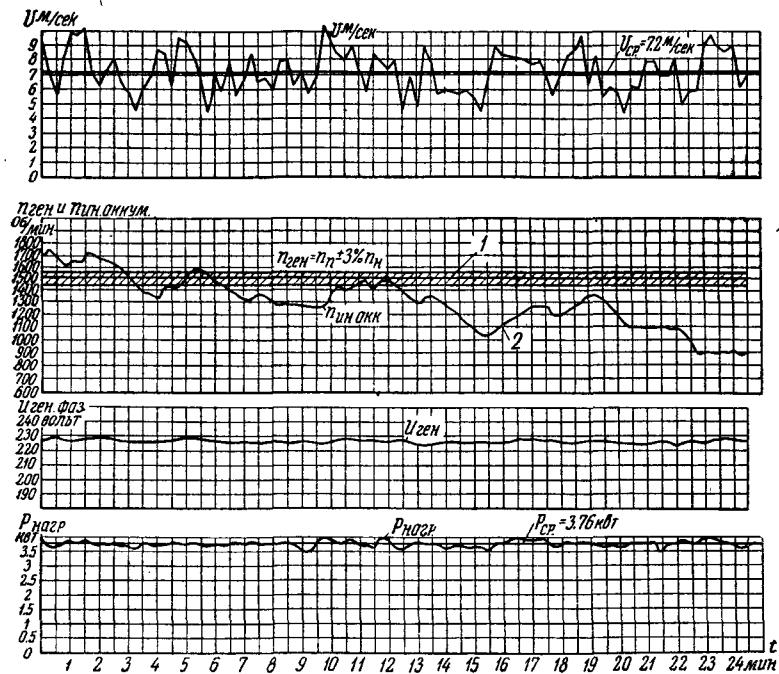
Рис. 77. Эксплуатационная характеристика полуавтоматической Курской ВЭС с инерционным аккумулятором, бесступенчатой передачей и автоматическим регулированием числа оборотов генератора:
