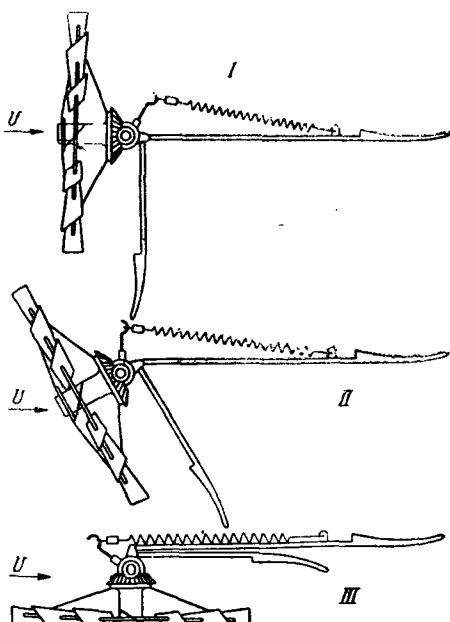
Рис. 42. Регулирование с помощью боковой лопаты.
