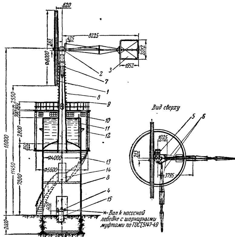
Рис. 55. Ветродвигатель на железобетонной водонапорной башне (предложение В. Ф. Баландина):
