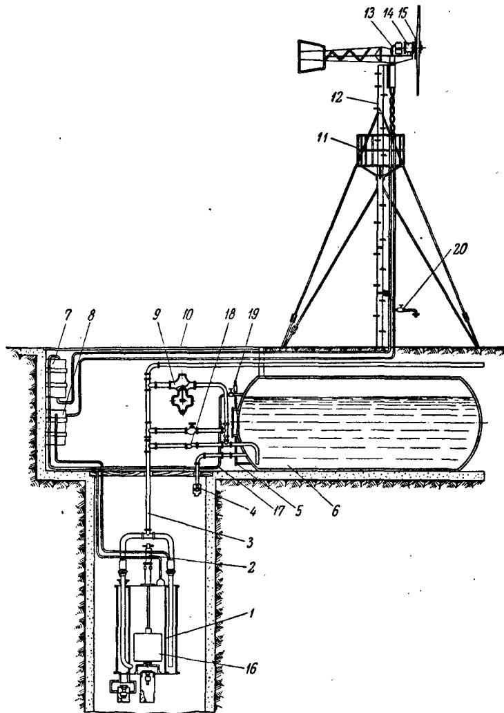
Рис. 71. Ветронасосная установка ВНИИМЭС с безбашенной водокачкой:
