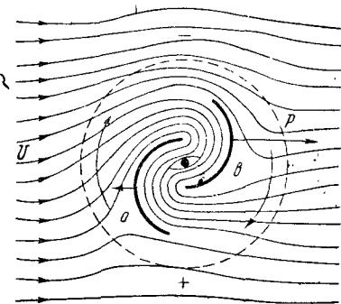
Рис. 14. Как работает роторный ветродвигатель.
