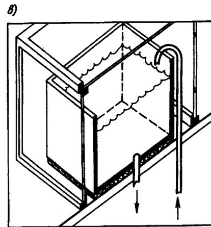
окрашивают в черный цвет. Затем с северной стороны, откуда не поступают солнечные лучи, устраивают теплоизоляцию из пенопласта толщиной 5—8 см. С помощью реек и полиэтиленовой пленки или строительного стекла аналогично предыдущему способу делают прозрачную защиту, позволяющую лучше нагреть воду.
