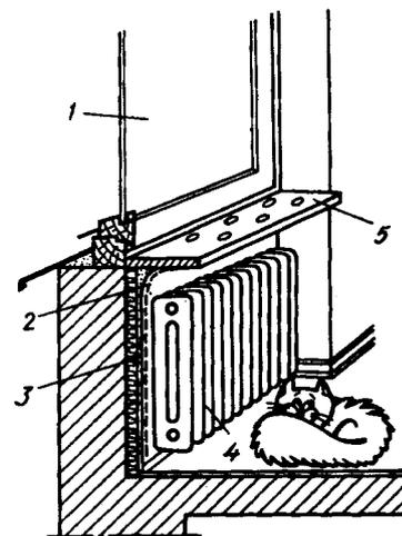
Рис. 6.33. Утепление радиаторной стенки с установкой отражающего экрана из алюминиевой фольги и обдув стекла поднимающимся от радиатора теплым воздухом через отверстия в подоконнике
