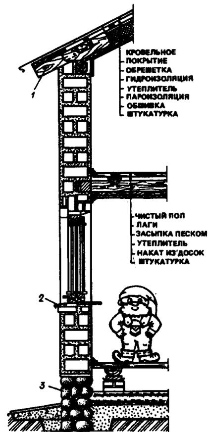
Рис. 5.21. Стены из блоков
