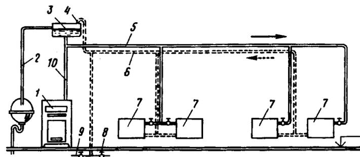
Рис. 9.11. Водяное отопление с прокладкой горячей и обратной линии под потолком
