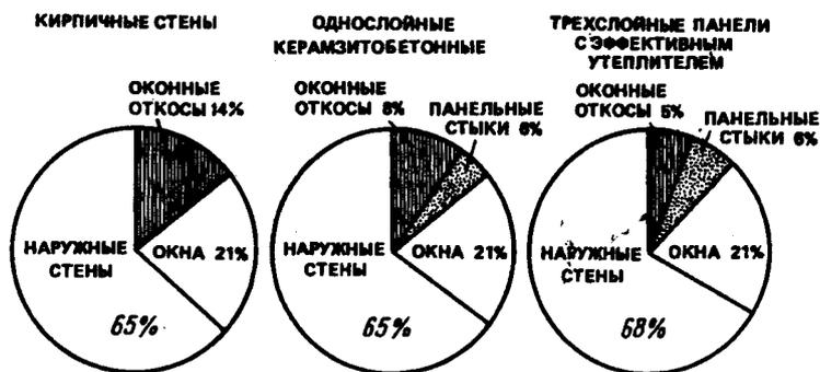
Рис. 2.12. Площади различных элементов наружных ограждений и теплопотери
