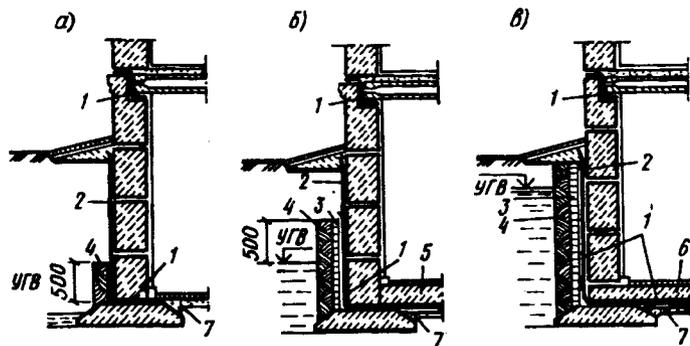
Рис. 8.16. Гидроизоляция подвалов
