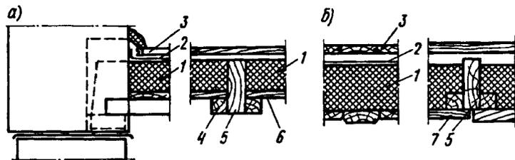
Рис. 8.9. Цокольное перекрытие с черным полом, уложенным по черепным брускам (а) и с черным полом, подшитым снизу балками (б)
