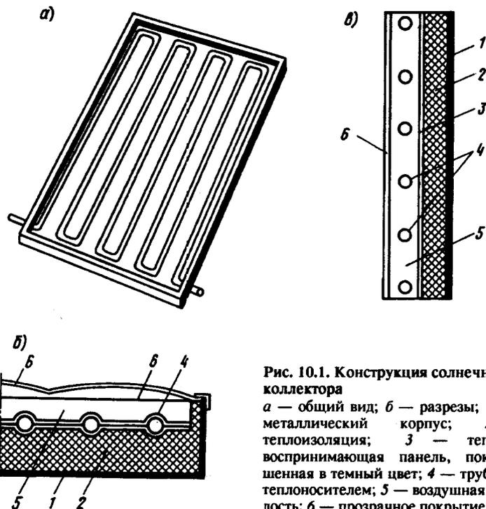
Рис. 10.1. Конструкция солнечного коллектора
