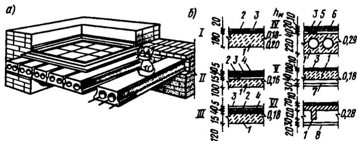
Рис. 8.4. Конструкция плитного перекрытия
