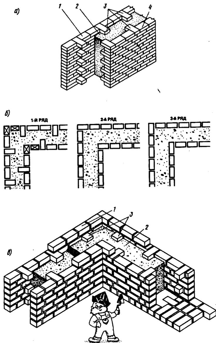
Рис. 5.15. Бетонно-анкерная кладка
