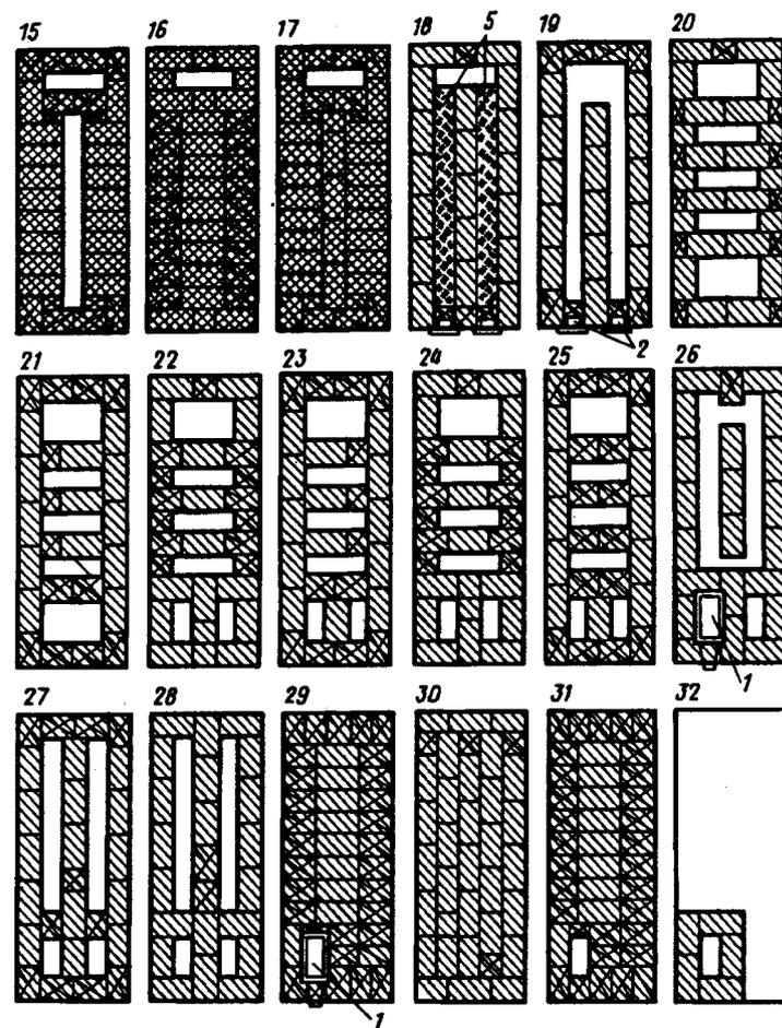
Рис. 9.7. Отопительная печь с теплоотдачей 4650 Вт
