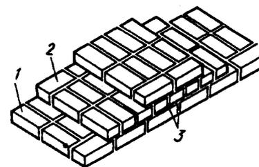
Рис. 5.8. Двухрядная система кладки
