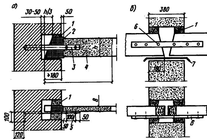
Рис. 8.23. Опирание деревянных балок на каменные стены
