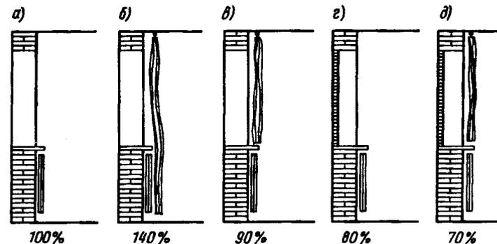
Рис. 6.24. Влияние зашторивания и экранирования окон на теплопотери, %
