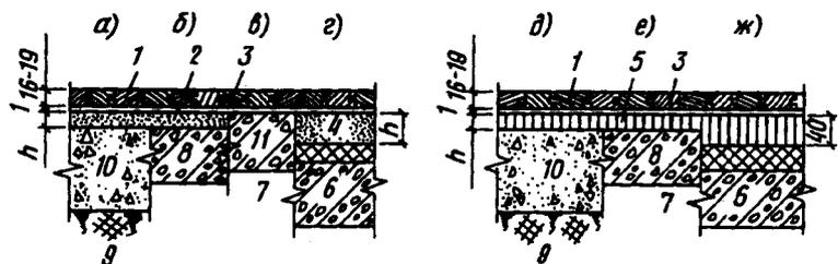
**Рис. 8.29. Конструкции полов из штучного и наборного паркета**
