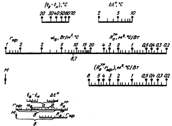
Рис. 11.1. Номограмма для определения требуемого сопротивления теплопередаче
