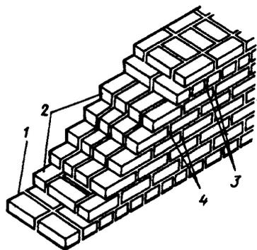
Рис. 5.9. Шестирядная система кладки
