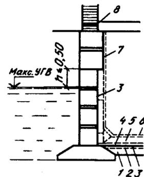
Рис. 8.17. Гидроизоляция подвала при больших напорах грунтовых вод, устраиваемая по внутренней поверхности стен
