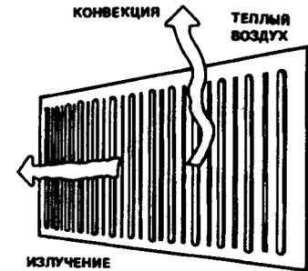
Рис. 9.13. Конвективная и лучистая теплоотдачи отопительного прибора
