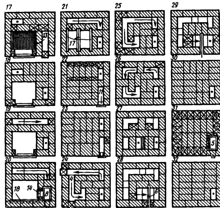
Рис. 9.8. Отопительно-варочная печь типа "шведка"
