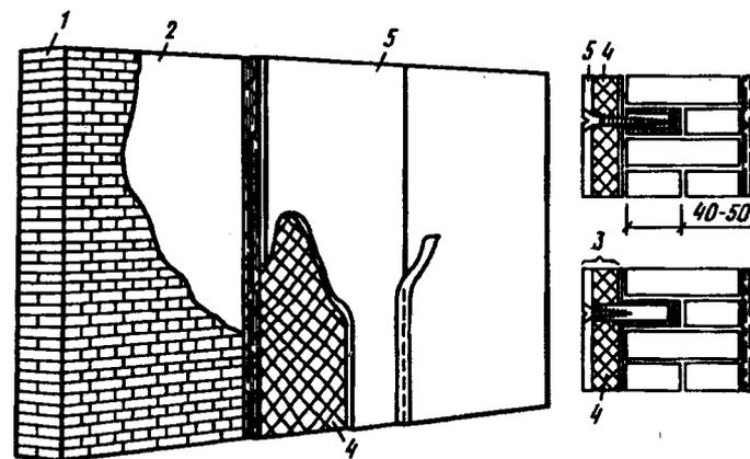
Рис. 5.32. Двухслойные плиты для утепления стен с наружной стороны
