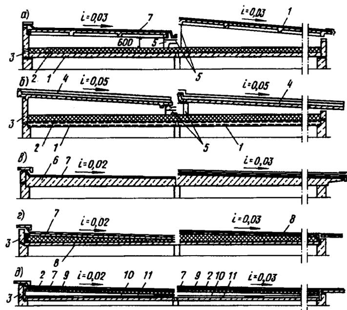
Рис. 7.5. Принципиальные схемы конструкций бесчердачных железобетонных крыш
