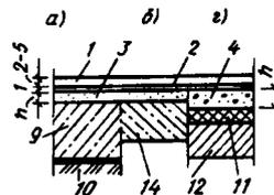
Из линолеума с теплозвукоизоляционным слоем
