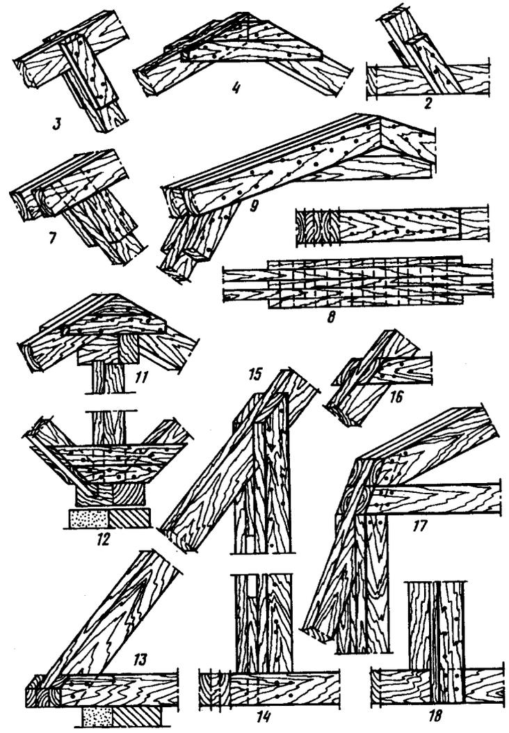
Рис. 7.13. Конструктивные схемы двухскатных дощатых крыш
