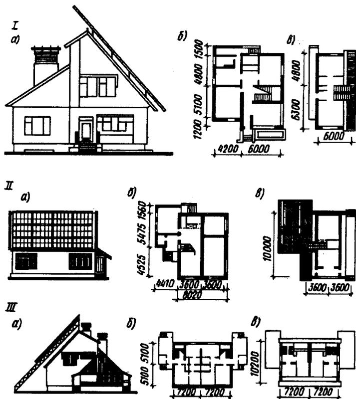
Рис. 10.2. Солнечные коллекторы на крыше мансардного одноквартирного (I) и двухквартирного домов (II, III)
