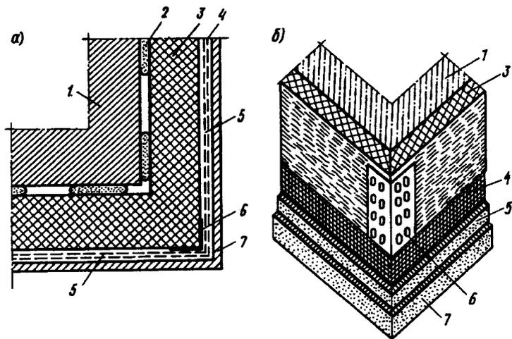
Рис. 5.34. Конструктивное решение утепления угла
