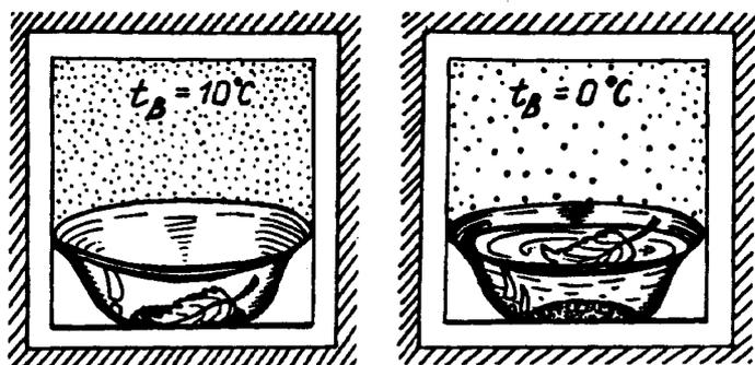
Рис. 2.14. Конденсация водяных паров при понижении температуры
