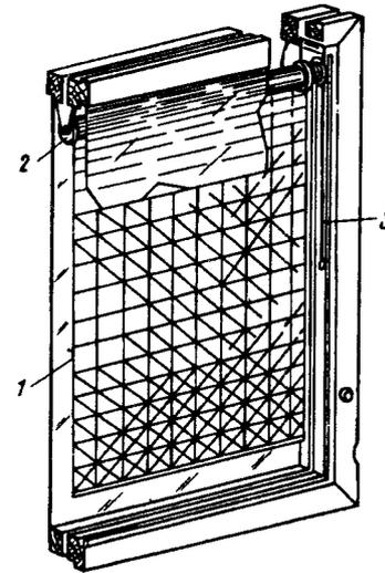
Рис. 6.28. Свертывающаяся штора
