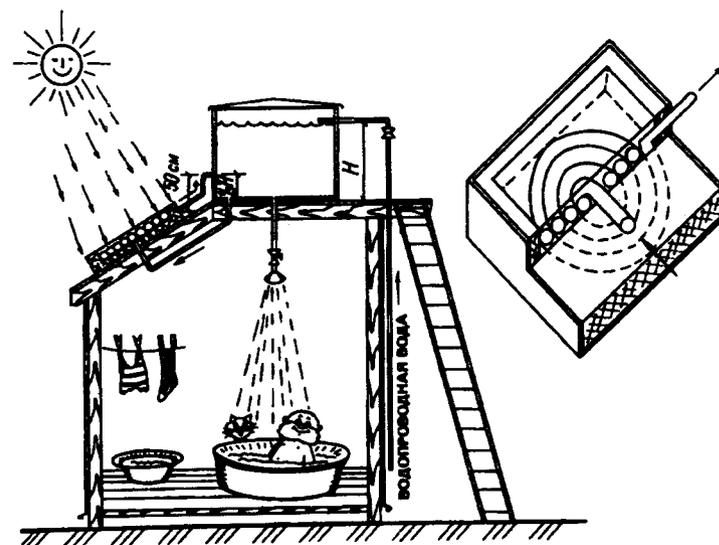
Рис. 10.5. Использование резинового шланга, свернутого кольцами, для нагрева воды
