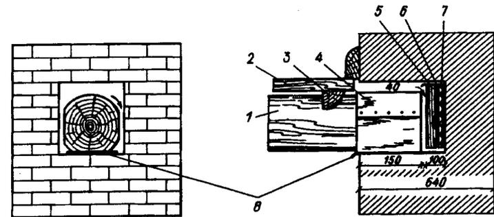
Рис. 8.25. Заделка концов балки в стену толщиной 0,64 см и более
