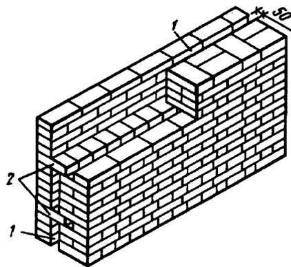
Рис. 5.16. Кладка с воздушной прослойкой
