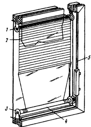
Рис. 6.29. Штора с комбинированным экраном
