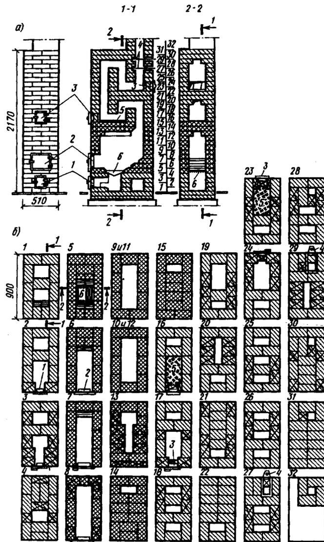
Рис. 9.6. Отопительная печь с теплоотдачей 2200 Вт
