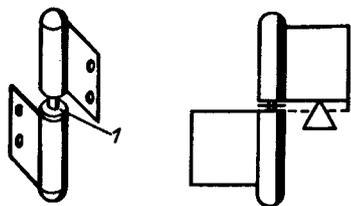
Рис. 6.18. Регулирование высоты подвески оконной рамы установкой на петле проволочного кольца
