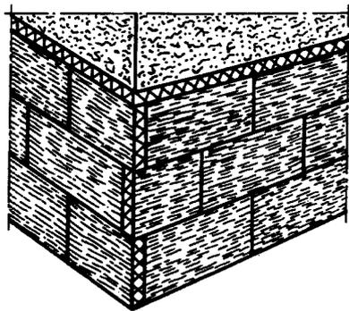
Рис. 5.33. Расположение плит утеплителя с наружной стороны угла
