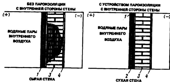
Рис. 2.18. Предохранение от увлажнения водяными парами конструкции наружной стены
