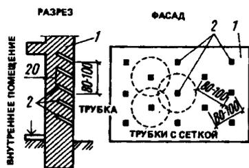
Рис. 8.36. Устройство осушающих каналов в стене с наружной стороны
