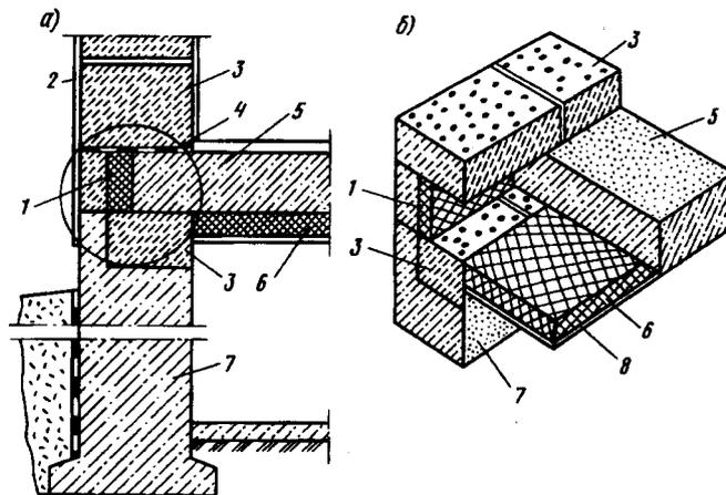
Рис. 8.43. Утепление цокольного перекрытия над подвалом
