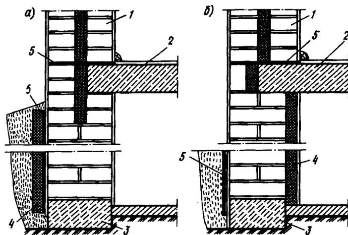
Рис. 8.38. Утепление стен подвалов пенопластом с наружной (а) и внутренней (б) стороны
