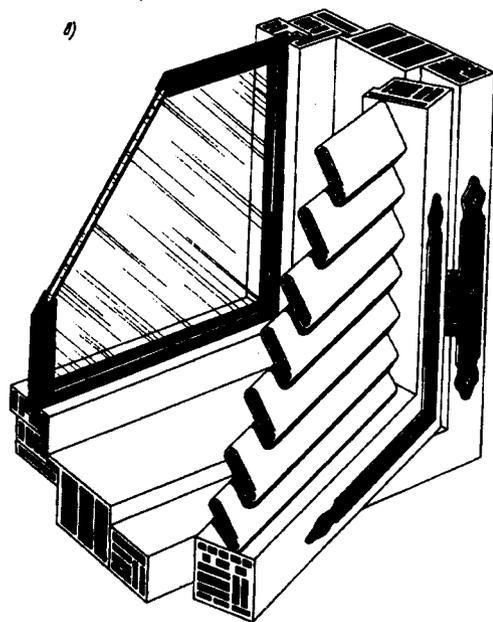
Рис. 6.23. Установка штор (а, б) и жалюзи (в) с внутренней стороны помещения
