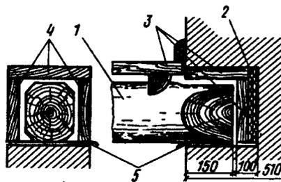
Рис. 8.24. Открытая заделка концов балки в стену толщиной 0,51 м
