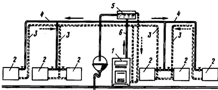
Рис. 9.12. Водяное отопление с прокладкой горячей и обратной линий под приборами
