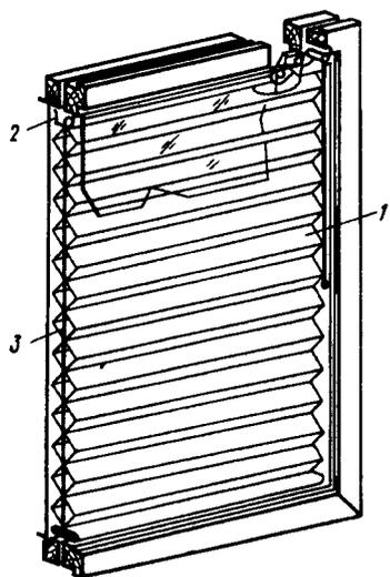
Рис. 6.30. Штора с объемным экраном
