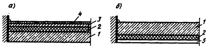
Рис. 8.40. Утепление перекрытия плитами из пенопласта
