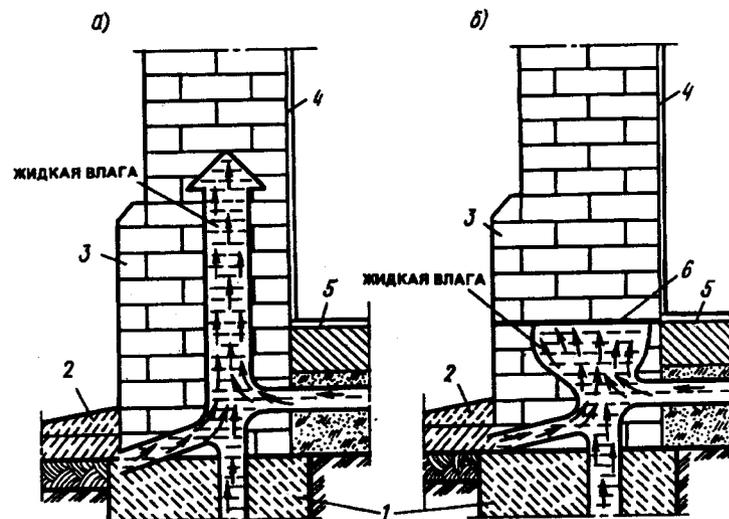
Рис. 2.21. Увлажнение конструкции цокольного узла без гидроизоляции (а) и с гидроизоляцией (б)
