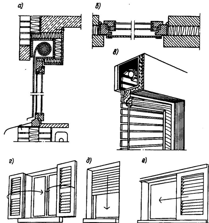
Рис. 6.22. Окна со свертывающимися экранами (а — вертикальный разрез; б — горизонтальный разрез; в — аксонометрия), закрывающимися ставнями (г); опускающимися жалюзи (д) и задвигающимися ставнями (е)
