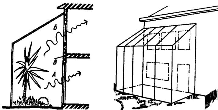
Рис. 10.8. Оранжерея высотой в два этажа около наружной стены дома
