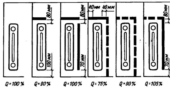
Рис. 9.15. Эффективность использования декоративных щитов около отопительных приборов
