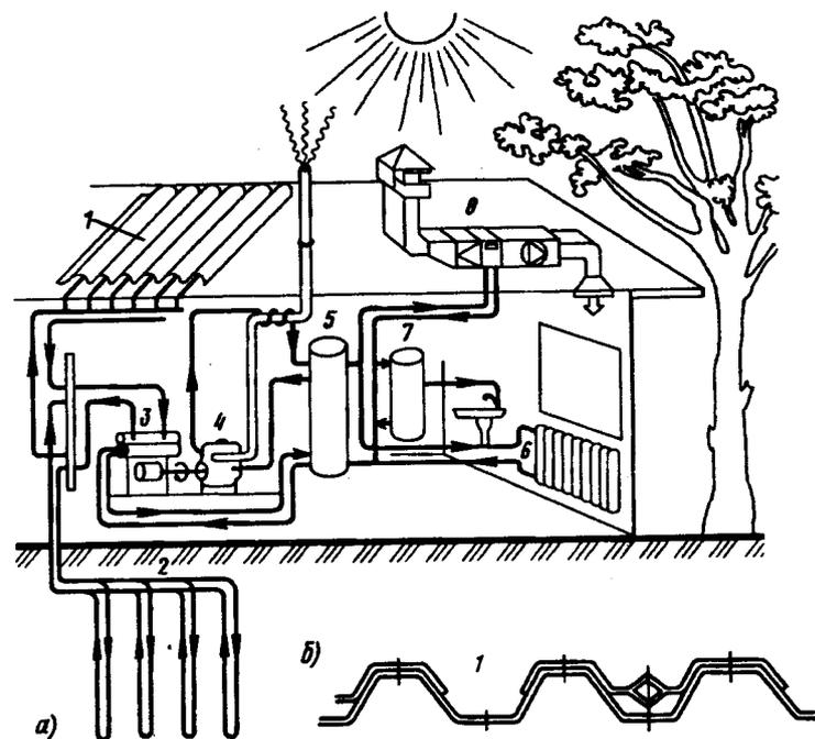
Рис. 10.11. Тепловая установка здания гимназии в Швеции г. Кунгсбака
