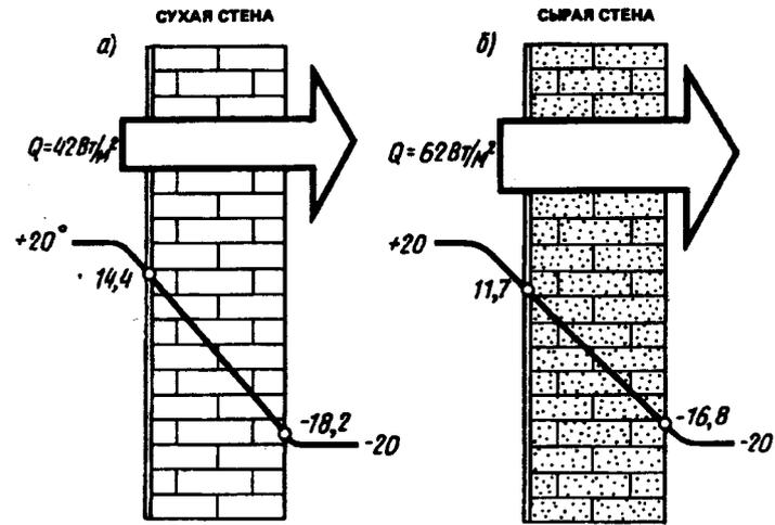
Рис. 2.5. Влияние влажности материала на теплозащитные свойства кирпичной стены
