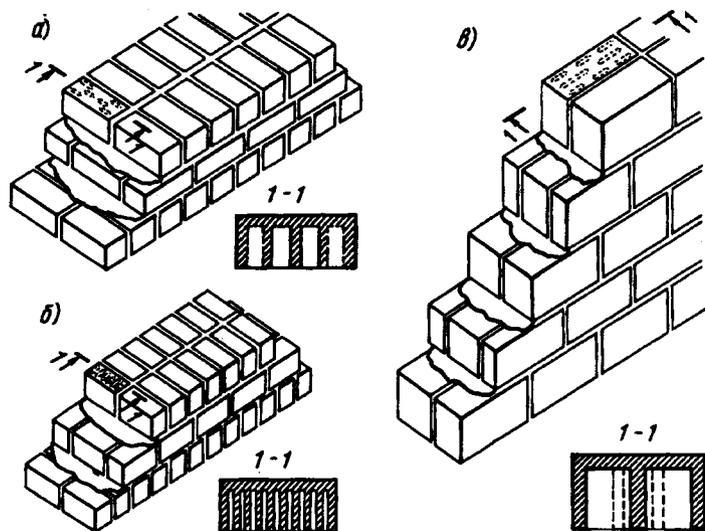
Рис. 5.11. Кладка из керамических камней (а), из утолщенного кирпича с пустотами (б), из бетонных камней
