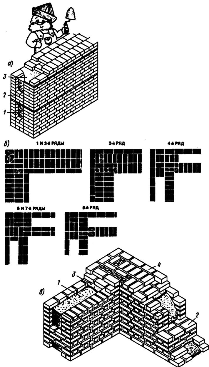
(рис. 5.14). Колодцевая кладка представляет собой две продольные кирпичные стены, соединенные друг с другом вертикальными диафрагмами. Толщину внутреннего и наружного слоев из условий прочности принимают в  $1/2$ — $1\frac{1}{2}$  кирпича, между которыми располагают утеплитель — легкий бетон, шлак или другой материал.
