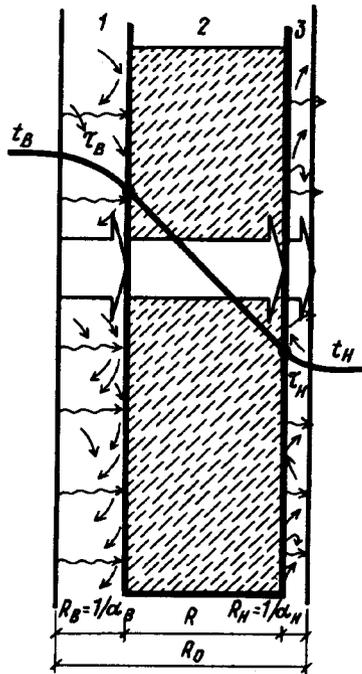
Рис. 2.6. Сопротивление теплопередаче стены
