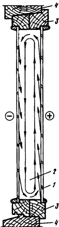
Рис. 2.2. Передача тепла конвекцией в межстекольном пространстве оконного блока со спаренным остеклением
