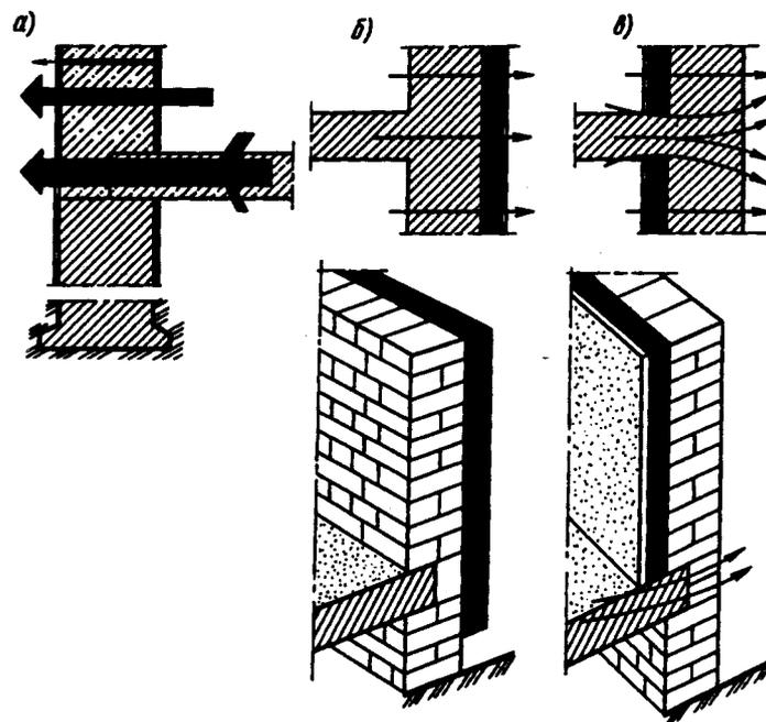
Рис. 8.41. Теплопотери, происходящие через стену и через узел сопряжения балки перекрытия со стеной
