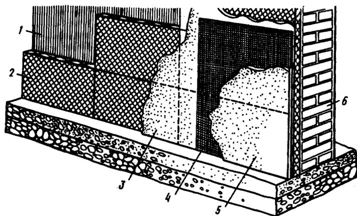
Рис. 5.30. Утепление стен по существующей штукатурке теплоизоляционными плитками
