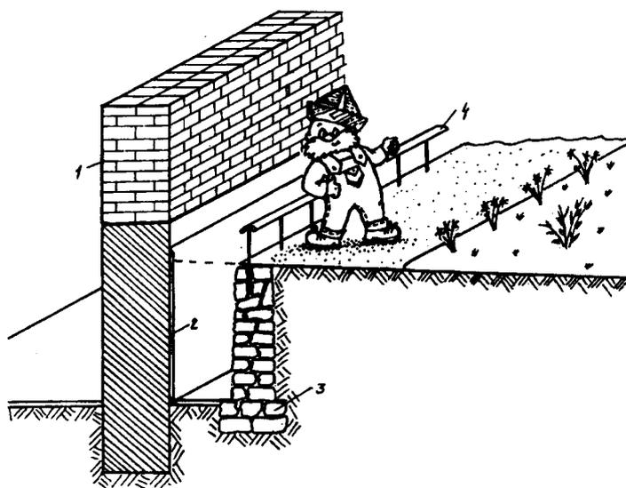
Рис. 8.32. Устройство водоотводной канавы с опорной стенкой
