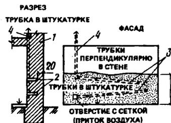
Рис. 8.37. Устройство осушающих каналов в стене с внутренней стороны
