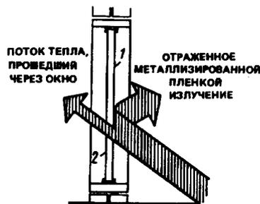
Рис. 6.21. Установка металлизированной пленки
