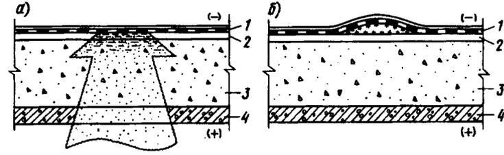
Рис. 7.4. Образование льда под кровельным ковром бесчердачного покрытия
