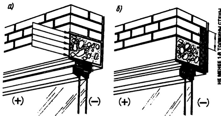
Рис. 5.36. Утепление стены над окном в зоне перемычки
