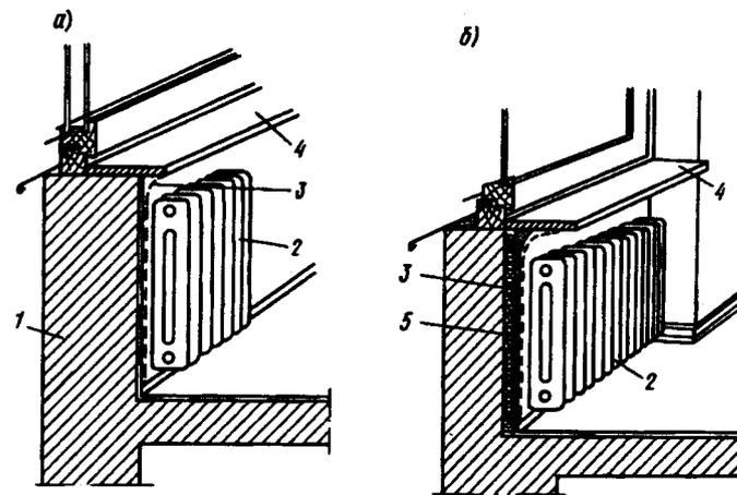
Рис. 9.14. Утепление стены за отопительным прибором путем установки блестящей алюминиевой фольги на внутренней поверхности стены (а) или установкой теплоизоляционного материала, с покрытием его алюминиевой фольгой (б)
