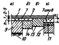
*1* — покрытие; *2* — прослойка из холодной мастики на водостойких вяжущих; *3-8* — стяжки; *9* — бетонный подстилающий слой; *10* — грунт основания; *11* — тепло- или звукоизоляционный слой; *12* — плита перекрытий; *13* — плита перекрытия с ровной поверхностью; *14* — плита перекрытия с неровной поверхностью; *а* — по грунту; *б* — по плите перекрытия с неровной (*а*) и ровной (*б*) поверхностями; *г* — с тепло- или звукоизоляционным слоем
