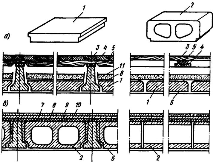
Рис. 8.26. Перекрытия по сборным железобетонным балкам с накатом из сплошных плит (а) и с заполнением двухпустотными вкладышами (б)
