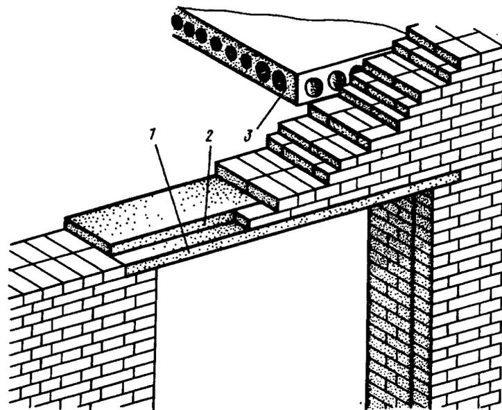
Рис. 5.35. Перекрытие проема железобетонными перемычками
