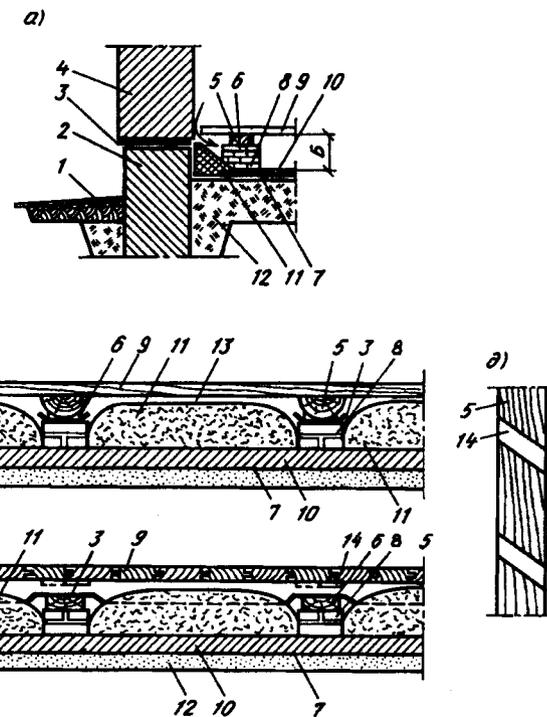
Рис. 8.13. Конструкции перекрытий над теплым подпольем
