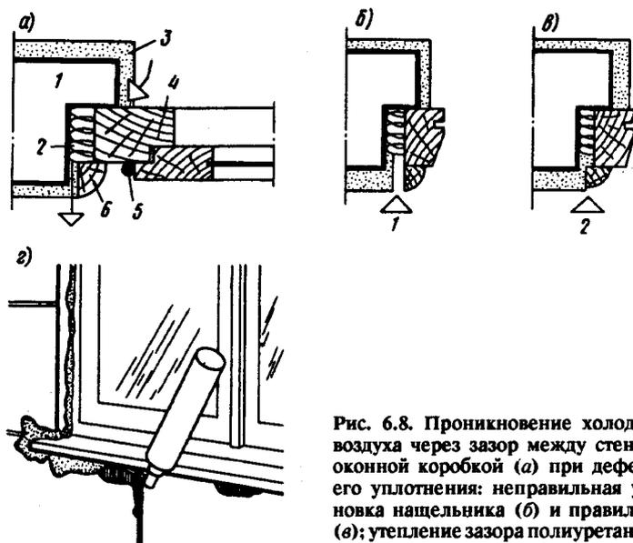
Рис. 6.8. Проникновение холодного воздуха через зазор между стеной и оконной коробкой (а) при дефектах его уплотнения: неправильная установка нащельника (б) и правильная (в); утепление зазора полиуретановой пеной (г)
