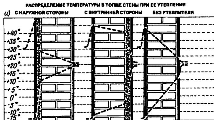
Рис. 5.22. Принципиальные схемы утепления наружных стен и распределение температуры в стене при утеплении их снаружи и изнутри
