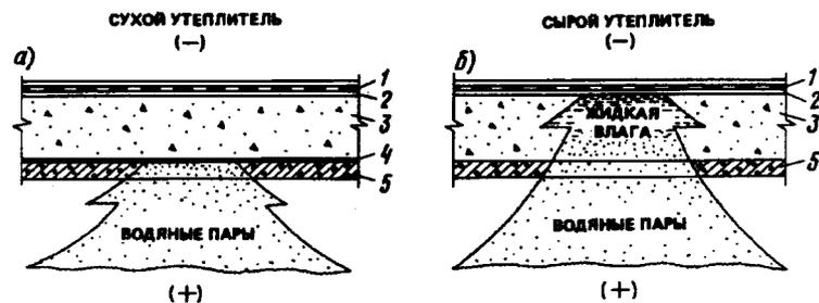
Рис. 2.19. Проникновение водяных паров в конструкцию бесчердачного перекрытия при устройстве пароизоляции (а) и без нее (б)
