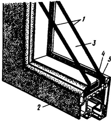
Рис. 6.3. Использование стеклопакета для остекления
