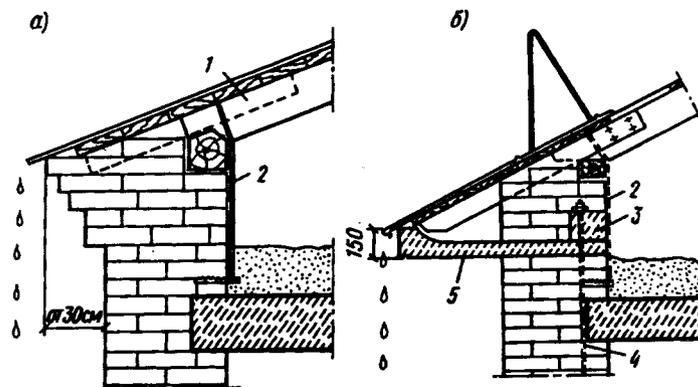
Рис. 2.23. Конструкции карнизов, защищающих стены от увлажнения дождем
