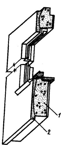
Рис. 5.18. Однослойная бетонная панель наружных стен
