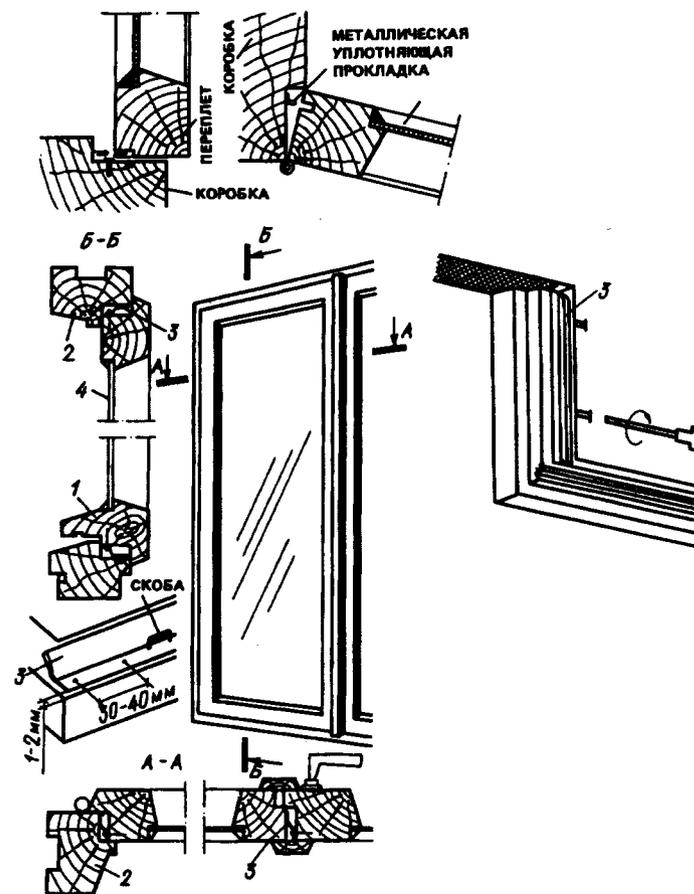
Рис. 6.17. Повышение герметичности окон установкой металлической ленты
