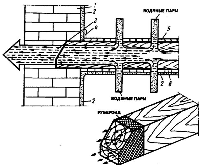
Рис. 2.20. Диффузия водяного пара в деревянной потолочной балке
