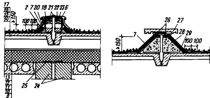
Рис. 7.6. Бесчердачная вентилируемая крыша
