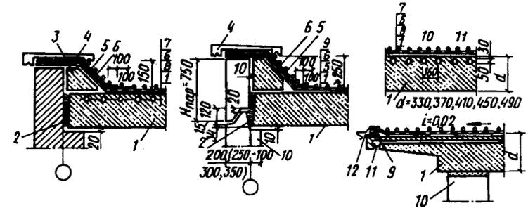
Рис. 7.7. Бесчердачная крыша из легкобетонных панелей
