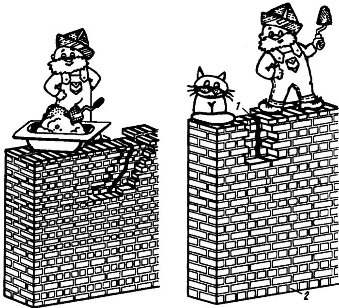
Рис. 5.23. Заделка трещин в кирпичной стене
