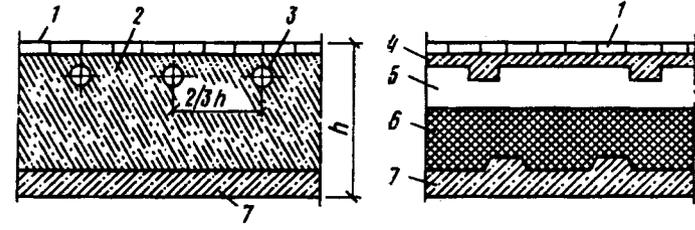
Рис. 7.3. Бесчердачные покрытия с вентилируемыми каналами
