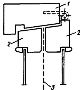
Рис. 6.27. Установка металлизированной пленки в межстекольном пространстве
