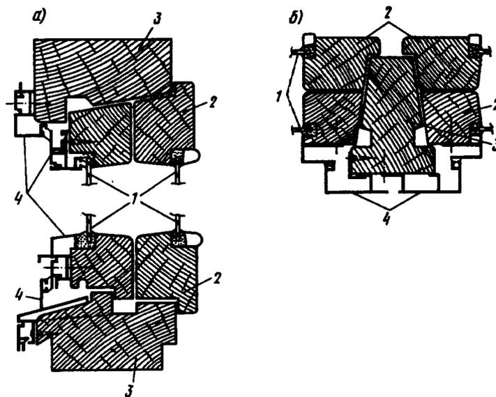
Рис. 6.2. Деревоалюминиевый оконный блок с полной наружной облицовкой линейными элементами из алюминия
