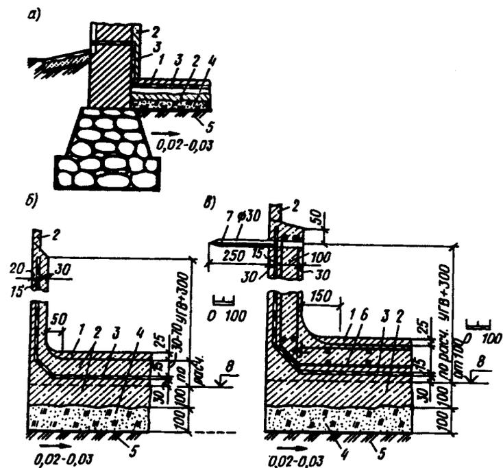
Рис. 8.15. Гидроизоляция помещений, заглубленных в землю
