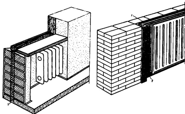
Рис. 5.25. Утепление стены за радиатором
