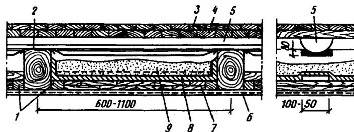
Рис. 8.5. Перекрытие по брусчатым балкам
