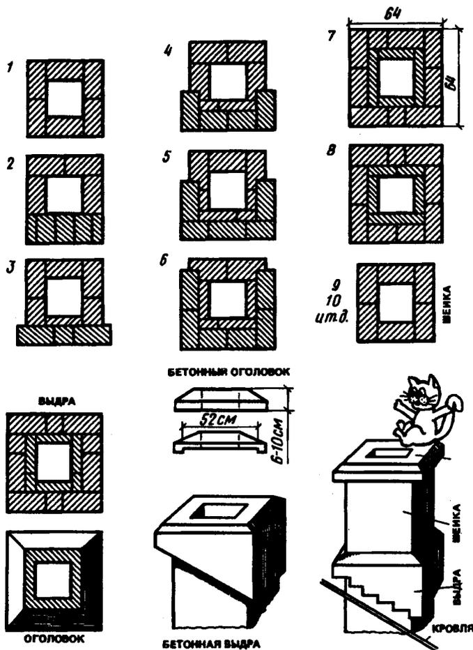
Рис. 9.4. Кладка выдры, шейки и оголовка трубы
