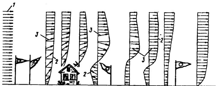
Рис. 1.1. Обтекание ветром прямоугольного здания
