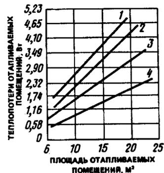
Рис. 9.17. График для определения ориентировочных теплотерь одноэтажного дома
