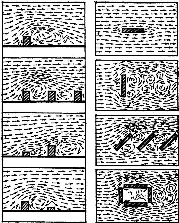
Рис. 1.3. Возникновение воздушных потоков в застройке различной конфигурации
