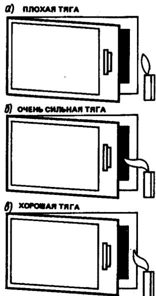
Рис. 9.9. Определение интенсивности тяги по отклонению пламени свечи
