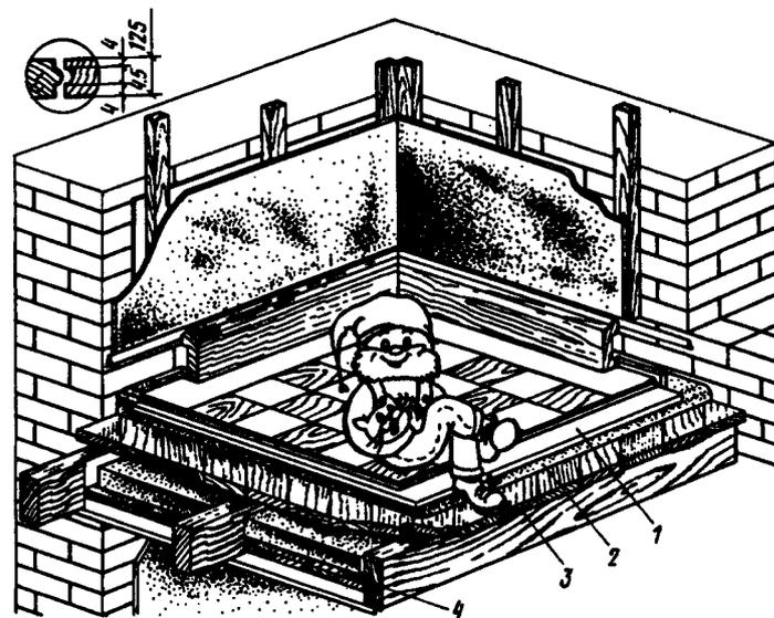
Рис. 8.1. Общий вид балочного перекрытия по деревянным балкам
