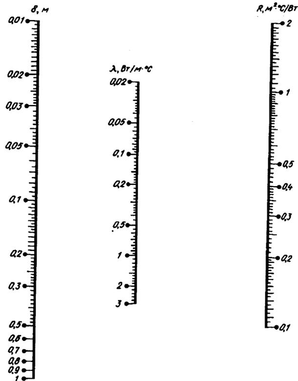
Рис. 11.2. Номограмма для определения толщины конструкции
