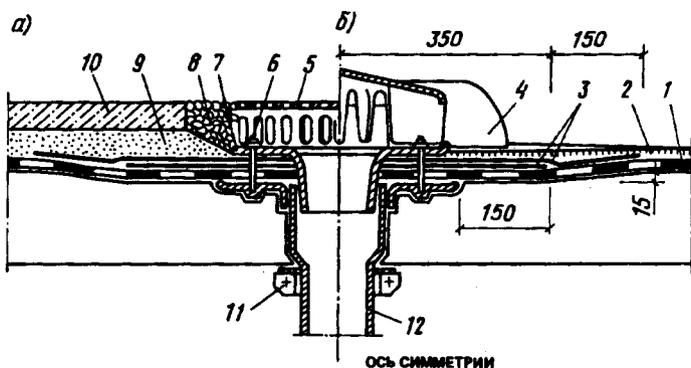
Рис. 7.11. Кровля в местах установки водосточных воронок
