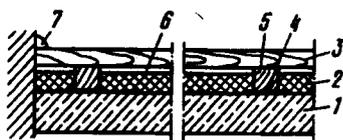
Рис. 8.39. Утепление перекрытий с дощатыми полами по деревянным лагам, засыпным утеплителем или минеральной ватой
