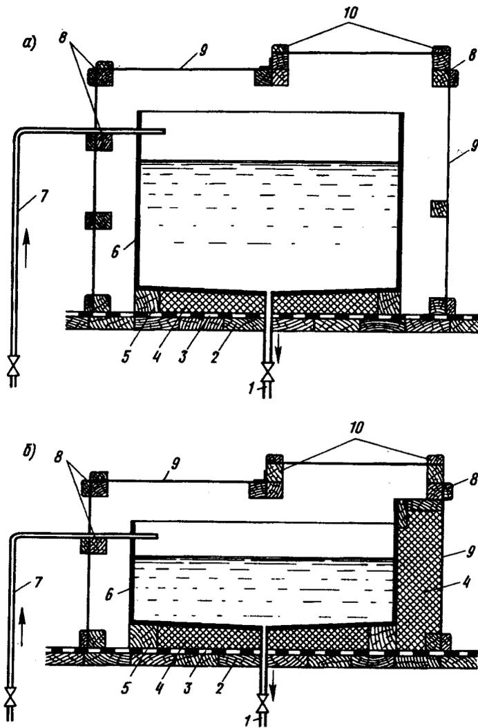
Рис. 10.3. Солнечная ловушка для нагрева воды
