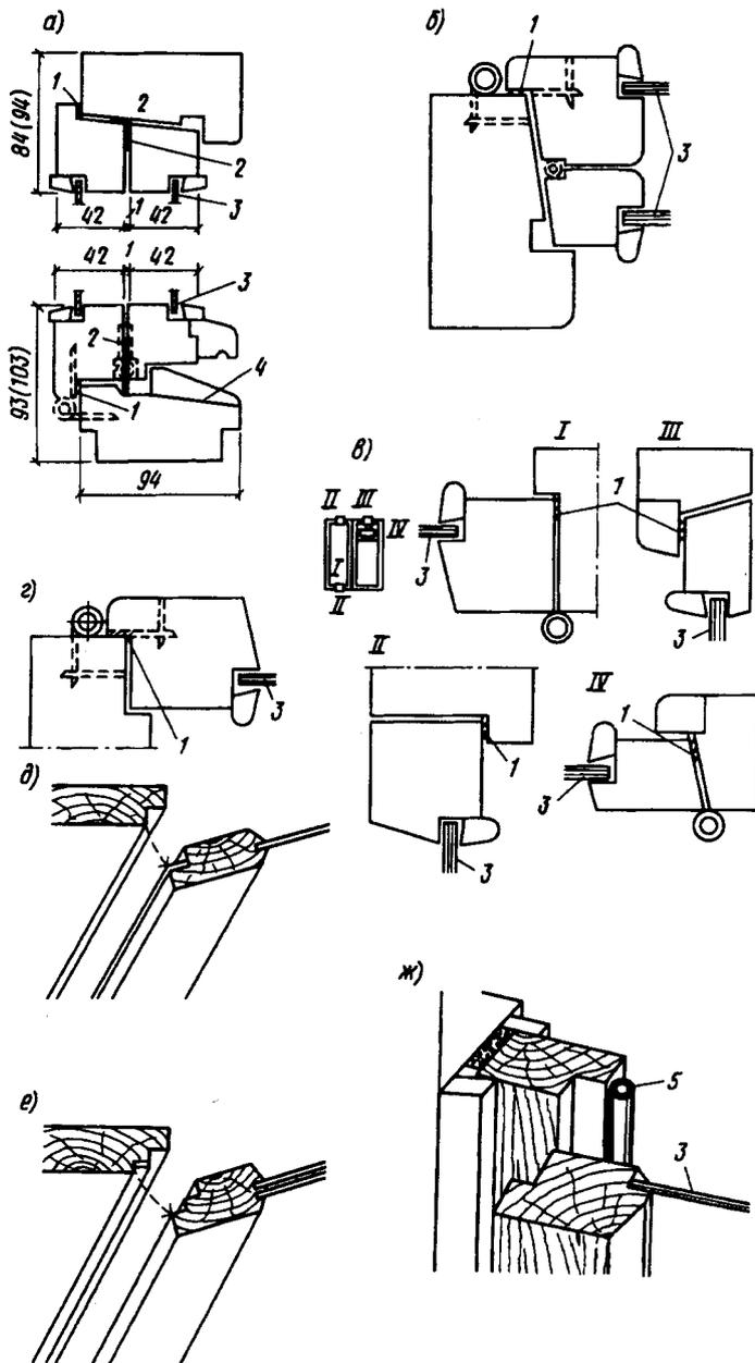
Рис. 6.16. Установка самоклеющейся уплотняющей прокладки с защитной пленкой
