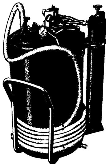
Рис. 5.24. Установка ГЖУ-1 для получения пеноизола
