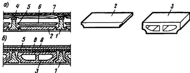
Рис. 8.3. Конструкция балочного перекрытия по железобетонным балкам
