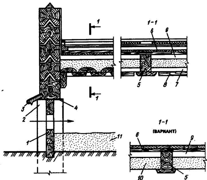
Рис. 8.14. Конструкция утепленного цокольного перекрытия с проветриваемым подпольем
