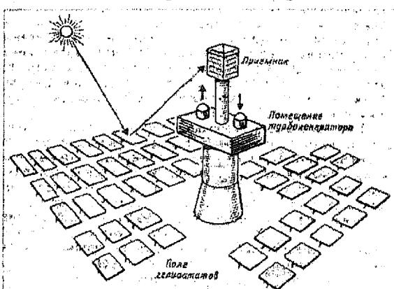
Рис. 16. Схема устройства солнечной станции башенного типа.
