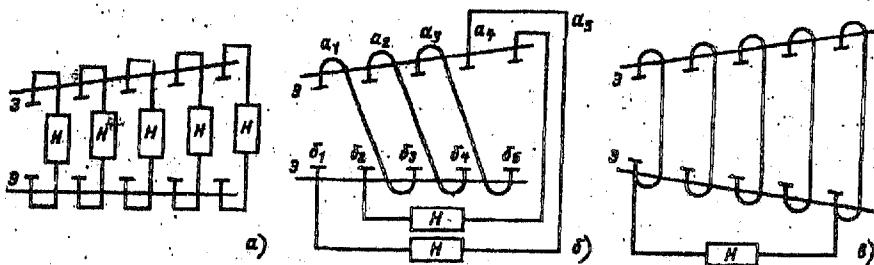
Рис. 61. Схемы включения МГД-генератора:
