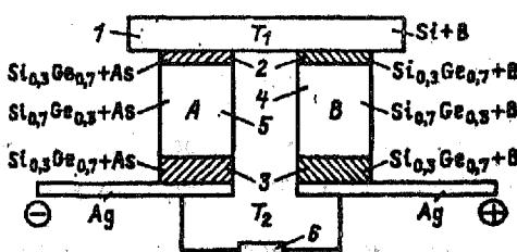
Рис. 52. Схема термоэлектрического элемента:
