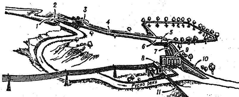
Рис. 46. Схема деривационной гидроэлектрической станции:
