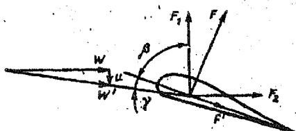
Рис. 41. Силы, действующие на лопасть, движущуюся в ветровом потоке.
