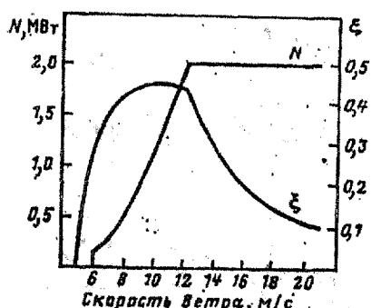
Рис. 42. Зависимость мощности ветровой турбины и коэффициента использования ветра от скорости ветра
