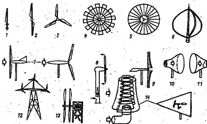
Рис. 44. Принципиальные конструкции основных типов ветровых турбин:
