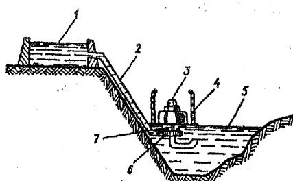
Рис. 51. Схема устройства гидроаккумулирующей электростанции:
