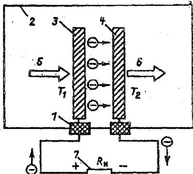
Рис. 54. Принципиальная схема термоэмиссионного преобразователя:
