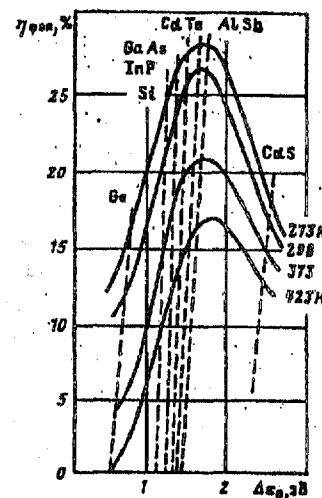
Рис. 29. Зависимость эффективности ФЭП от ширины запрещенной зоны полупроводника при различных значениях температуры
