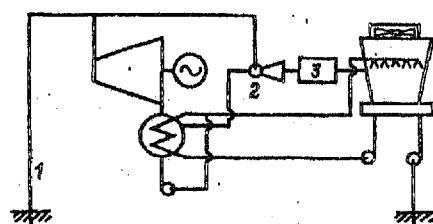
Рис. 36. Схема ГеоТЭС, работающей на сухом паре с конденсатором поверхностного типа:
