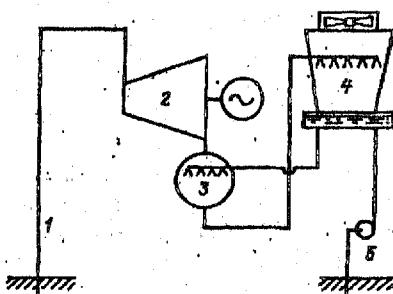
Рис. 35. Схема ГеоТЭС, работающей на сухом паре с конденсатором смешивающего типа:
