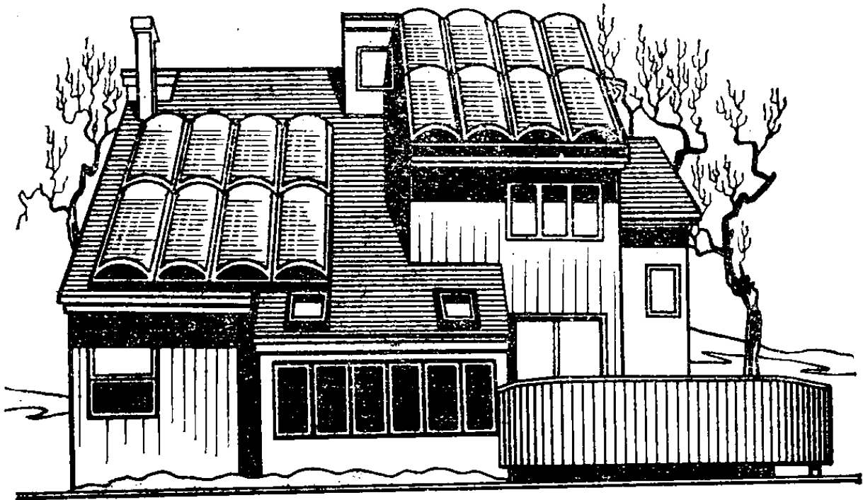
Рис. 26. Жилой дом с солнечными коллекторами на крыше
