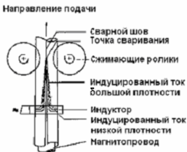
Рис. 7.18. Принцип непрерывной сварки труб
