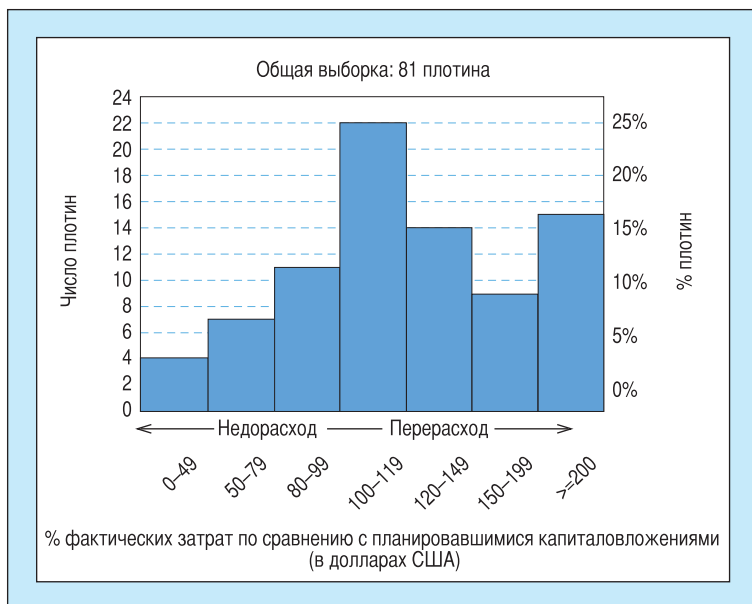
Рис. 2.1 Перерасход средств при строительстве крупных плотин
