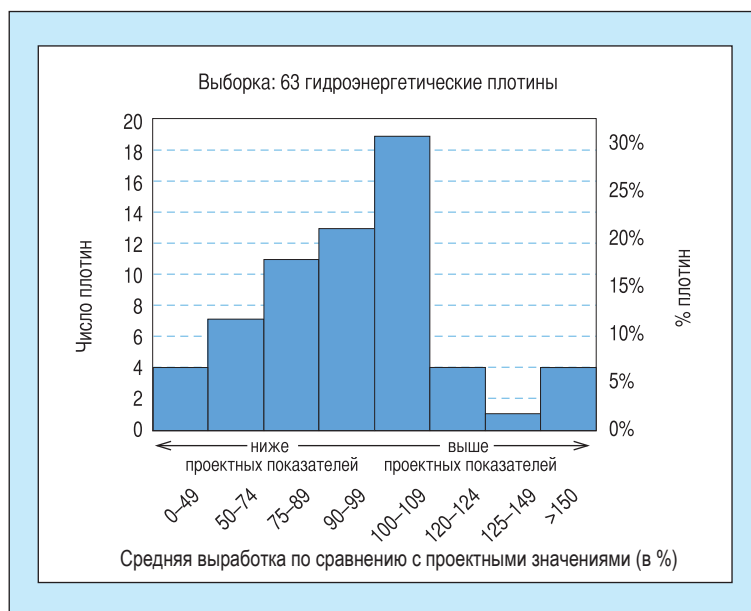
Рис. 2.4 Средние показатели выработки электроэнергии по сравнению с проектными
