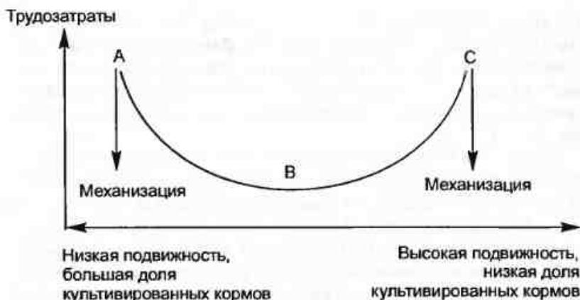
Рис. 40. Схема соотношения затрат труда, уровня механизации и степени подвижности в животноводстве.
