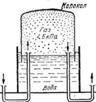
Рис. 20.6. Мокрый одноподъемный газгольдер низкого давления.
