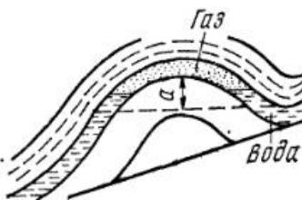
Рис. 20.1. Газохранилище пористого типа [36]:
