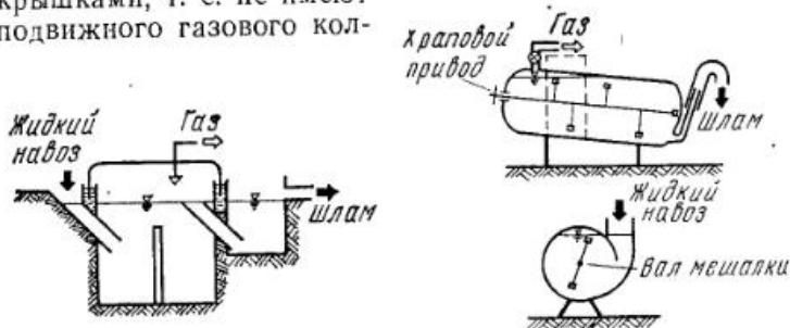
Рис. 12. Простейшая двухкамерная биогазовая установка (Филиппины) [144].
