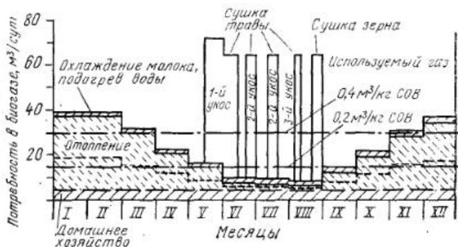
Рис. 31. Модельное хозяйство I типа (см. табл. 35): в части диаграммы, соответствующей отоплению, верхняя линия относится к применению обычного газового котла, средняя (штриховая) — применению газокомпрессионного теплового насоса. СОВ — сухое органическое вещество.
