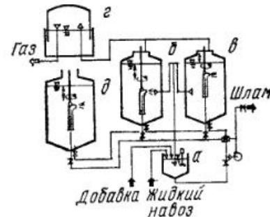
Система с накоплением газа и шлама [131] выполняется только с одним жидкостным реактором (рис. 7). Последний играет роль бродильной камеры и накапливает шлам до момента вывозки в поле. Поэтому реактор никогда не опорожняют полностью; остаток шлама служит затравкой для новой порции субстрата. При непрерывной подаче свежего субстрата постоянно снижается время, отводимое для брожения. В результате этого газовый потенциал накопившейся в реакторе массы используется не полностью.
