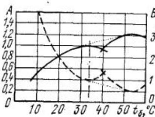
Рис. 2. Отношения количеств (A, сплошные линии) газа, выделяемого при различных температурах бродильной камеры, и необходимой для этого длительности (Б, штриховые линии) брожения к соответствующим значениям этих же величин при 33°C.
