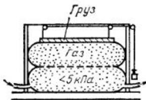
Рис. 20.8. Оболочковый газгольдер низкого давления.
