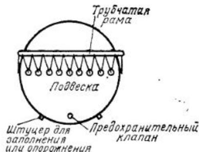
Рис. 20.9. Газгольдер-баллон низкого давления (подвешенный на трубчатой раме).
