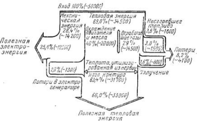
Рис. 30. Схема энергетического баланса компактной установки «Тотем» (Total energy module) автомобильной фирмы Фиат [138]. Числы в скобках соответствуют тепловым эквивалентам энергии в ккал/ч.
