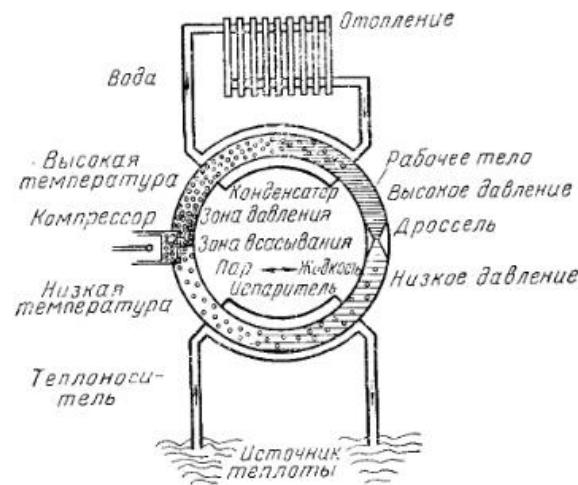
Рис. 26. Схема циркуляционного контура теплового насоса [128].
