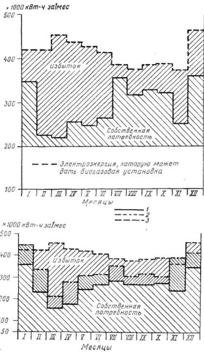
Рис. 29. Годовые диаграммы производства электрической (вверху) и тепловой (внизу) энергии с помощью установки по очистке городских стоков [3]:
