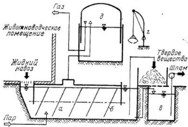
Рис. 14. Трапециевидная биогазовая установка системы «Дармштадт» [116]:
