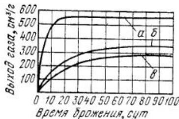
Рис. 5. Выход газа в расчете на 1 г сухого органического вещества типичных сельскохозяйственных материалов при температуре брожения 30°C [89].
