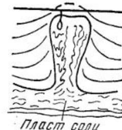
Рис. 20.2. Газохранилище кавернозного типа [36].
