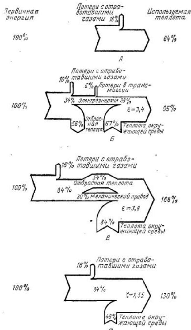
Рис. 28. Схема превращения энергии в тепловых насосах [114]:
