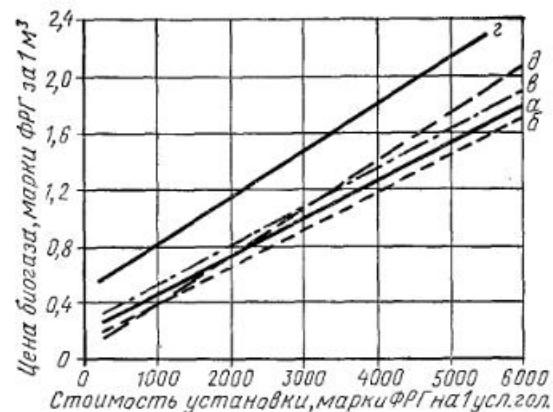
Рис. 36. Цена биогаза в зависимости от стоимости установки для выхода полезно используемого биогаза  $n=0,2 \text{ м}^3$  на 1 кг сухого органического вещества при изменении отдельных элементов расчета.
