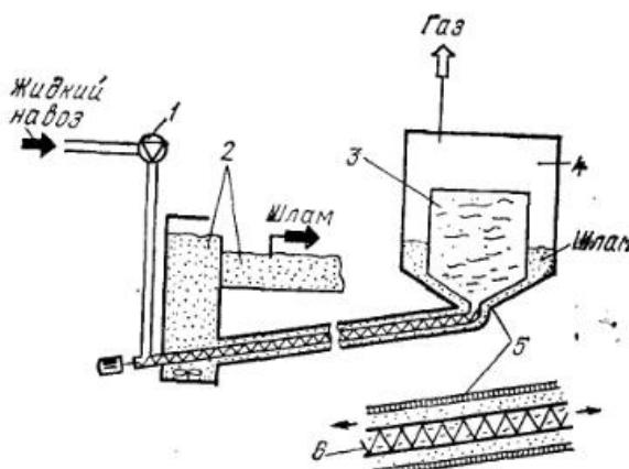
Рис. 17. Подогрев свежего субстрата за счет отбрасной теплоты удаляемой из реактора массы по шведскому предложению [143]: 1 — насос; 2 — накопитель шлама; 3 — реактор; 4 — пространство для накопления газа; 5 — слой теплоизоляции; 6 — открытый шиек.
