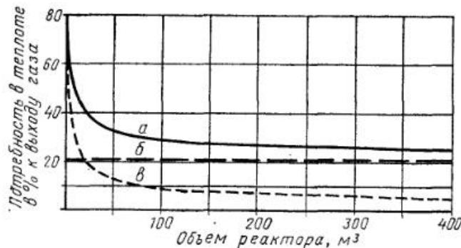
Рис. 35. Потребность в теплоте цилиндрического реактора в зависимости от его объема с учетом потерь теплоты при промывании [24] (по Розеггеру):
