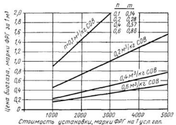
Рис. 34. Цена биогаза в зависимости от первоначальных вложений в установку и удельного выхода полезного используемого газа ( $n$ ) или удельного выхода общего количества газа ( $m$ ).
