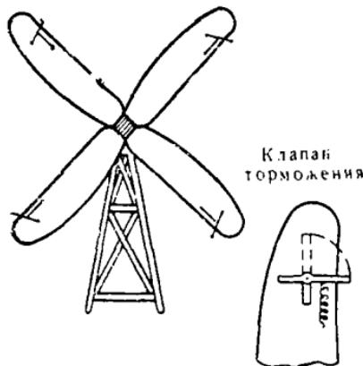
Рис. 137. Схема регулирования воздушным тормозом системы Билляу.
