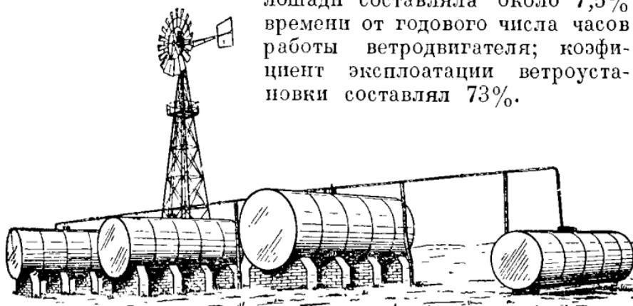
Рис. 270. Ветроустановка ТВ-5 для перекачки горючего.
