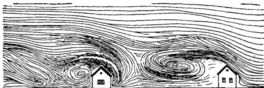
Рис. 206. Аэродинамический спектр вокруг моделей домов.
