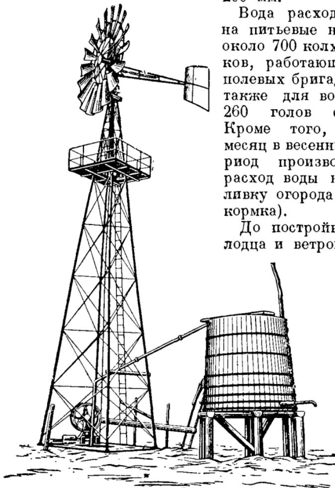
Рис. 268. Ветронасосная установка ТВ-5 в селе Лески, Киевской области.
