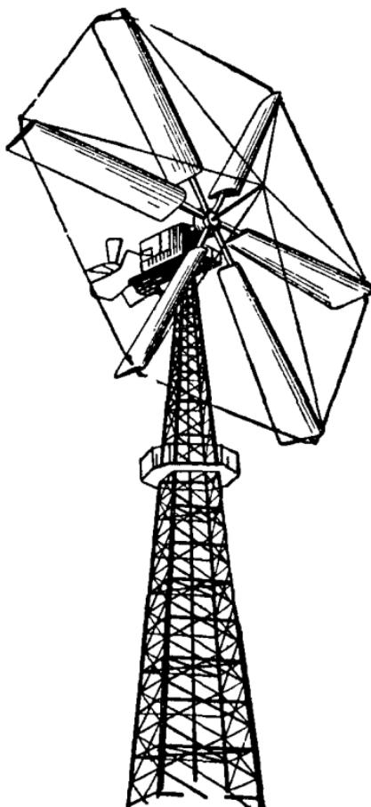
Рис. 330. Ветроэлектростанция на 30 квт с ветродвигателем системы Кумме.
