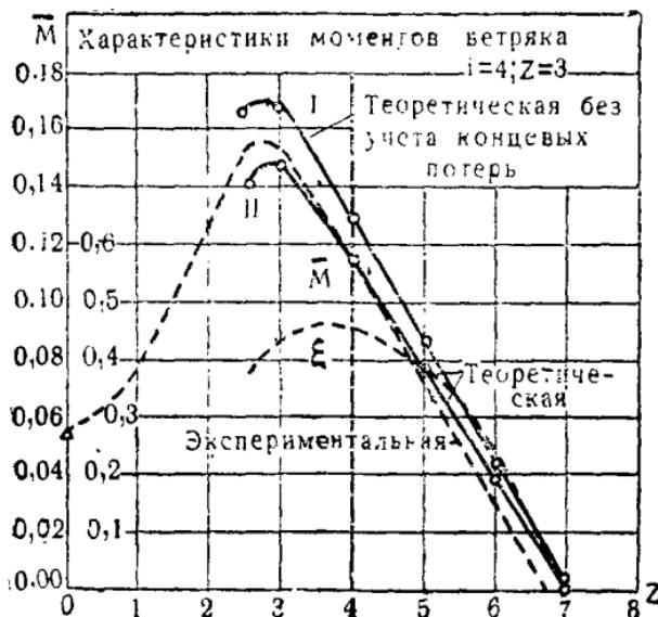
Рис. 62. Расчётная аэродинамическая характеристика всего ветроколеса.
