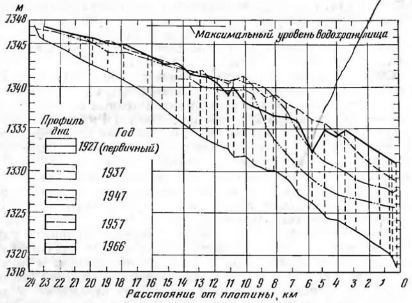
Рис. 25. Заиливание водохранилища Гернси на р. Норт-Плейт (США) (Man-Made Lakes, 1973)
