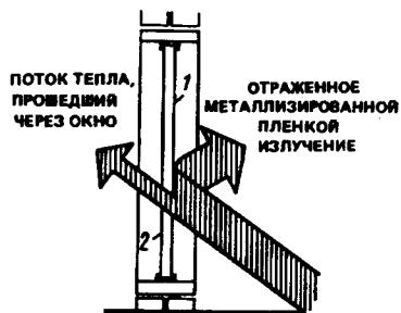
Рис. 6.21. Установка металлизированной пленки
