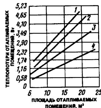
Рис. 9.17. График для определения ориентировочных теплопотерь одноэтажного дома
