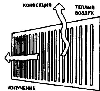
Рис. 9.13. Конвективная и лучистая теплоотдача отопительного прибора
