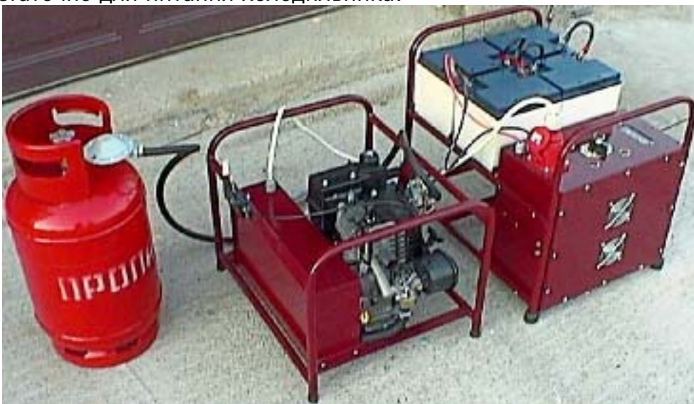
Рис. 2. Внешний вид двигателя с мотор-генератором, электронным блоком, аккумуляторной батареей и газовым баллоном.
